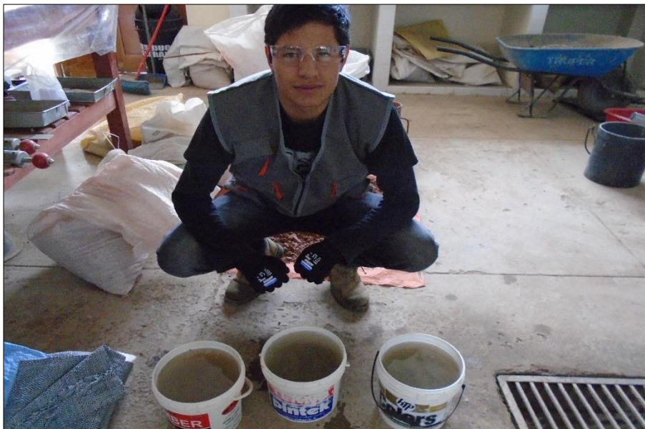
Imagen N° 01. Saturación de la muestra
