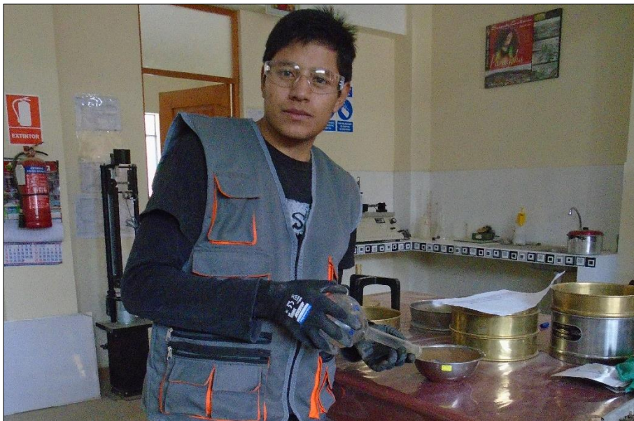
Imagen N° 09. Retiro de la muestra del picnómetro
