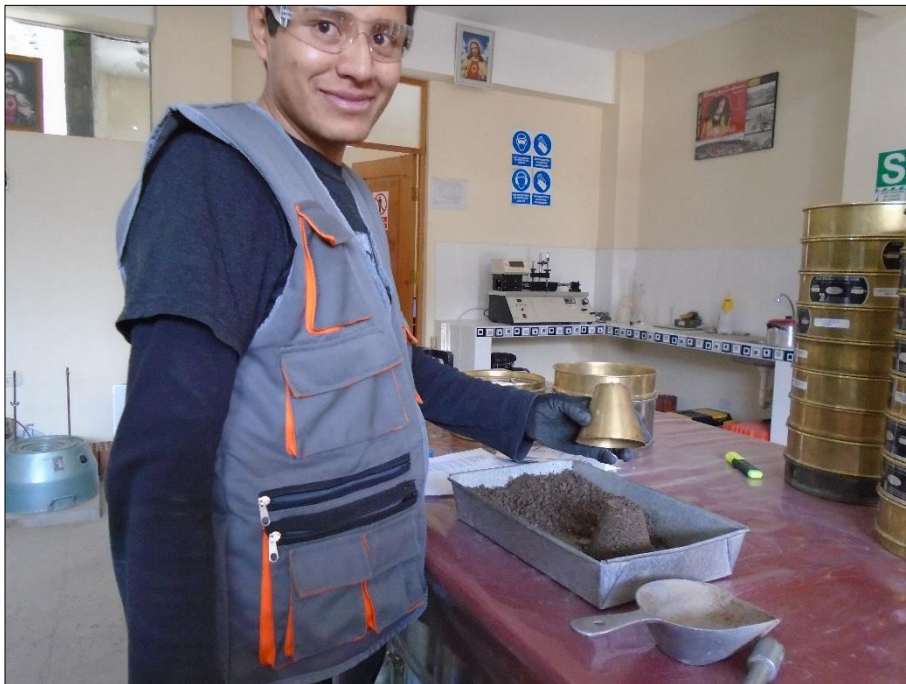
Imagen N° 03. Verificación de la condición SSS
