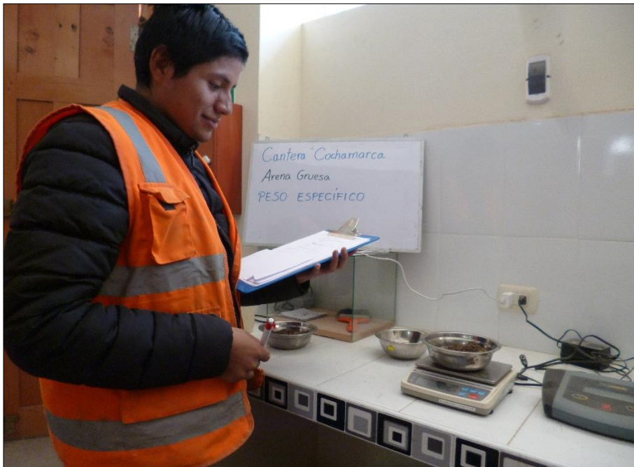
Imagen N° 11. Peso de la muestra seca
