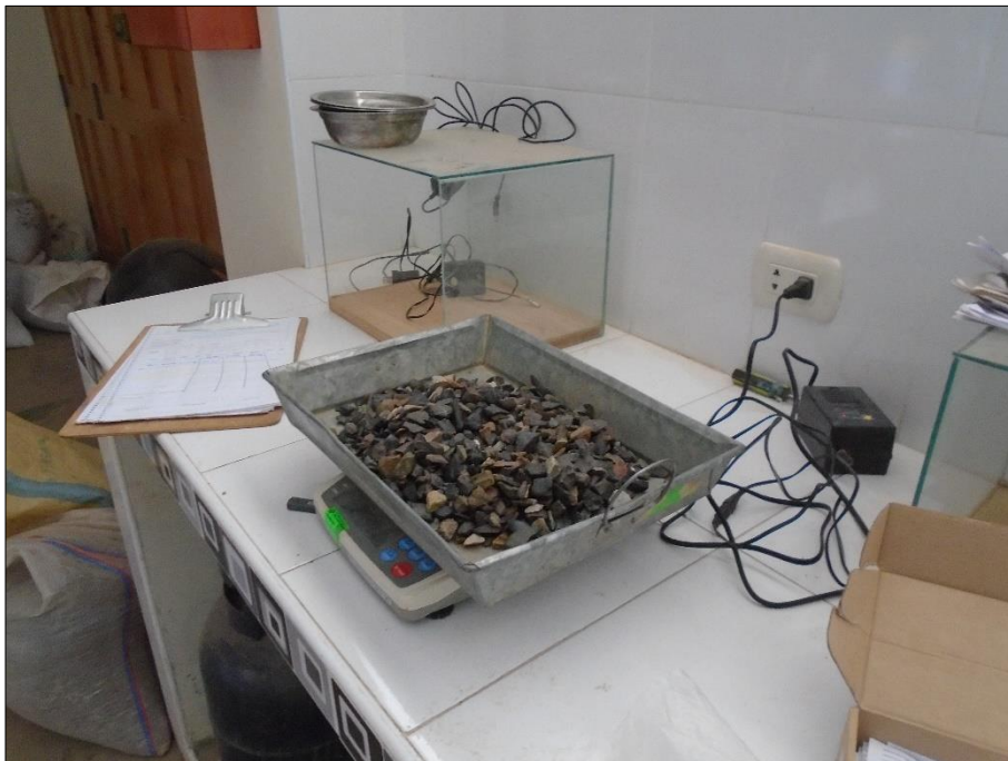
Imagen N° 05. Peso de la muestra SSS
