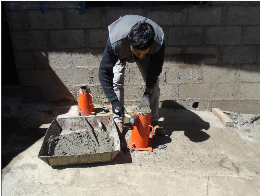
Imagen N° 02. Eliminación de vacío
