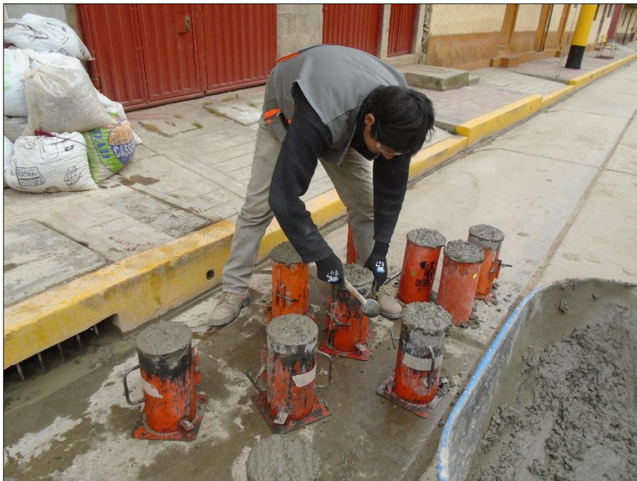
Imagen N° 04. Eliminación de aire de la mezcla
