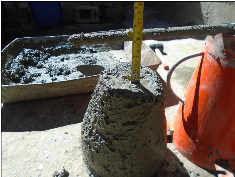
Imagen N° 02. Asentamiento a concreto tipo 1 (Piedra Triturada)
