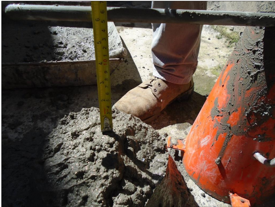
Imagen N° 04. Asentamiento a concreto tipo 3 (Hormigón)
