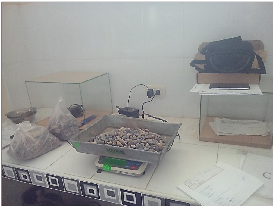
Imagen N° 07. Peso de la muestra seca
