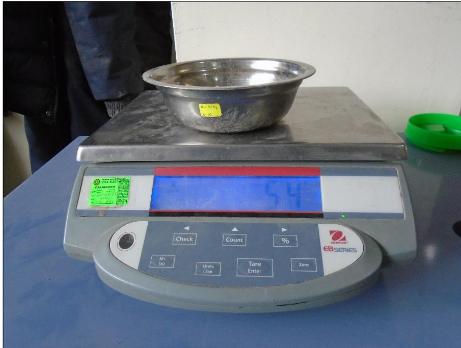
Imagen N° 02 – Peso de muestras humedad
