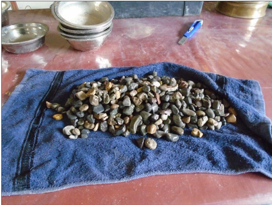
Imagen N° 05. Peso de la muestra SSS
