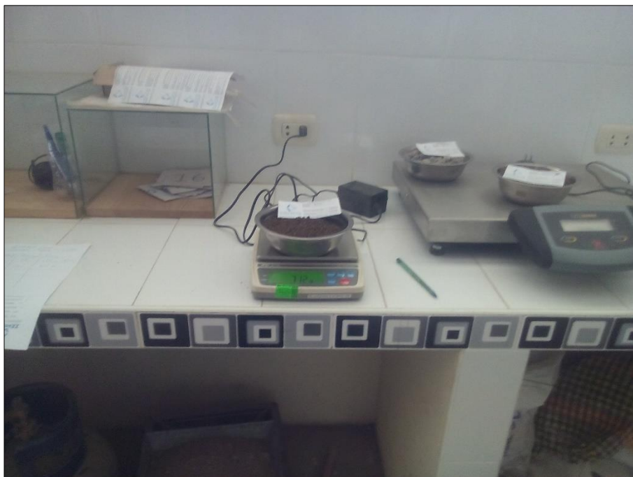
Imagen N° 02 – Peso de muestras humedad
