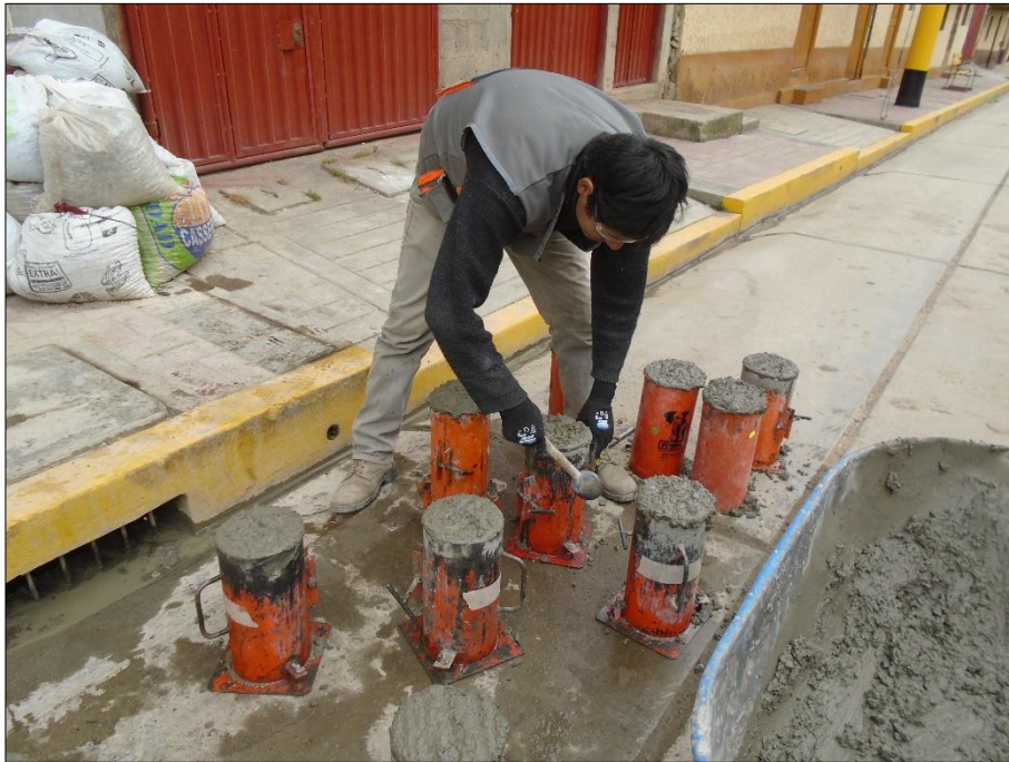
Imagen N° 04. Muestras para rotura
