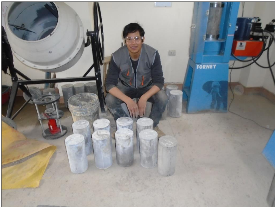
Imagen N° 04. Muestras para rotura
