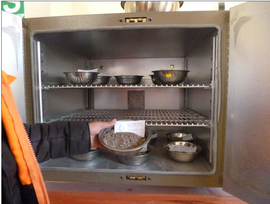
Imagen N° 04 – Peso de la muestra seca
