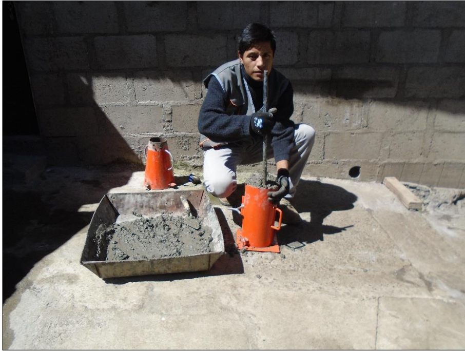
Imagen N° 02. Eliminación de vacío
