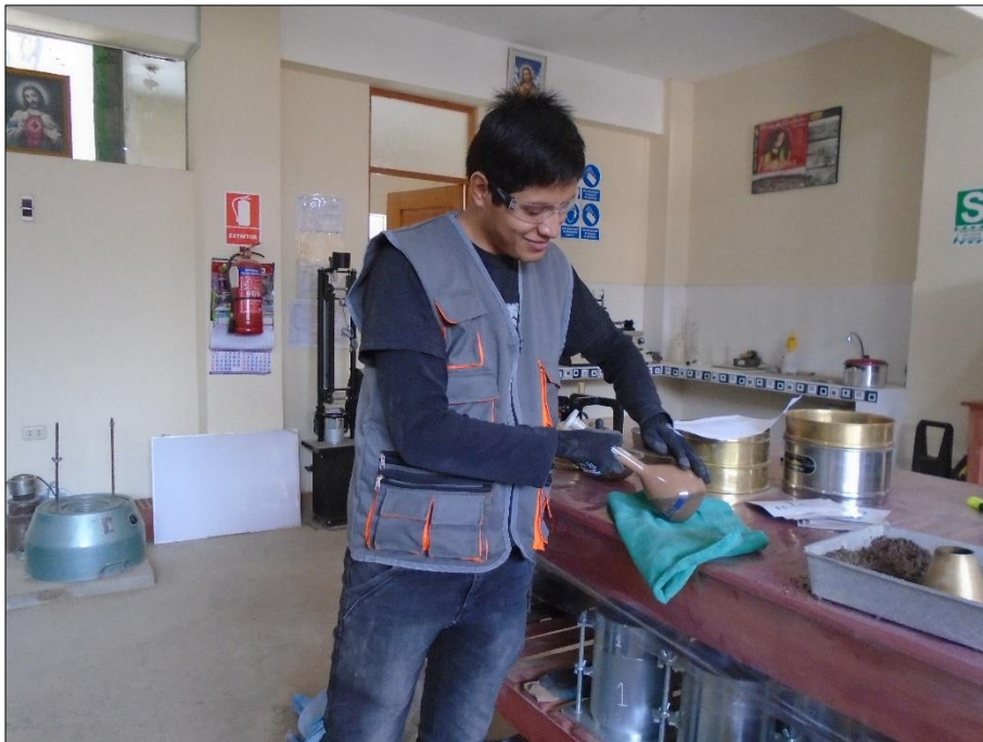
Imagen N° 07. Eliminación de aire del picnómetro
