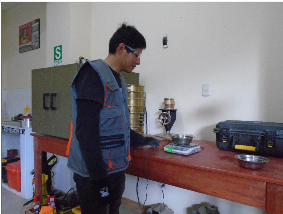
Imagen N° 05. Peso de la muestra SSS
