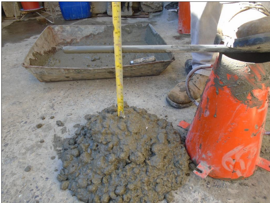
Imagen N° 04. Asentamiento a concreto tipo 3 (Hormigón)
