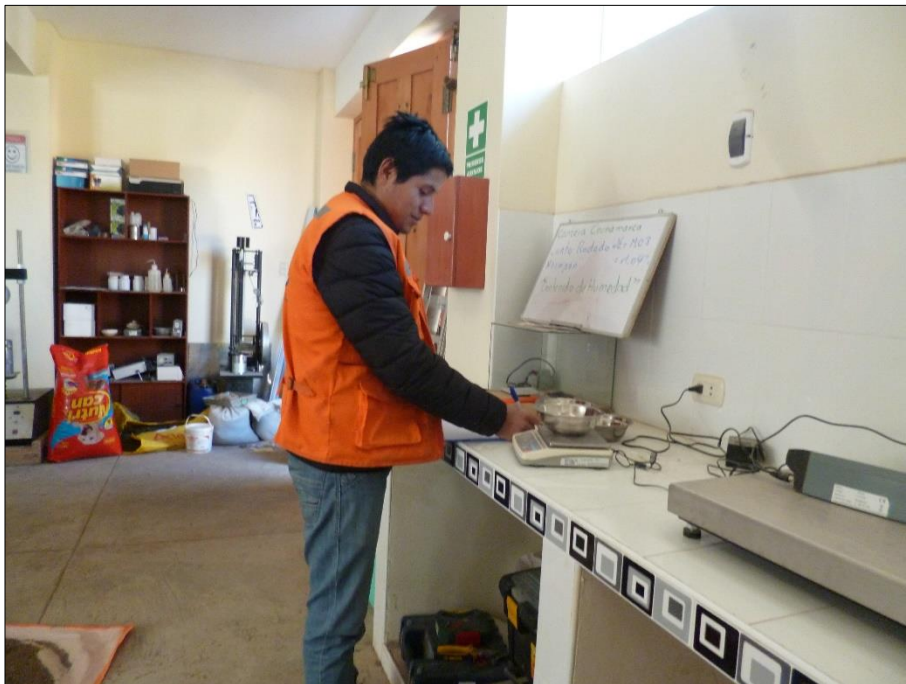
Imagen N° 04 – Peso de la muestra seca
