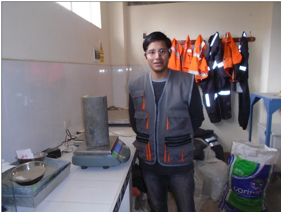
Imagen N° 06. Pesado de la muestra seca
