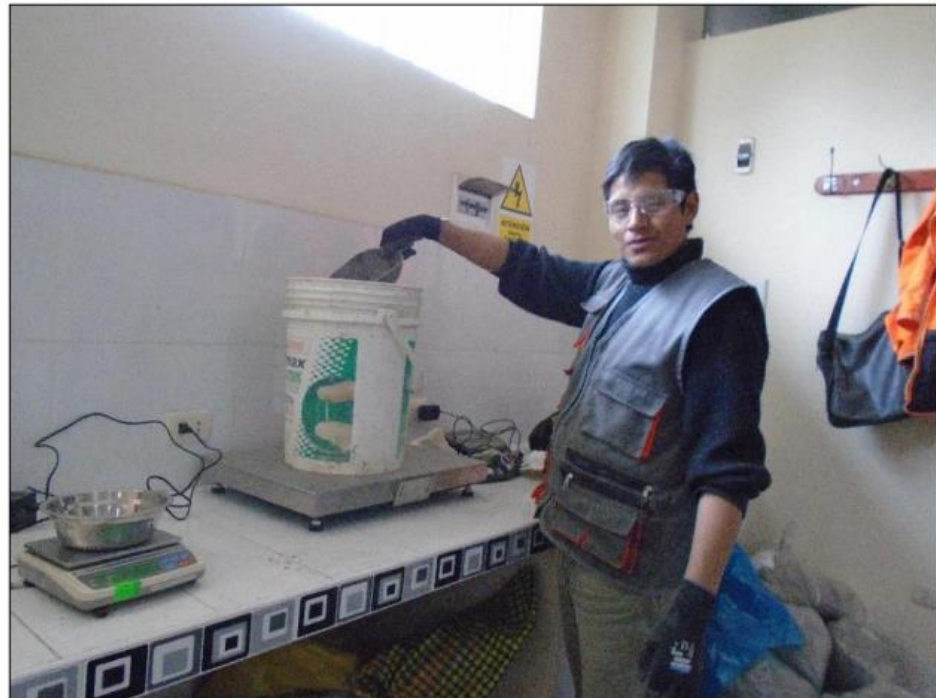
Figura N° 18. Dosificación en peso de los materiales
