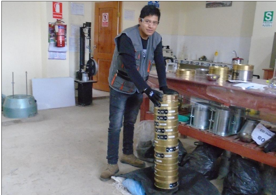
Imagen N° 10. Determinación del peso de la muestra retenido en cada tamiz.
