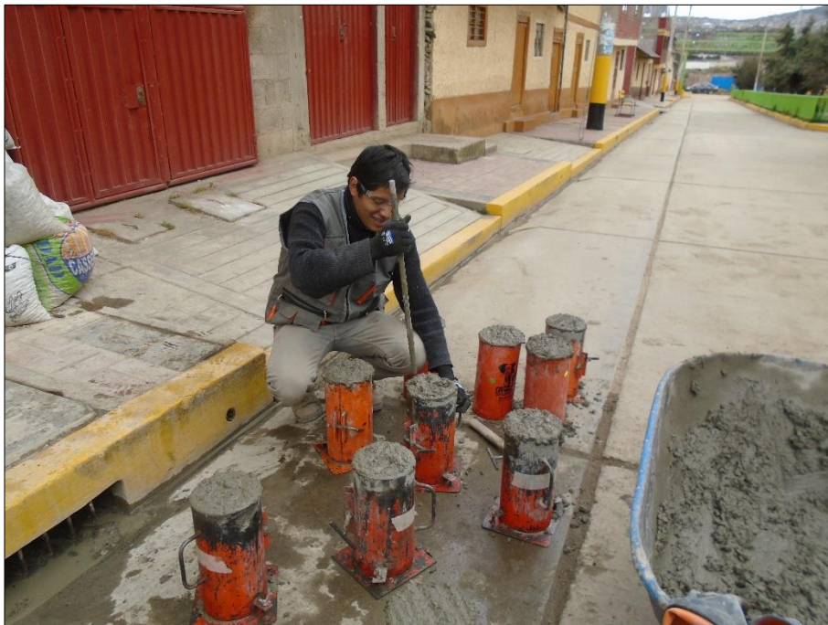
Imagen N° 02. Compactado de la muestra
