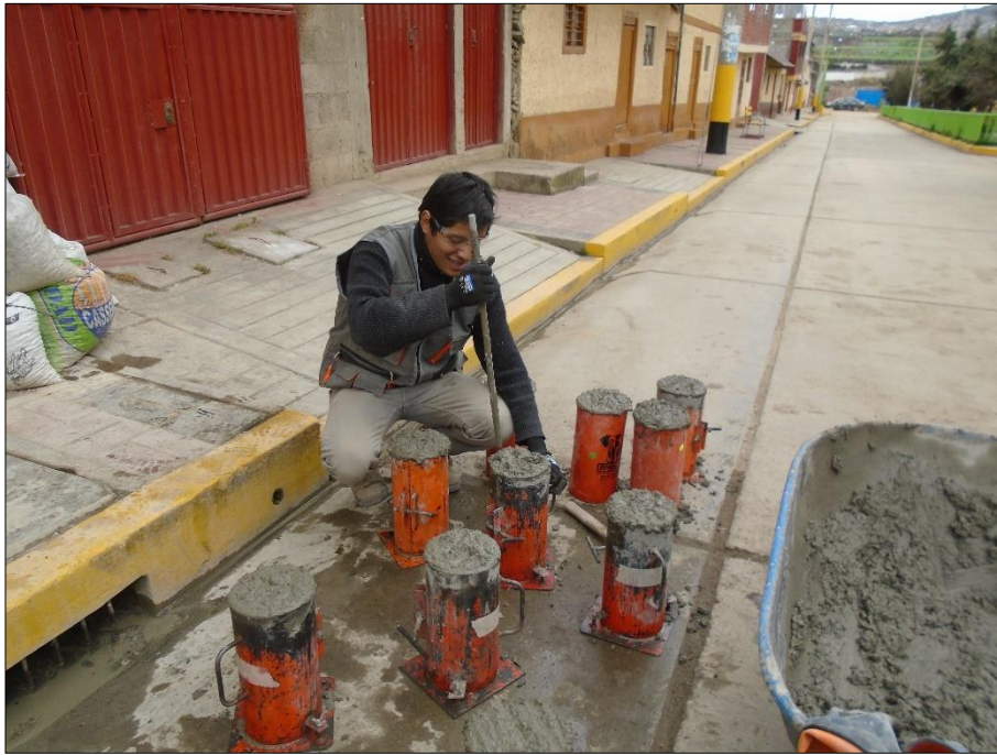
Imagen N° 04. Eliminación de aire de la mezcla
