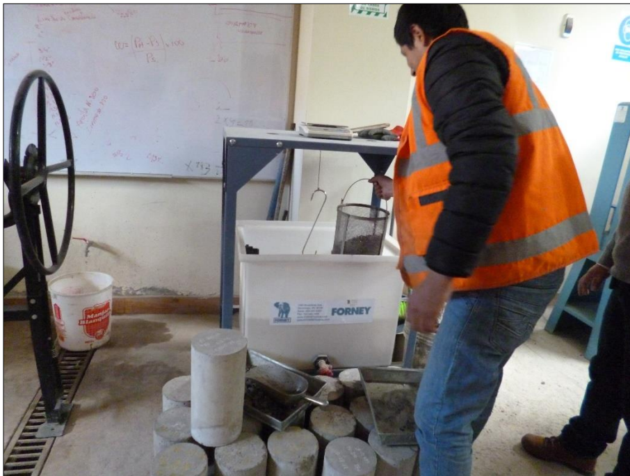
Imagen N° 03. Peso de la muestra sumergida
