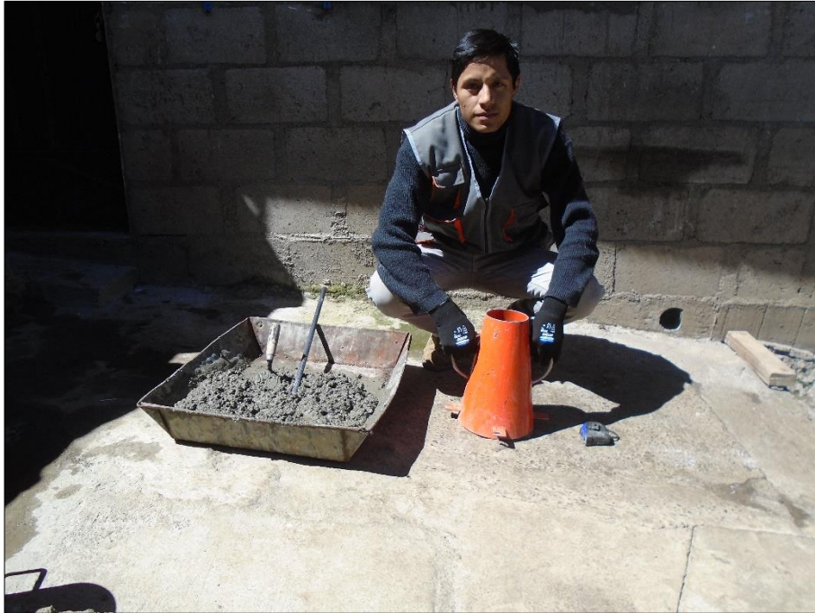
Imagen N° 02. Asentamiento a concreto tipo 1 (Piedra Triturada)
