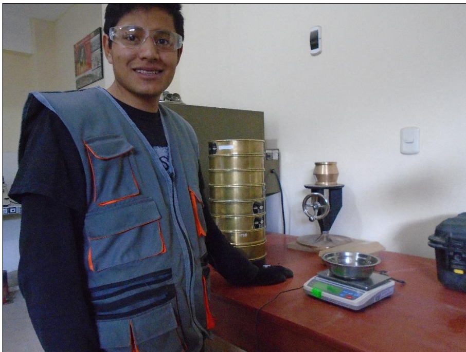
Imagen N° 10. Determinación del peso de la muestra retenido en cada tamiz.
