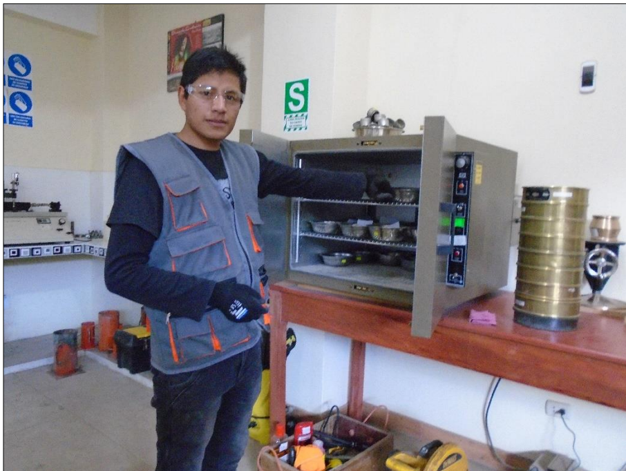
Imagen N° 08. Secado de muestras
