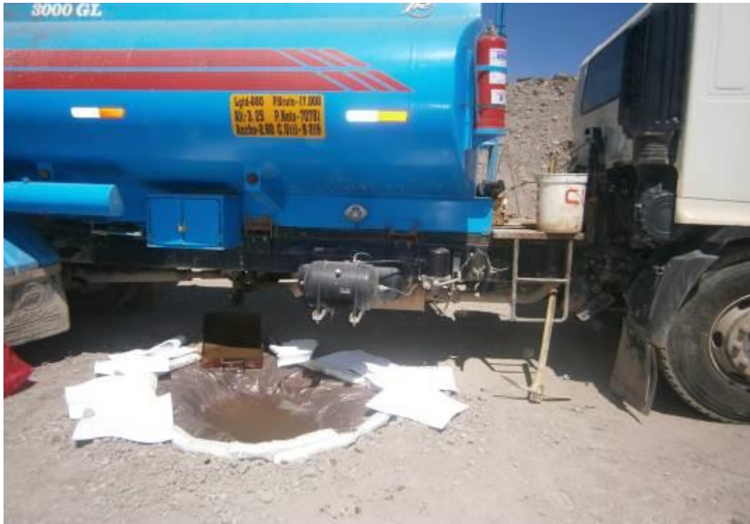
Foto (10): Derrame de combustible controlado (Riesgos controlados)
