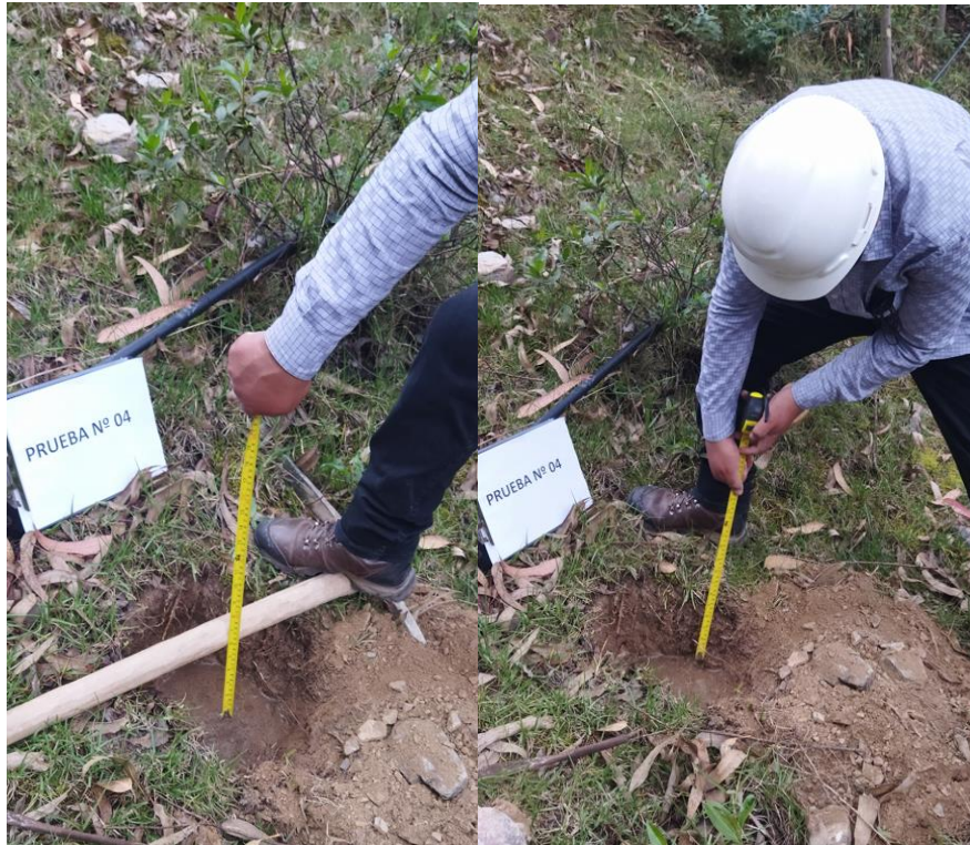
MEDIDA DE ALTURA DEL ESPEJO DE AGUA A SUPERFICIE DEL TERRENO EN EL POZO N°4 EN FUNCION AL TIEMPO
