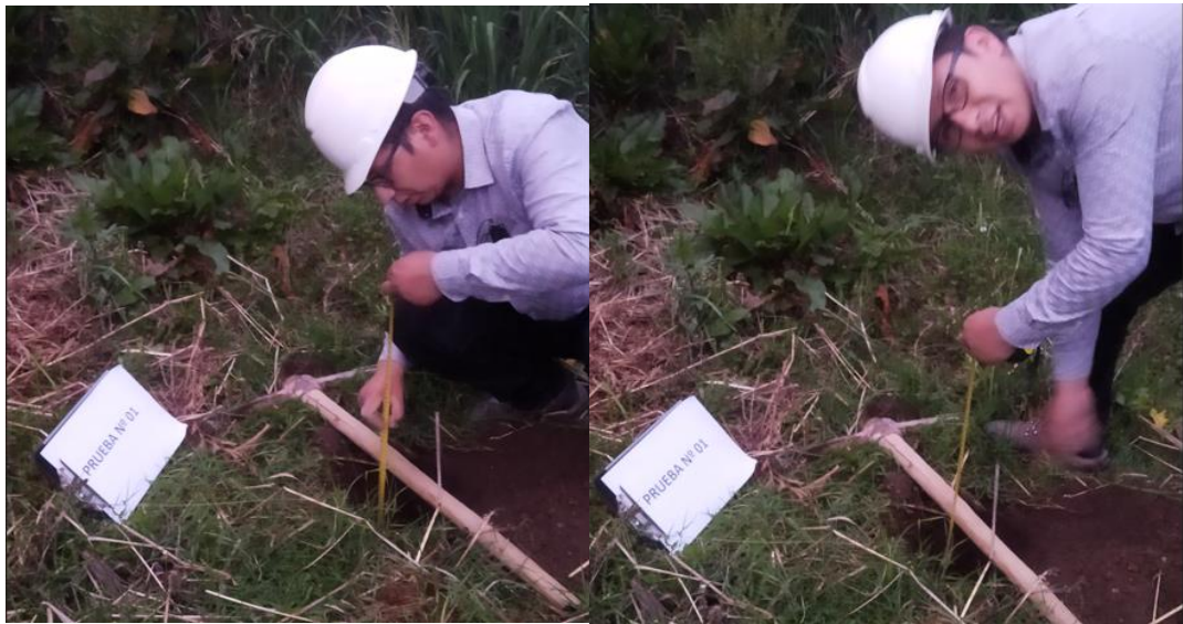
MEDIDA DE ALTURA DEL ESPEJO DE AGUA A SUPERFICIE DEL TERRENO EN EL POZO N°1 EN FUNCION AL TIEMPO
