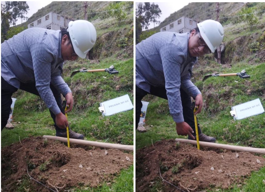
MEDIDA DE ALTURA DEL ESPEJO DE AGUA A SUPERFICIE DEL TERRENO EN EL POZO Nº2 EN FUNCION AL TIEMPO
