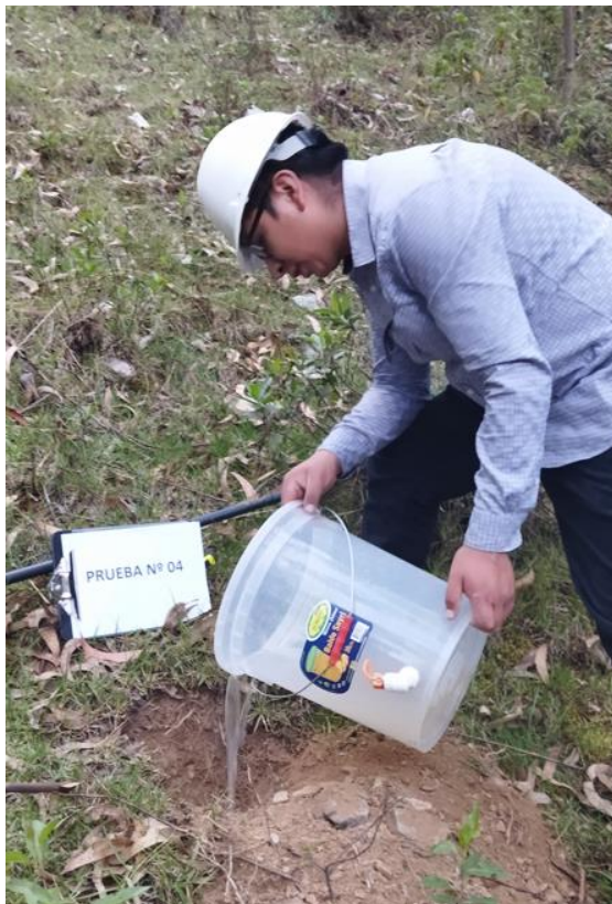
VERTIDO DE AGUA EN POZO Nº 4
