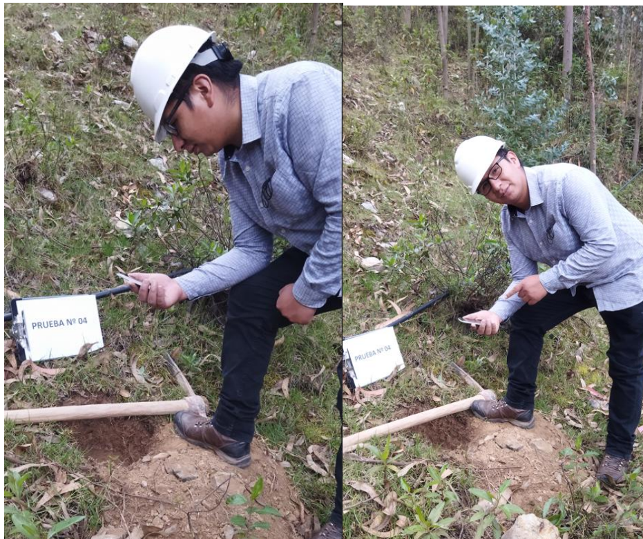
VERIFICACION DEL TIEMPO DE INFILTRACION DEL AGUA EN EL POZO N° 4
