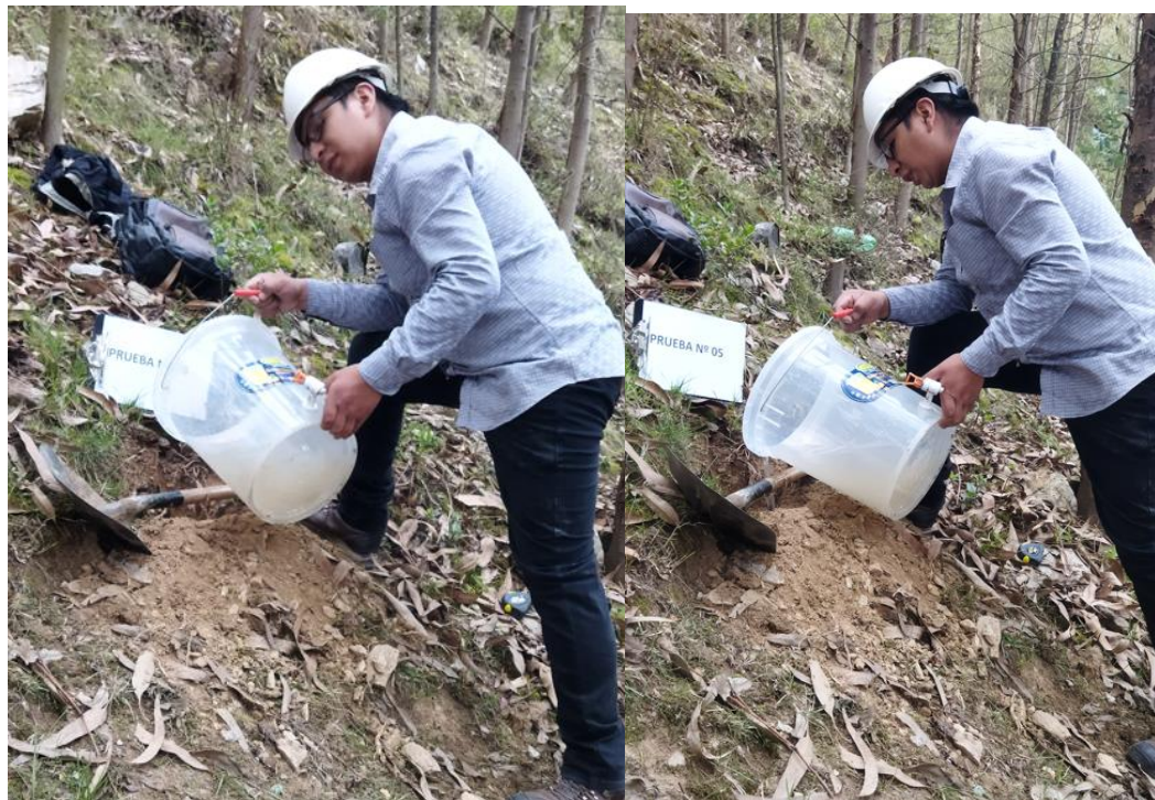
VERTIDO DE AGUA PARA EN POZO Nº 5
