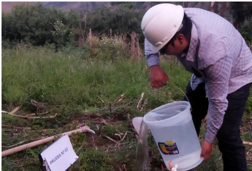
VERTIDO DE AGUA A POZO Nº2.
