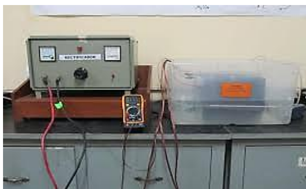
Figura 5. Equipo de electrodeposición para el cincado
