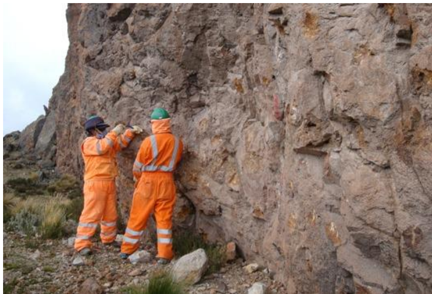
Figura 1: Muestreo de afloramientos por el método rock chip.
