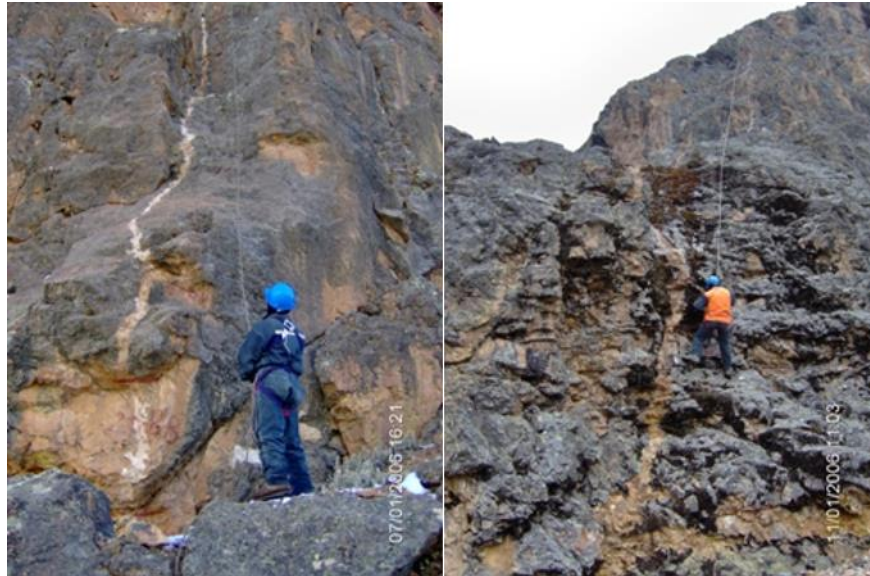
Figura 2: Muestreo de afloramientos por el método de canales.
