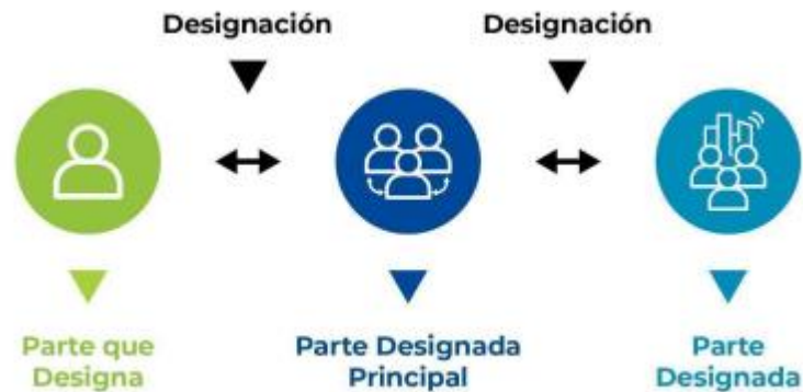
Ilustración 2: “partes involucradas en el proceso de gestión de la información bim”. (fuente: gráfico adaptado de Guidance Part a Edition 1 - The información management function and resources)
