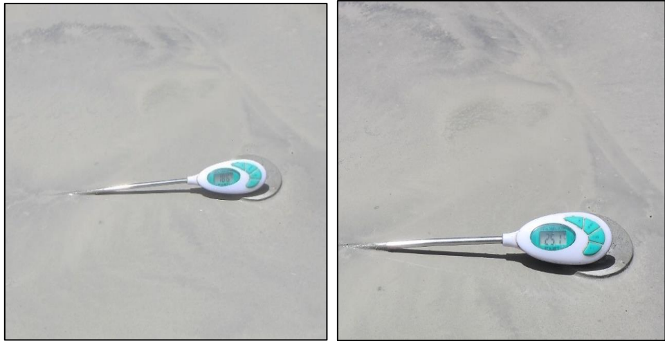
Figura N° 68 GE registro de temperatura de mortero colocado
