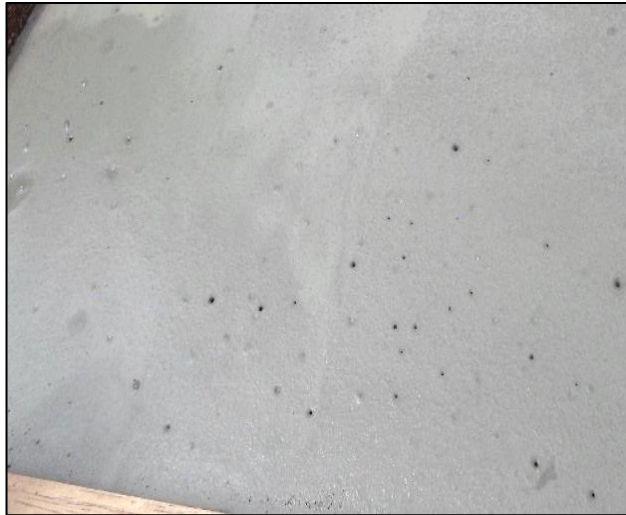
Figura N° 49 GC1 y GC2 agujeros en el mortero en estado fresco.
