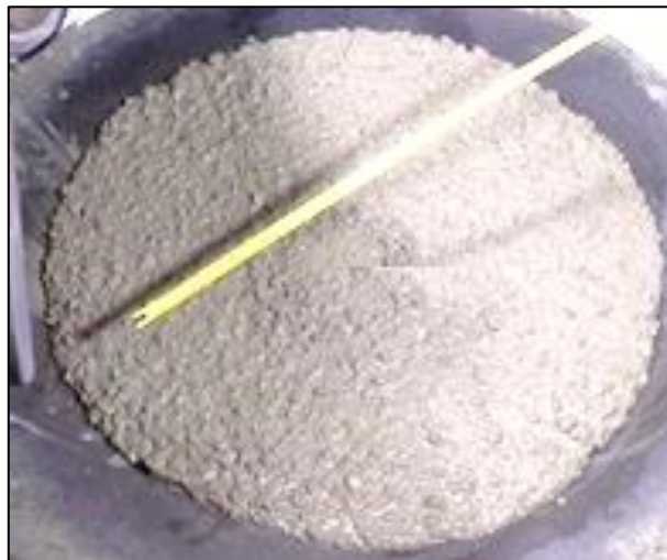
Figura N° 39 Ensayo de asentamiento para medir el grado de fluidez.
