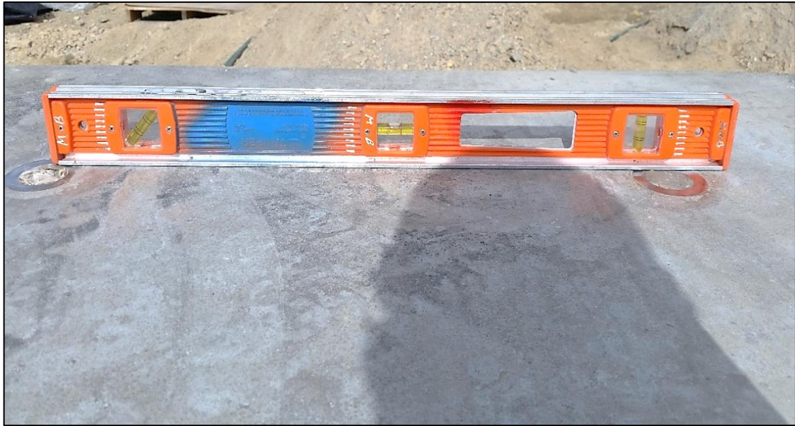
Foto 17 – GE presentación del producto cumpliendo las características autonivelantes
