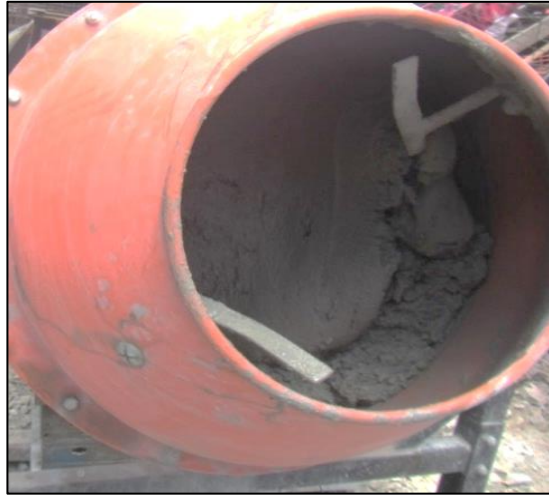
Figura N° 34 Inspección visual de la mezcla.
