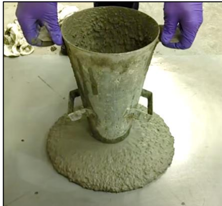
Figura N° 11 Flujo de asentamiento de concreto Autocompactable.
