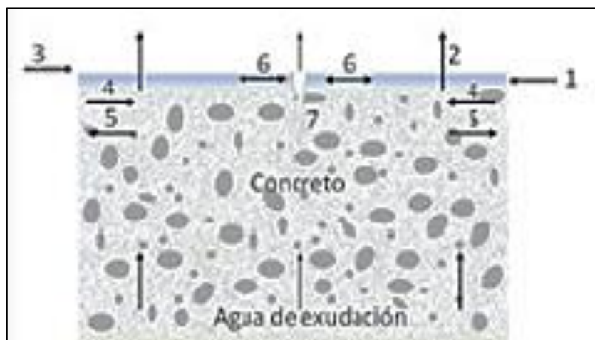
Figura N° 21 Mecanismo de fisuración por contracción plástica.
