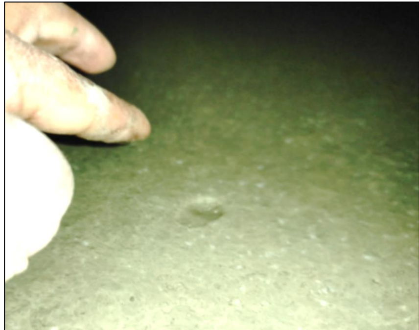
Figura N° 69 Identificación del fraguado inicial del mortero.
