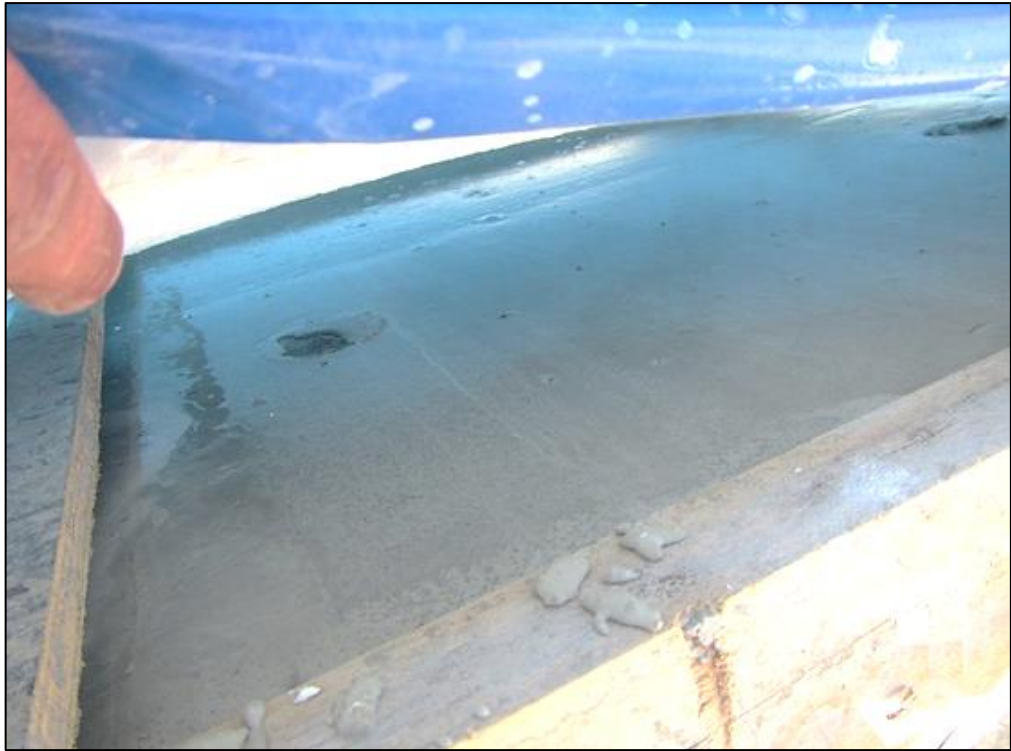
Foto 7 – CG1 Inspección visual para identificación del inicio de fraguado
