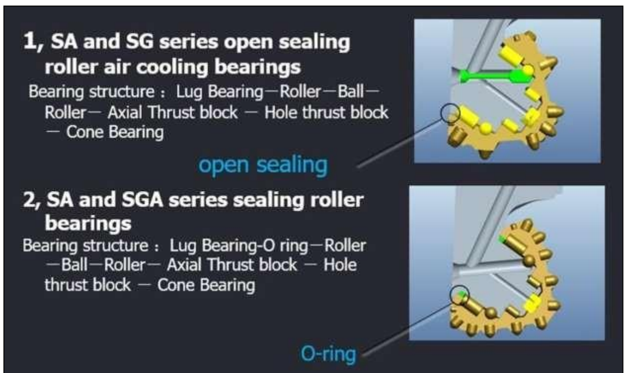
Ilustración 7: Especificaciones de los Triconos SA 645 y SA 545G.
