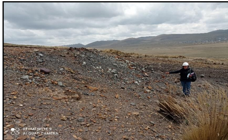
Figura 16. Imagen del talud formado con presencia de material piritoso en la zona de Unish afectando cuerpos de agua
