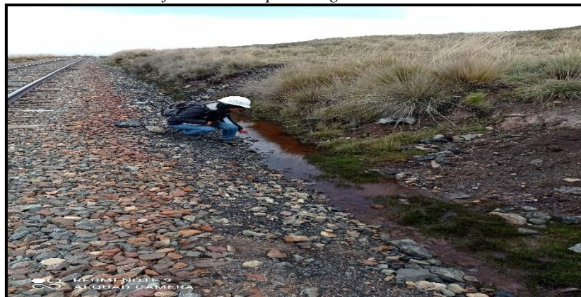
Figura 16. Imagen del talud formado con presencia de material piritoso en la zona de Unish afectando cuerpos de agua
