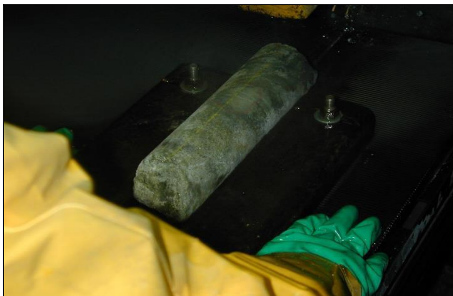
Fotografía N°15: Marcado de la línea de core.
