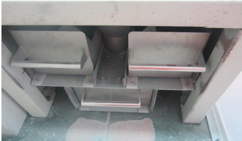
Fotografía N°18: (Proceso de chancado), cuarteador donde se visualiza las cajas de rechazos y muestras 1 y 2.
