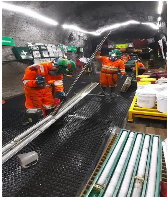
Fotografía N° 13: Ubicación del tramo de muestreo en un core.
