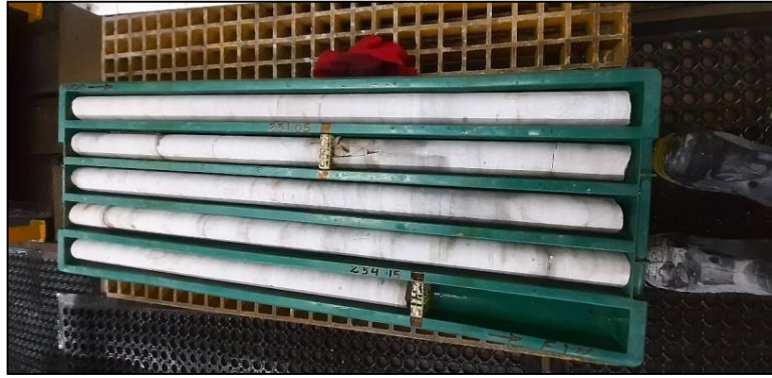
Fotografía N° 12: Ubicación del tramo de muestreo en un core.
