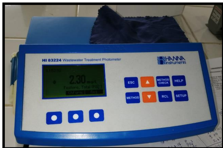
Figura N° 13. Medidor multiparamétrico de agua.
