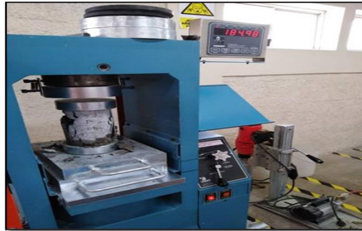
Figura N° 14. Prueba de resistencia a la fuerza de compresión del concreto vivo
