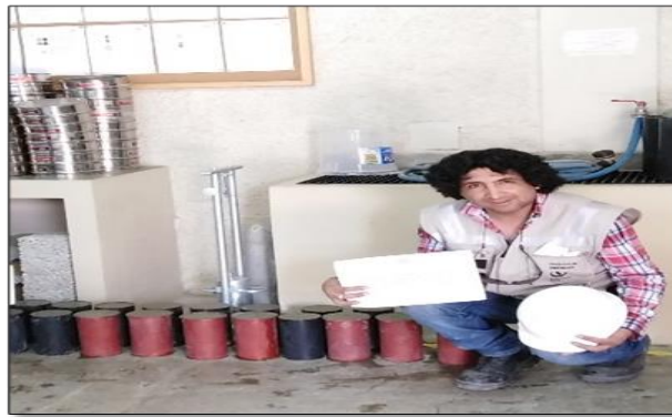
Figura N° 12. Llenado de las probetas con la mezcla de concreto tradicional (negras) y con el concreto vivo (rojas) – 26/01/2019
