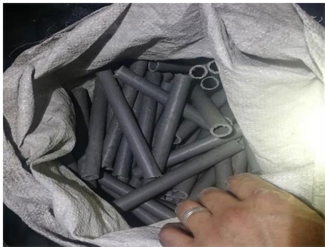
Figura N° 15: Preparación de los tubos para el desacoplado del explosivo
