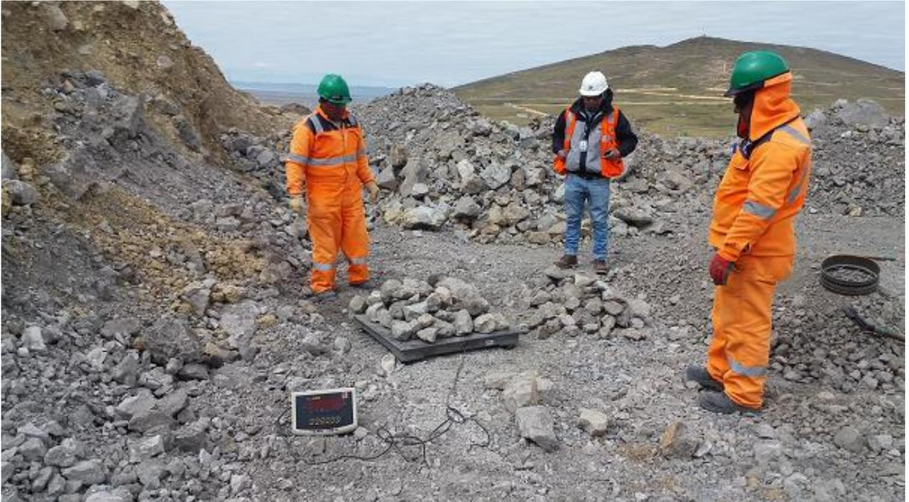
**Fotografía N° 03:** Medición del peso de la roca retenida en la malla de 3" de la calicata N° 01 en el acopio de Pasamayo
