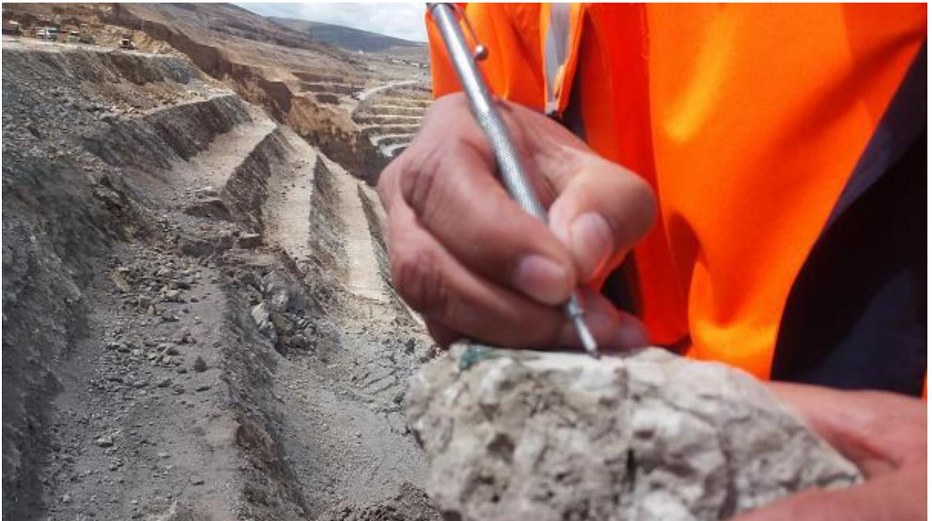
**Fotografía N° 04:** Verificación de la dureza de la roca por parte del Jefe Exploraciones SMEB.
