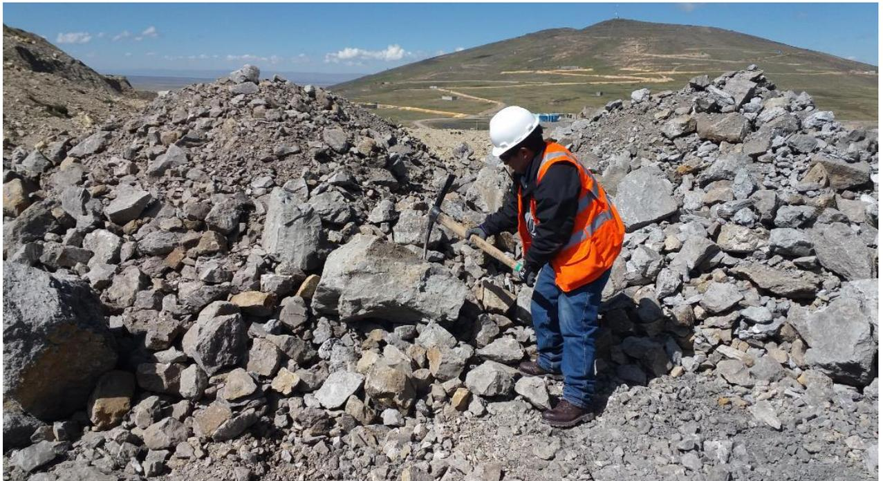
**Fotografía N° 02:** Verificación la roca acopiada en el sector de Pasamayo, material extraído del Tajo de la fase 9A, se observan pizarras que con un solo golpe del pico se fractura en 2 partes, Golder recomienda la selección de roca competente.
