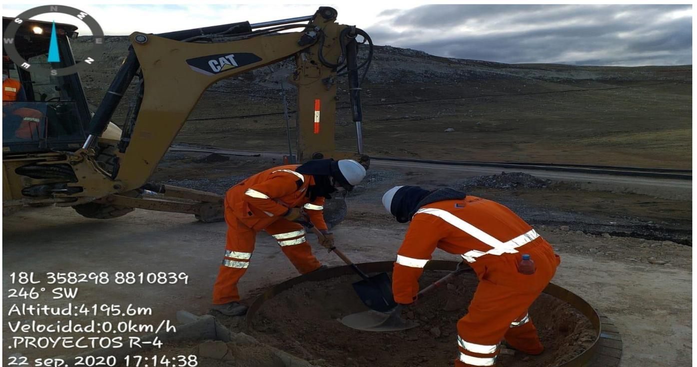
*Fotografía N° 08: Excavación para la prueba de densidad por reemplazo por agua.*
