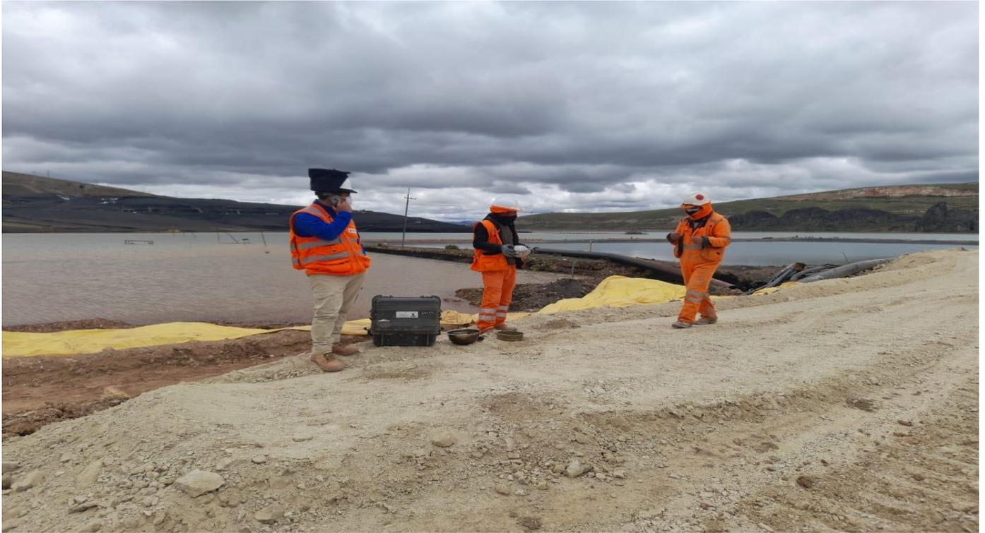
**Fotografía N° 09:** *Elaboración de la prueba de densidad por campo speed*
