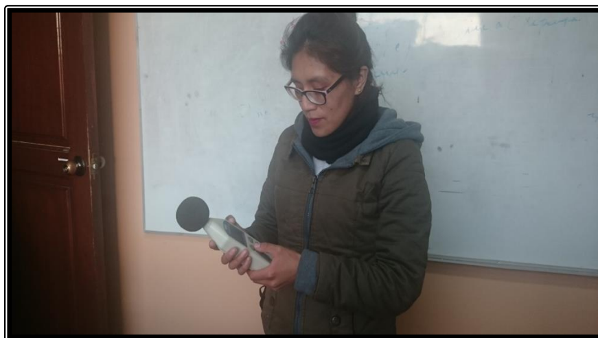
FIGURA 2: Reconociendo las características del SONÓMETRO WENSN WS 1361 a emplear
