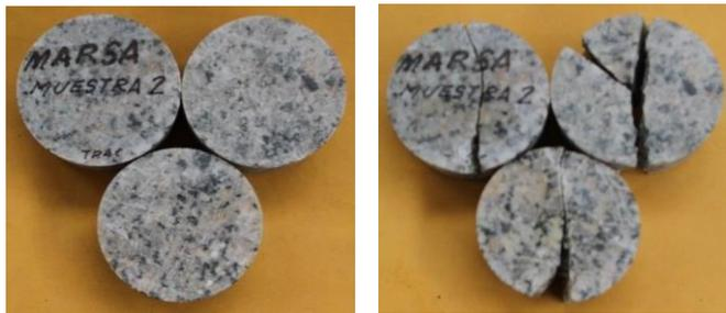
Imagen N° 21: Ensayo de tracción indirecta
