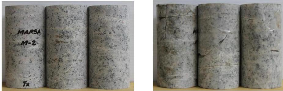
Imagen N° 19 :Ensayo de compresión triaxial
