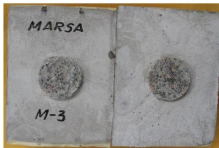
Imagen N° 22: Ensayo de corte directo
