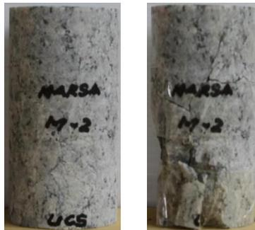
Imagen N° 18: Ensayo de compresión uniaxial
