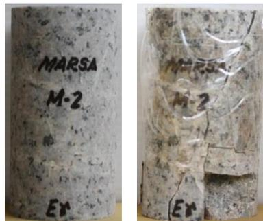
Imagen N° 20: Ensayo de constante elástica
