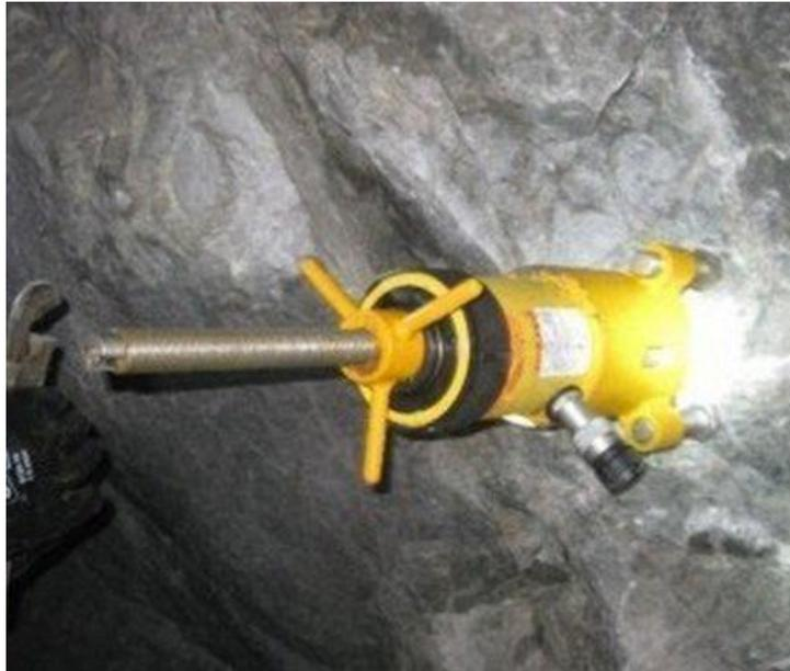
Imagen N° 09: Equipo “Pull – Test” Pull.
