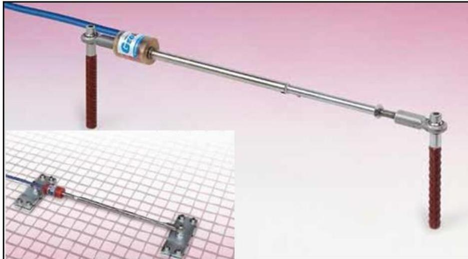
Imagen N° 10: Fisurómetro Lineal.
