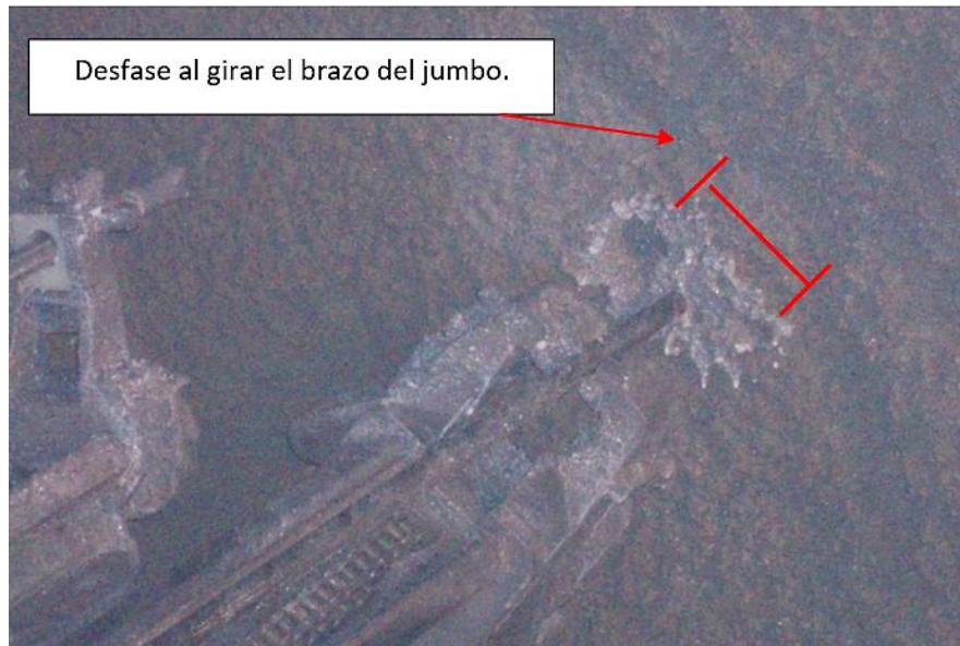
Figura N° 61: Desfase al girar el brazo del jumbo.
