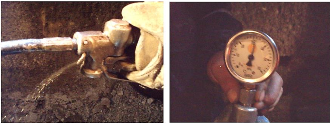
Figura N° 56: Pérdida de Presión del agua al no tener sus accesorios completos.
