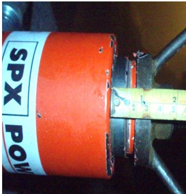
Figura N° 48: Deformación de 8 mm.
