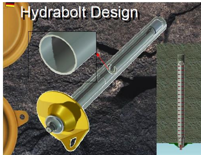
Figura N° 3: El color del perno Hydrabolt indica la longitud del perno.
