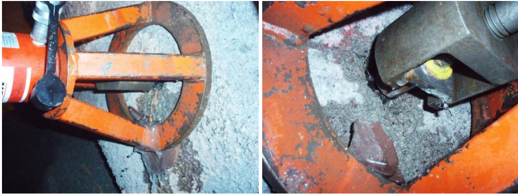
Figura N° 21: Perno en su máxima capacidad de deformación axial.
