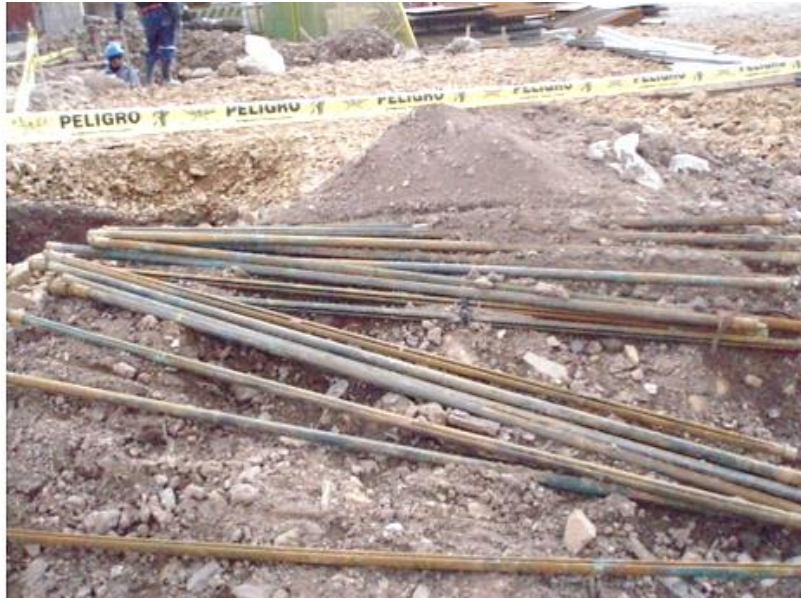
Figura N° 51: Pernos Hydrabolt descartadas válvulas malogradas.
