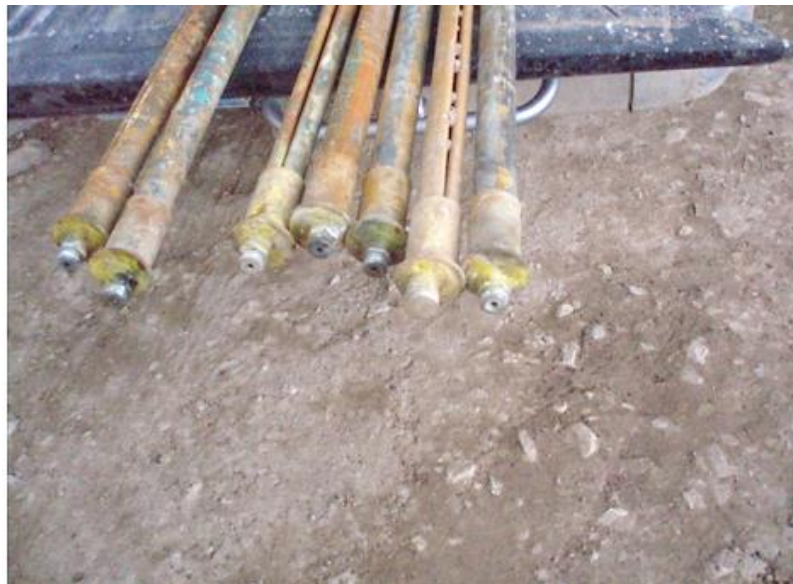
Figura N° 51: Pernos Hydrabolt descartadas válvulas malogradas.
