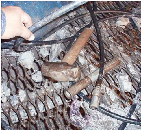
Figura N° 59: Instrumentos combo, empujador para instalar los pernos no son los adecuados.
