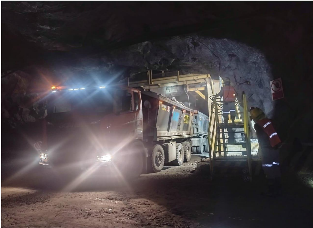
FOTO N°3: Carguío en el chute
