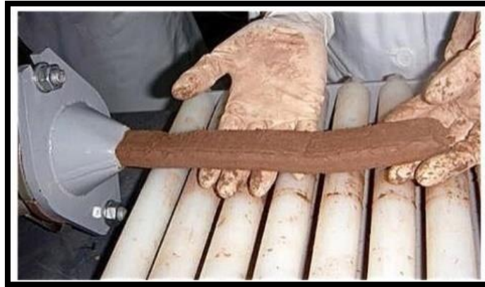
Gráfico 12: Mezcla de arcilla y celulosa
