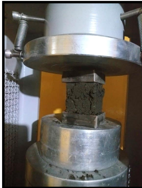
Grafico 22: Ensayo de resistencia a la compresión.
