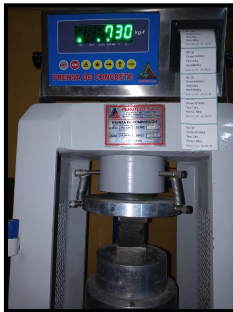
Grafico 20: Equipo para pruebas de compresión de concreto
