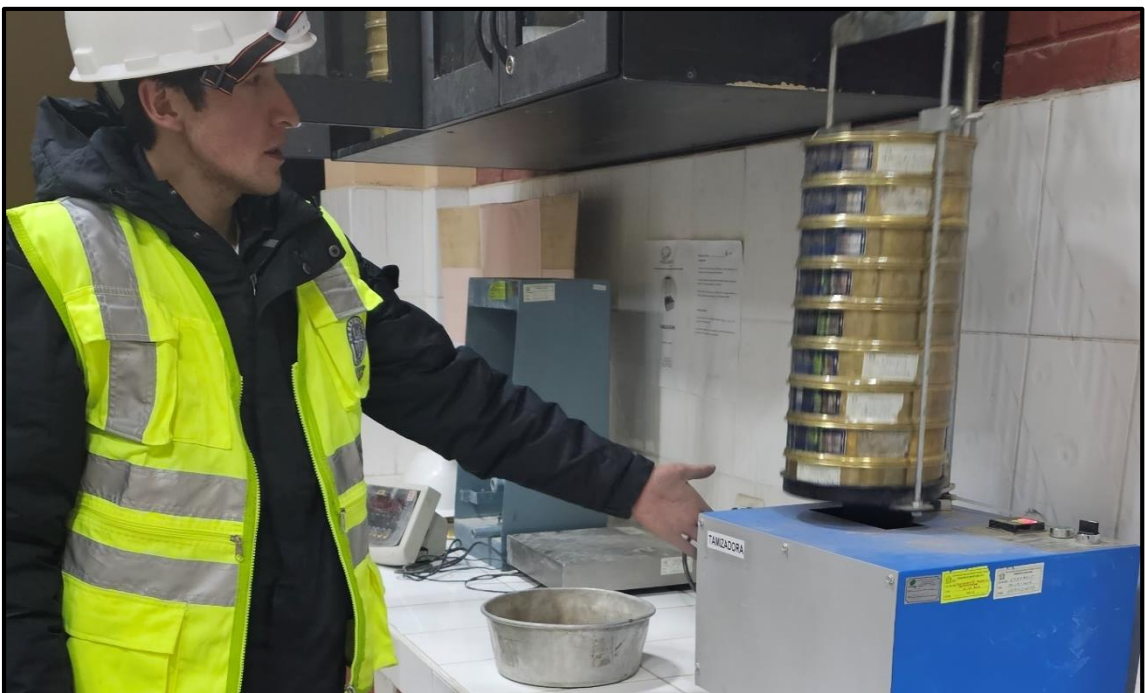
Fotografía 16.- Ensayo para análisis granométrica por tamizado del agregado grueso.
