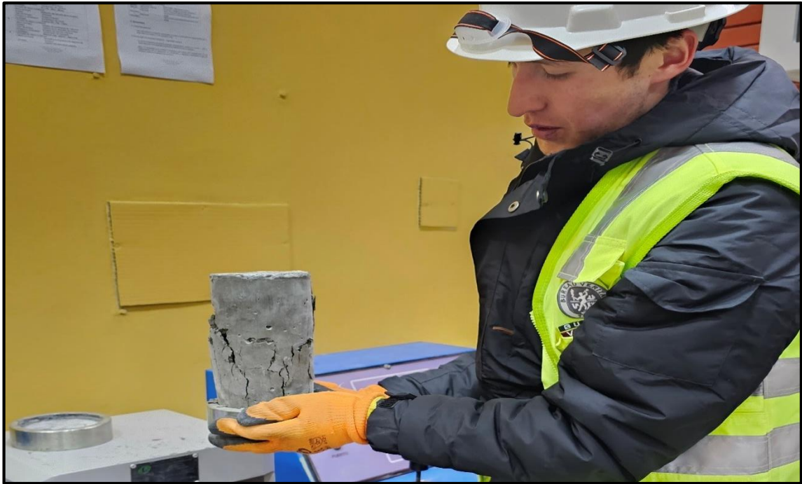
Fotografía 41.- Observación de la falla de concreto para el ensayo de resistencia a la compresión.
