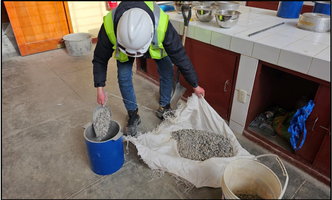
Fotografía 05.- Ensayo de peso unitario suelto del agregado grueso.
