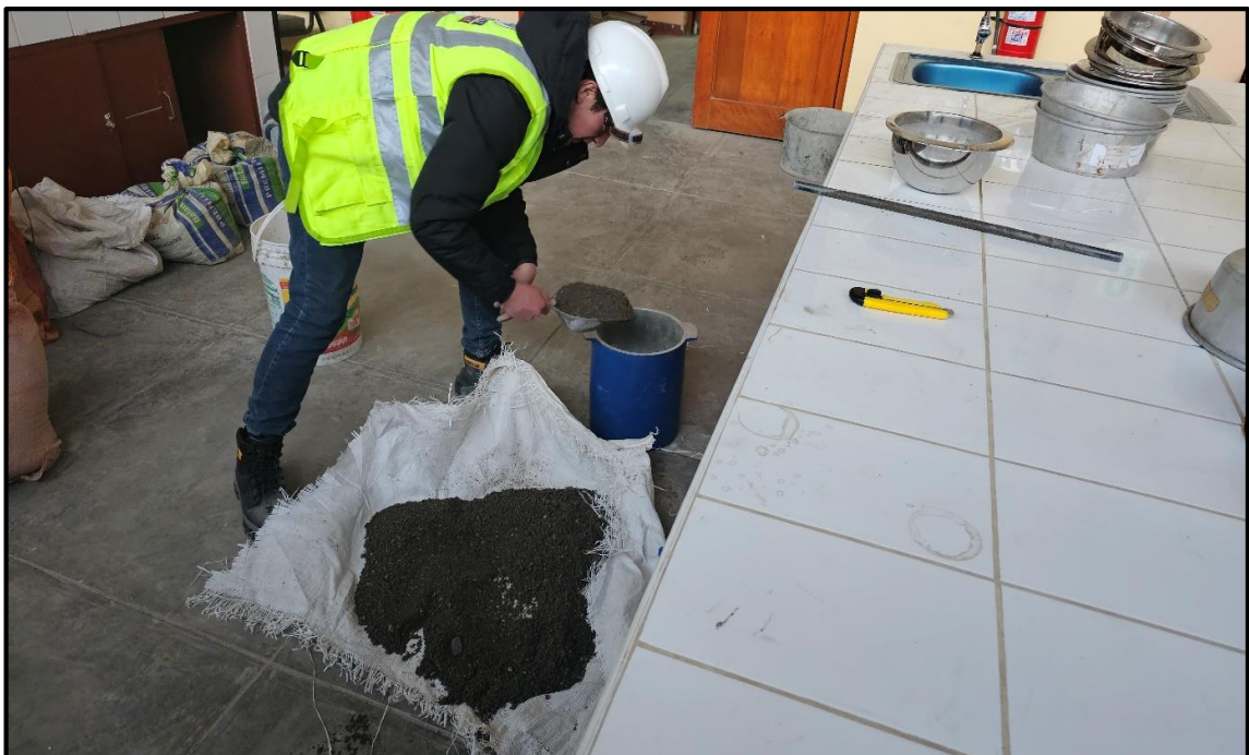
Fotografía 08.- Ensayo de peso unitario suelto del agregado fino.
