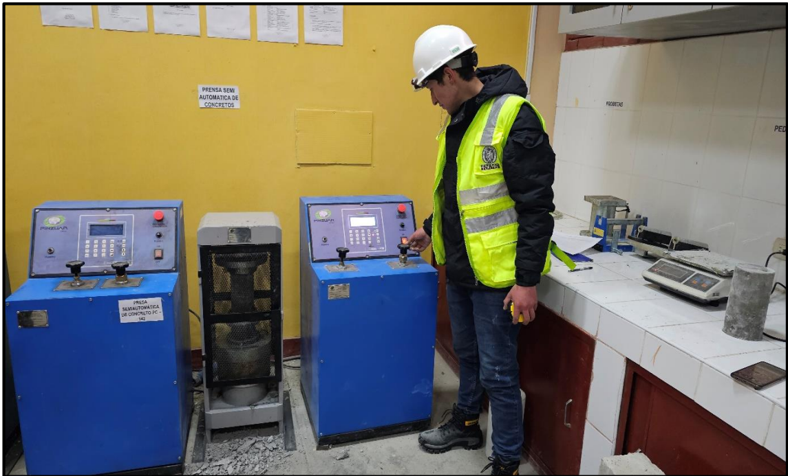
Fotografía 39.- Rotura de las probetas de concreto para el ensayo de resistencia a la compresión.
