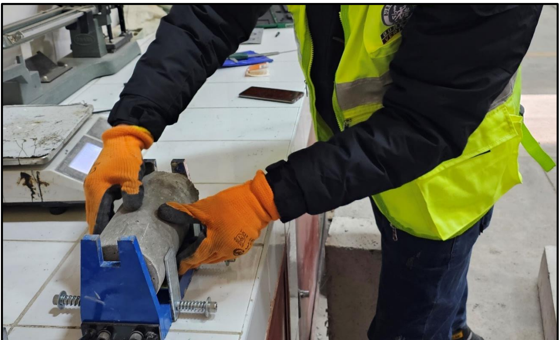
Fotografía 42.- Rotura de las probetas de concreto para el ensayo de resistencia a la tracción indirecta.
