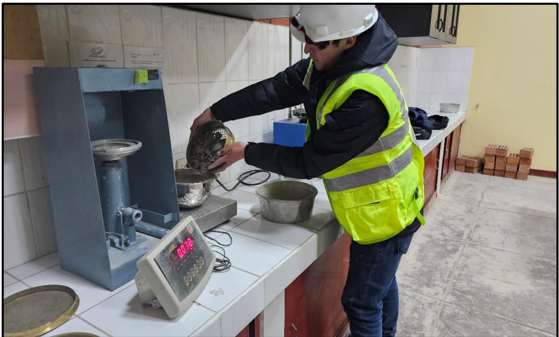
Fotografía 18.- Peso de cada agregado retenido en cada tamiz del agregado grueso.
