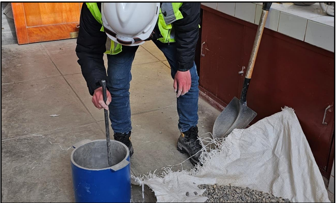
Fotografía 06.- Ensayo de peso unitario compactado del agregado grueso.
