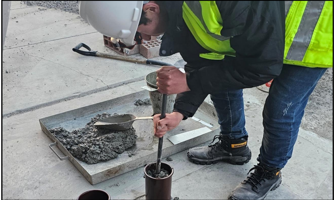
Fotografía 33.- Chuseada de las probetas con concreto combinado con CMH y Mineral Anhidrita.
