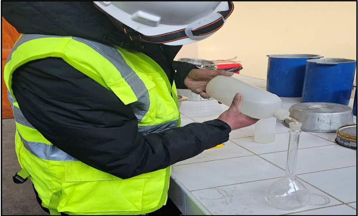
Fotografía 11.- Ensayo de peso específico y porcentaje de absorción del agregado fino.
