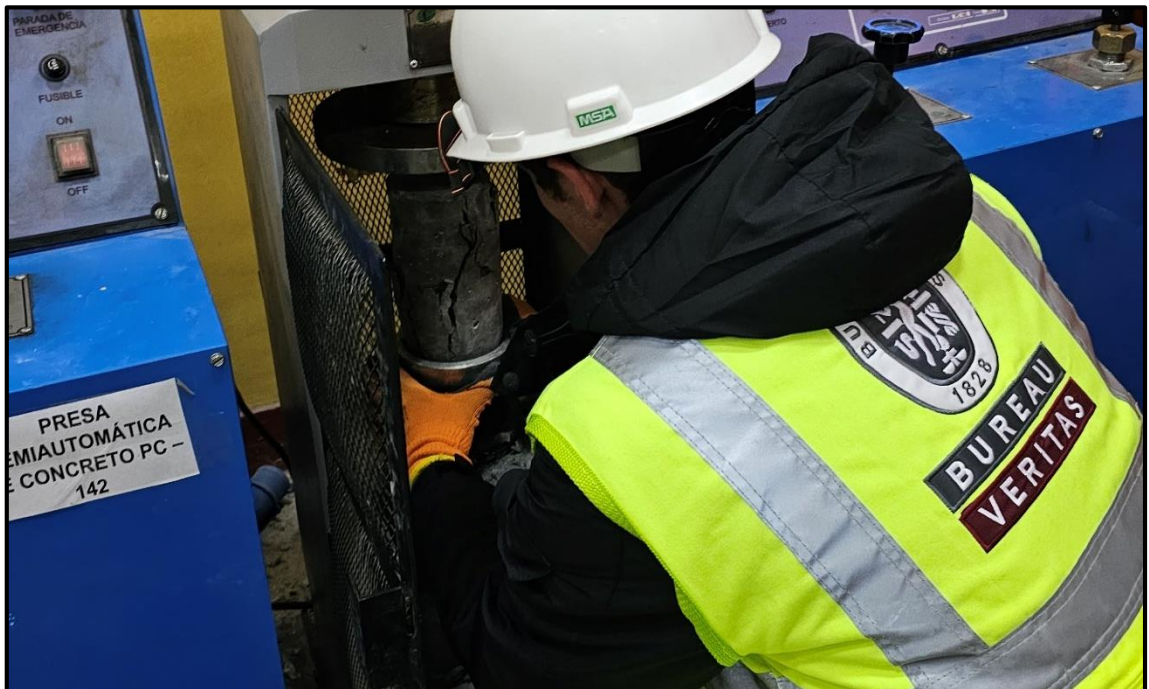
Fotografía 40.- Rotura de las probetas de concreto para el ensayo de resistencia a la compresión.
