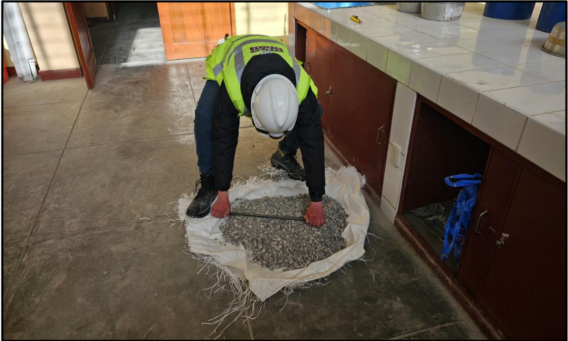
Fotografía 01.- Cuarteo del agregado grueso.
