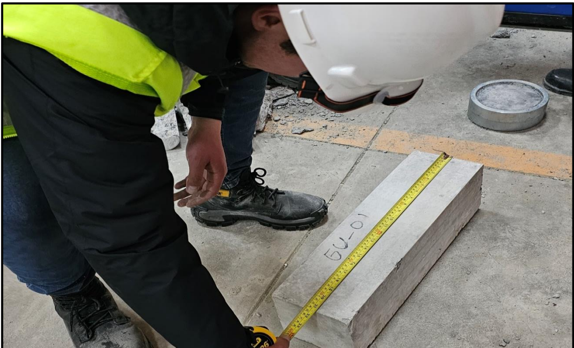
Fotografía 36.- Medición de la viga de concreto para el ensayo de resistencia a la flexión.
