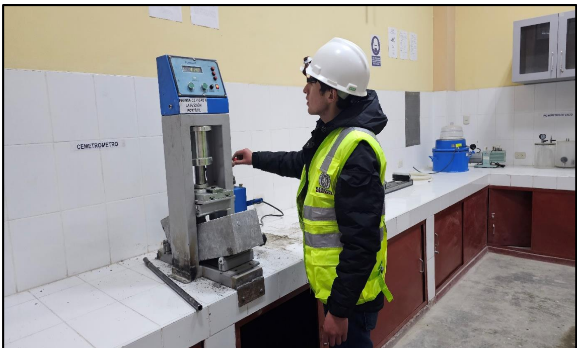
Fotografía 38.- Rotura de la viga de concreto para el ensayo de resistencia a la flexión.
