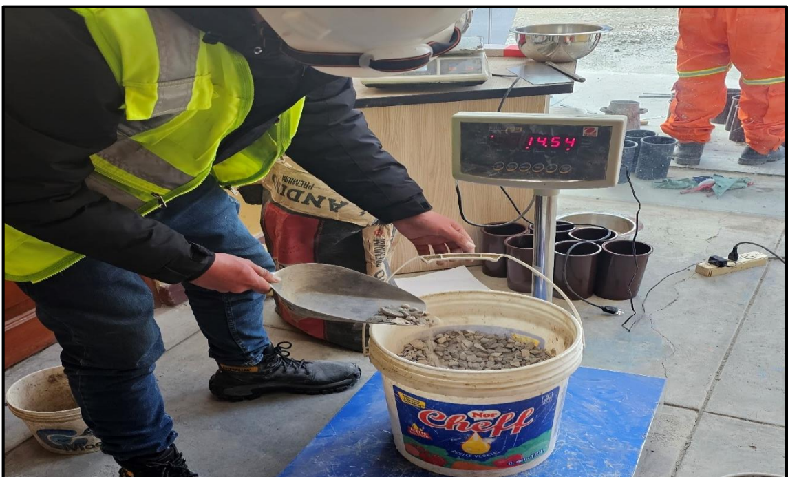
Fotografía 22.- Peso del material agregado grueso para la elaboración del concreto.
