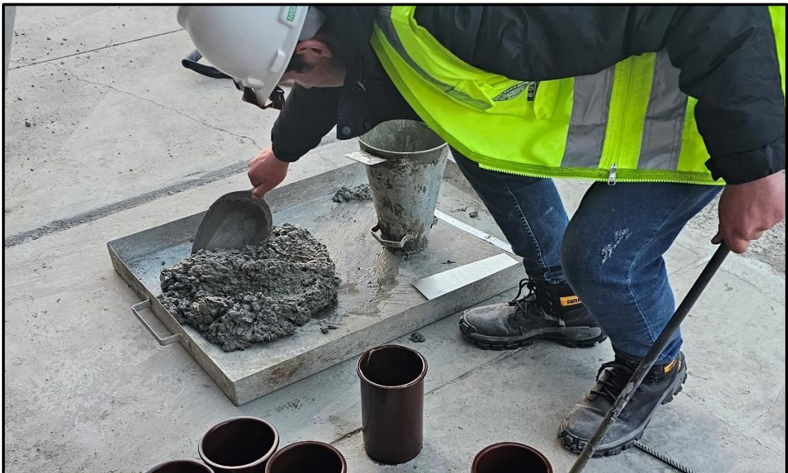
Fotografía 32.- Llenado de las probetas con concreto combinado con CMH y Mineral Anhidrita.
