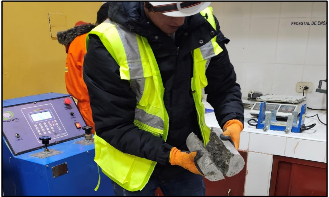
Fotografía 43.- Observación de la falla de concreto para el ensayo de resistencia a la tracción indirecta.
