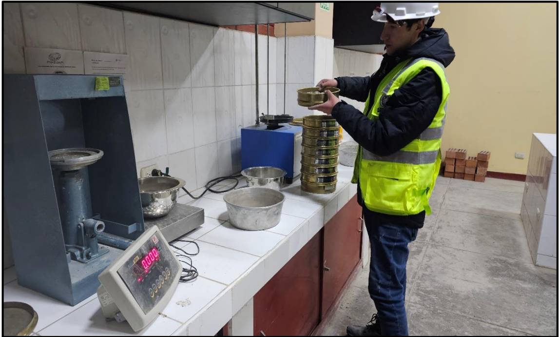
Fotografía 17.- Peso de cada agregado retenido en cada tamiz del agregado grueso.
