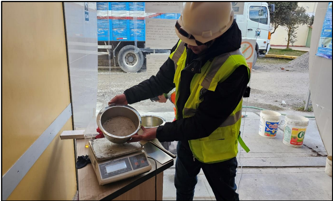
Fotografía 20.- Peso de cada agregado retenido en cada tamiz del agregado fino.
