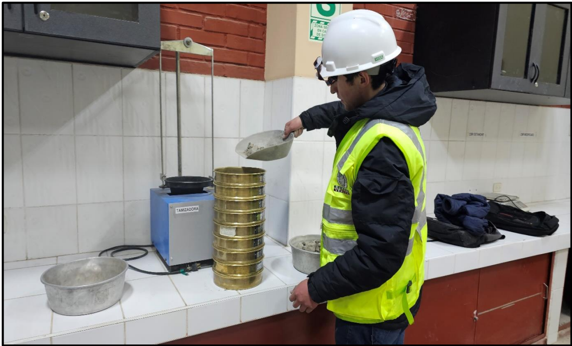
Fotografía 15.- Ensayo para análisis granométrica por tamizado del agregado grueso.
