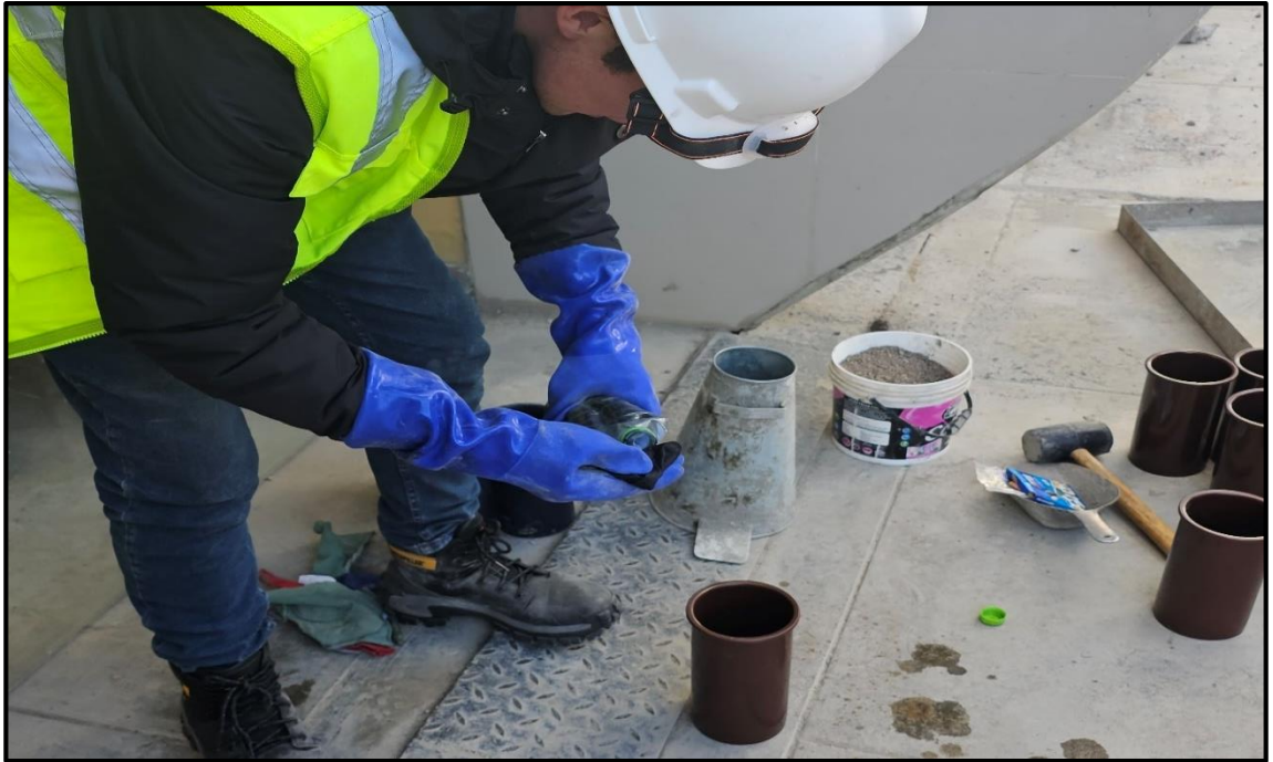
Fotografía 25.- Frotado de las probetas con gasolina.
