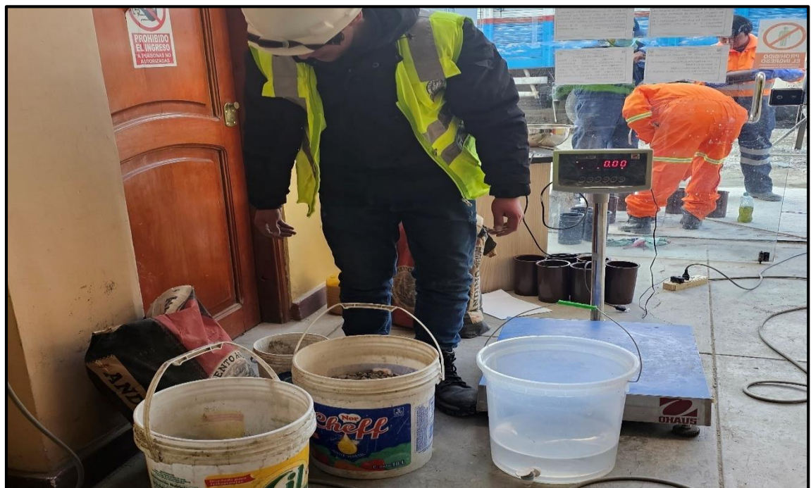
Fotografía 24.- Materiales para la elaboración del concreto adicionando CMH y Mineral Anhidrita.
