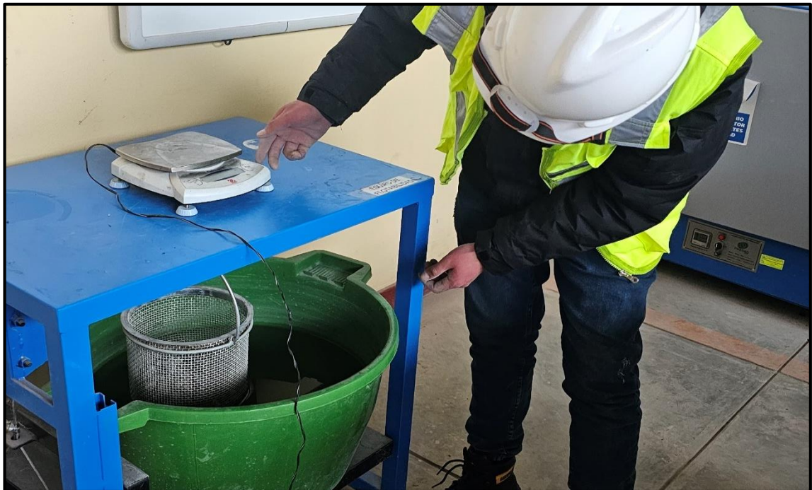
Fotografía 10.- Ensayo de peso específico y porcentaje de absorción del agregado grueso.
