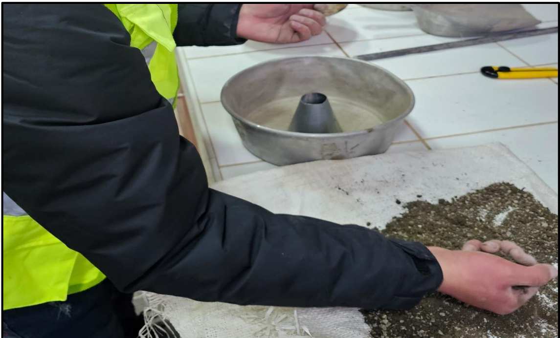
Fotografía 14.- Ensayo de peso específico y porcentaje de absorción del agregado fino.
