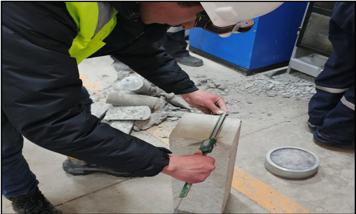
Fotografía 37.- Medición de la viga de concreto para el ensayo de resistencia a la flexión.
