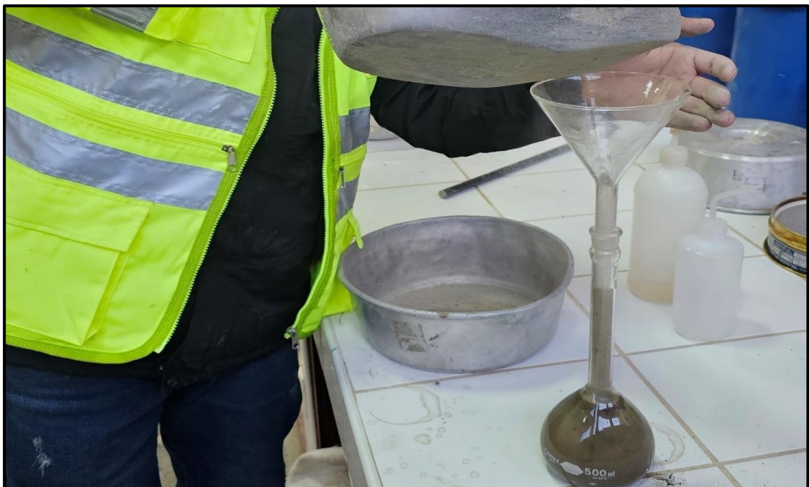
Fotografía 12.- Ensayo de peso específico y porcentaje de absorción del agregado fino.
