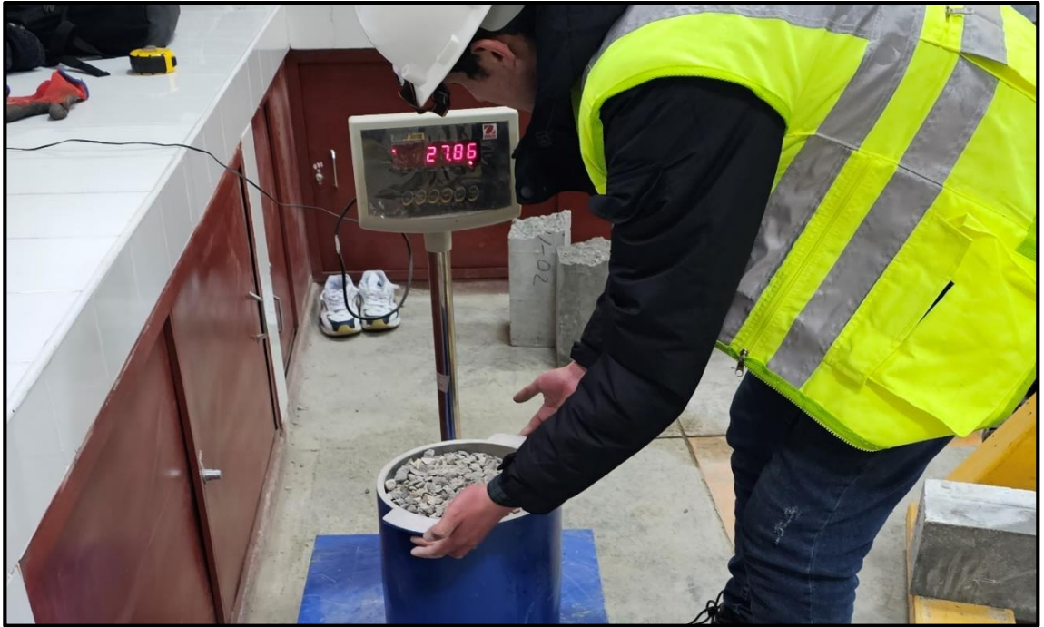
Fotografía 07.- Peso del agregado grueso para el ensayo de PUC y PUS.
