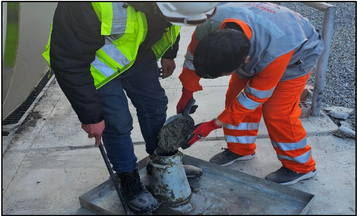
Fotografía 29.- Prueba con el cono de abrams para ver el asentamiento.
