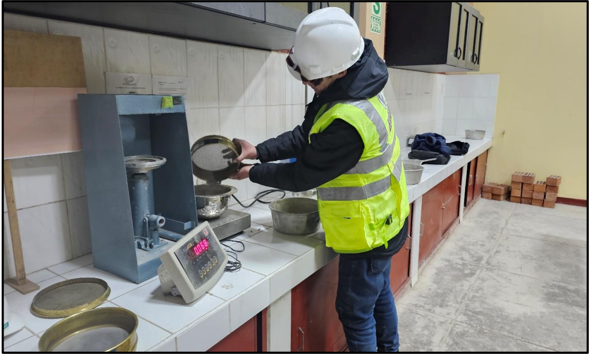
Fotografía 19.- Peso de cada agregado retenido en cada tamiz del agregado fino.
