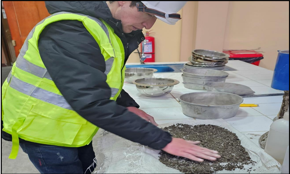
Fotografía 13.- Secado superficialmente del agregado fino.
