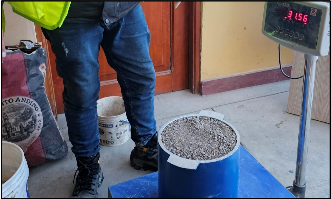
Fotografía 09.- Peso del agregado fino para el ensayo de PUC y PUS.
