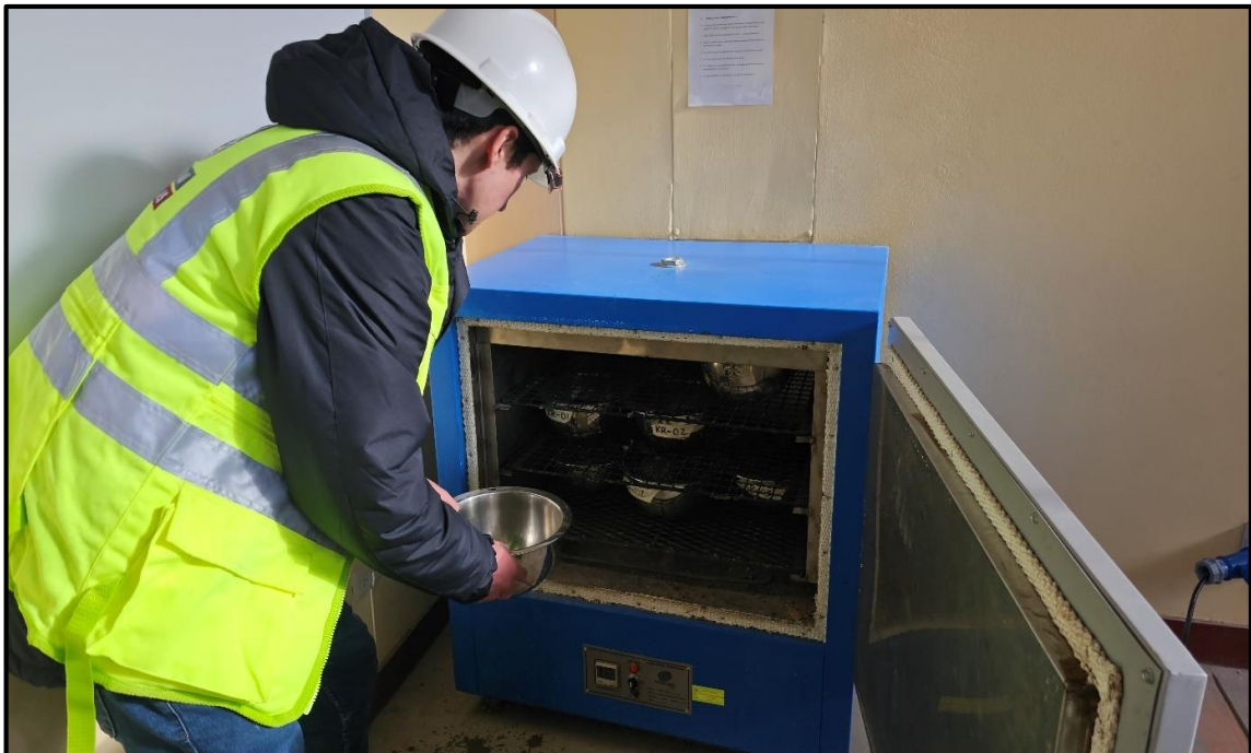
Fotografía 04.- Secado del agregado grueso en el horno a 110 °C.
