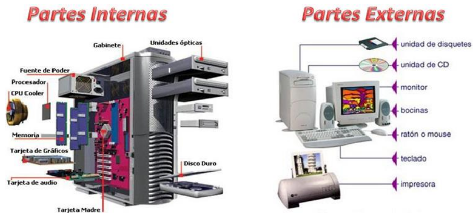
Figura N° 03: Partes internas y externas de una computadora.
