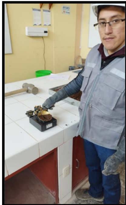
Figura 14. Ejecución de la prueba en la Copa Casagrande.
