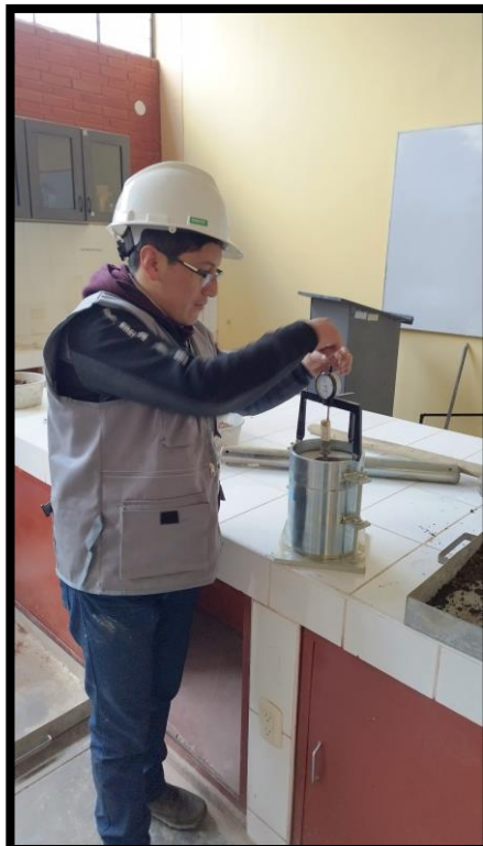
Figura 20. Enrase y colocación de sobrecargas.
