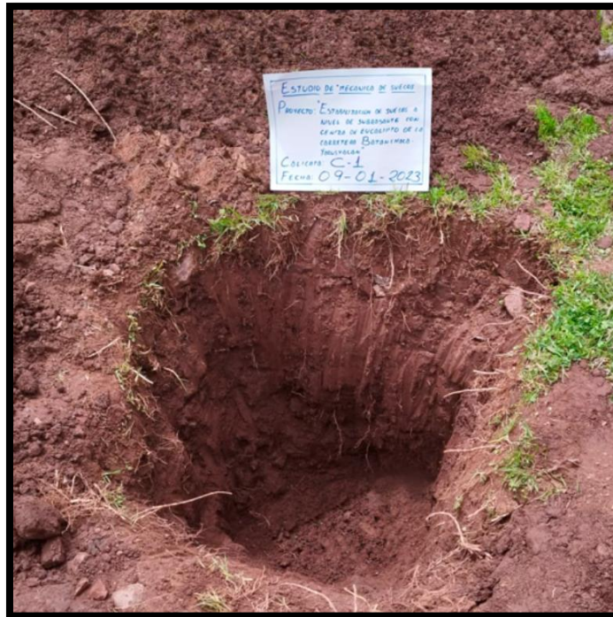
Figura 4. Zanja manual de calicata C-1.
