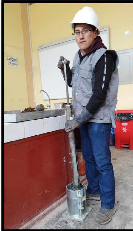
Figura 17. Compactado del experimento proctor.
