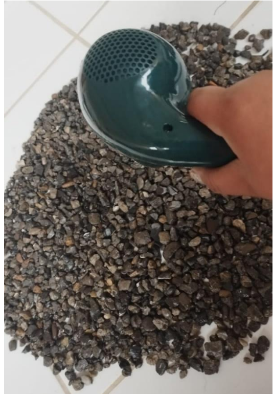
Imagen N° 22: la muestra en SSS para el ensayo de peso específico y absorción
