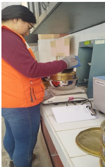
Imagen N° 15: pesando la muestra para el ensayo de granulometría
