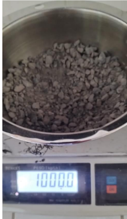
Imagen N° 18: pesamos la muestra para el ensayo de peso específico y absorción
