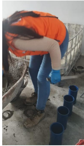
Imagen N° 38: ya obtenida la mezcla realizamos los especímenes de concreto 4" x 6"
