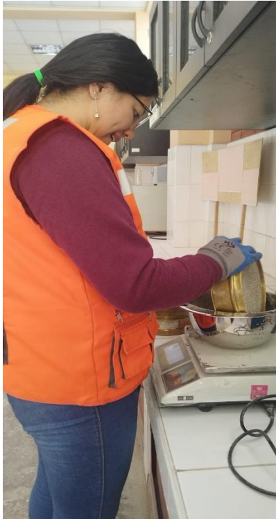
Imagen N° 17: pesando las gradaciones de la muestra para el
