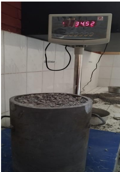
Imagen N° 31: pesamos la segunda muestra para el ensayo del peso unitario
