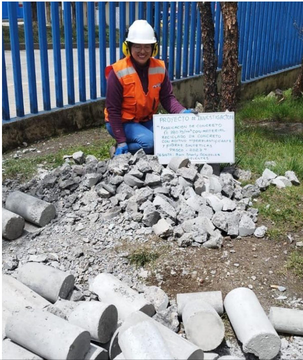
Imagen N° 5: especímenes de concreto reciclado triturados listos para ser transportado a la
