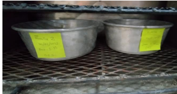
Imagen N° 26: rotulamos el recipiente para el ensayo de peso específico y absorción
