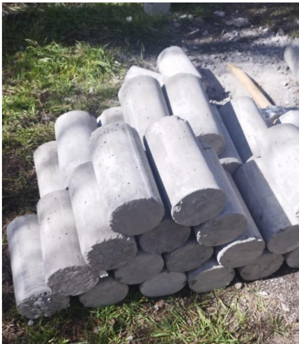
Imagen N° 3: especímenes de concreto reciclado listos para ser triturados
