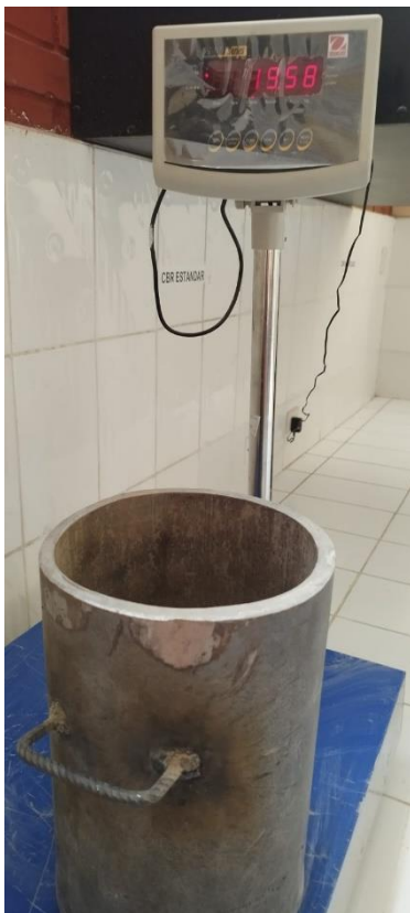
Imagen N° 27: pesamos el recipiente para el ensayo del peso unitario
