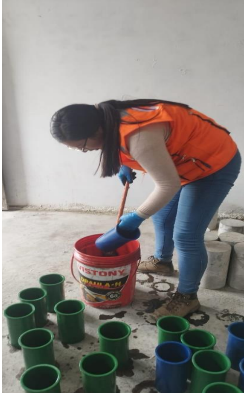
Imagen N° 41: echamos más desmoldante a los probetas para realizar nuestro de ensayo de elaboración de
