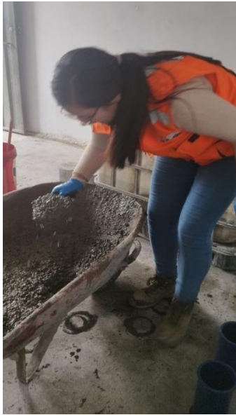
Imagen N° 37: ya obtenida la mezcla realizamos los especímenes de concreto 4" x 6"
