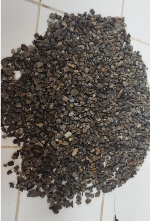
Imagen N° 21: La muestra después de la decantación para el ensayo de peso específico y absorción
