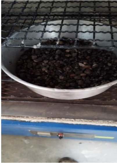
Imagen N° 25: la muestra llevamos al recipiente para el ensayo de peso específico y absorción
