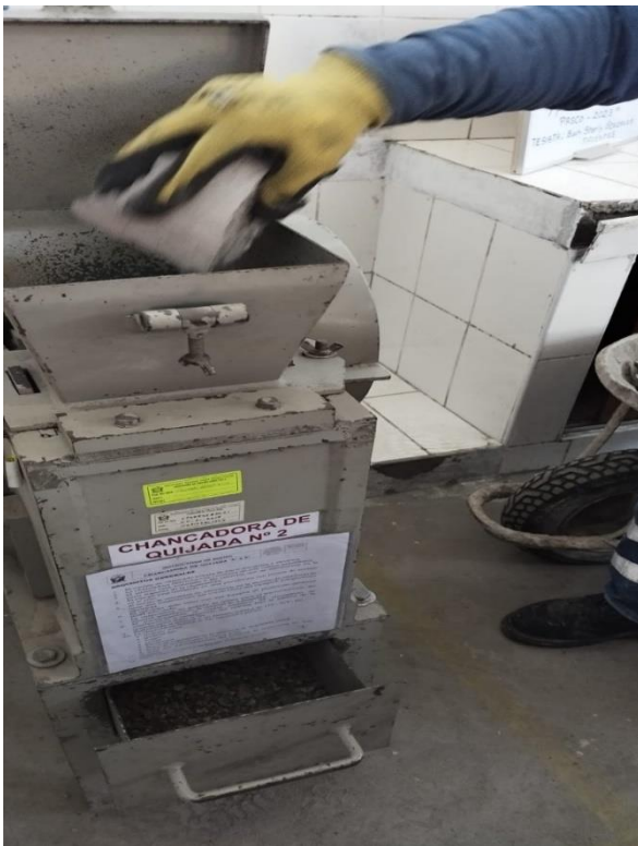
Imagen N° 7: especímenes de concreto reciclado triturados ingresando a la chancadora de
