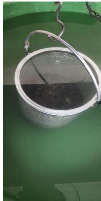
Imagen N° 24: adicionamos la muestra en sss dentro de la canastilla y registramos el peso para el ensayo de peso específico y absorción
