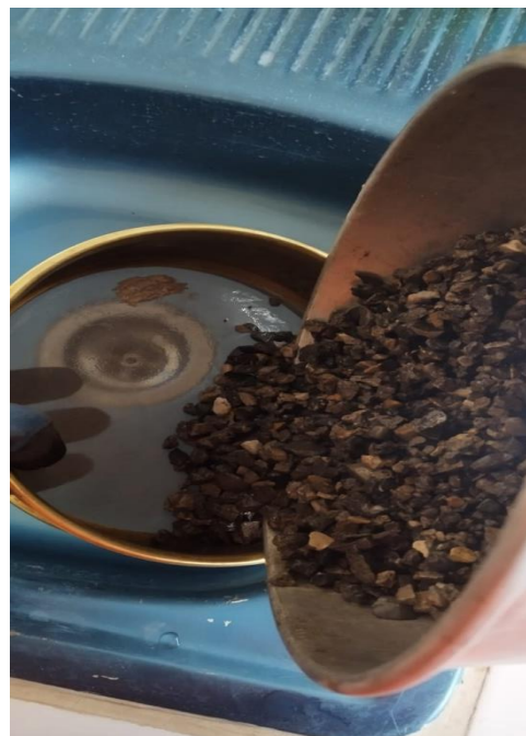
Imagen N° 20: decantamos la muestra para el ensayo de peso específico y absorción
