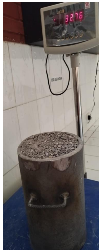
Imagen N° 28: pesamos la primera muestra para el ensayo del peso unitario suelto
