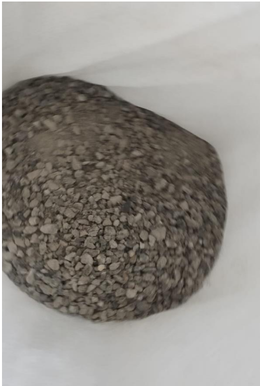
Imagen N° 13: obtención de nuestro agregado reciclado
