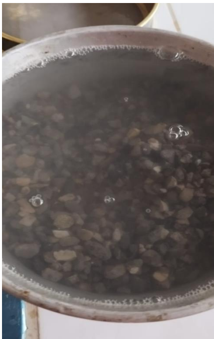
Imagen N° 19: cubrimos la muestra para el ensayo de peso específico y absorción
