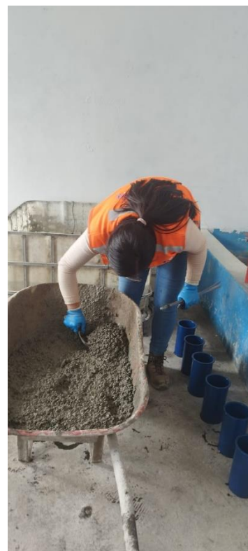
Imagen N° 40: realizamos los especímenes de concreto 4" x 6" finalmente texturizamos la probeta
