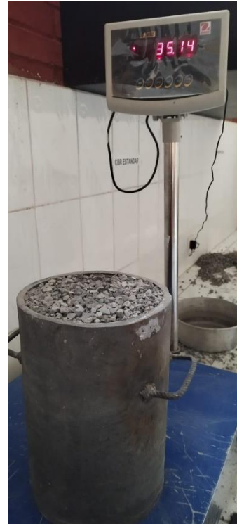
Imagen N° 30: pesamos la primera muestra para el ensayo del peso unitario
