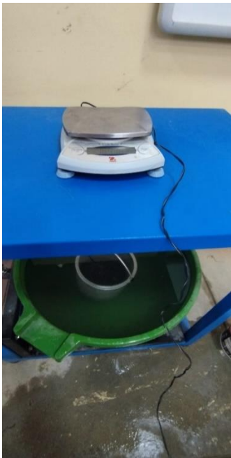
Imagen N° 23: sumergir la canastilla metálica en un recipiente lleno de agua para el ensayo de peso específico y absorción
