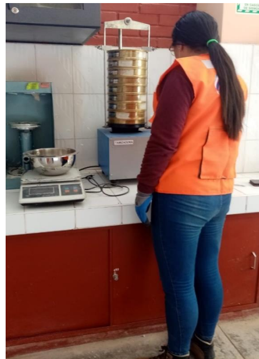
Imagen N° 16: tamizando la muestra para el ensayo de granulometría
