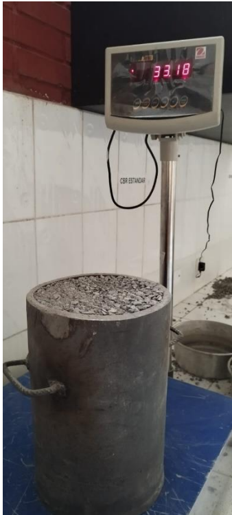
Imagen N° 29: pesamos la segunda muestra para el ensayo del peso unitario
