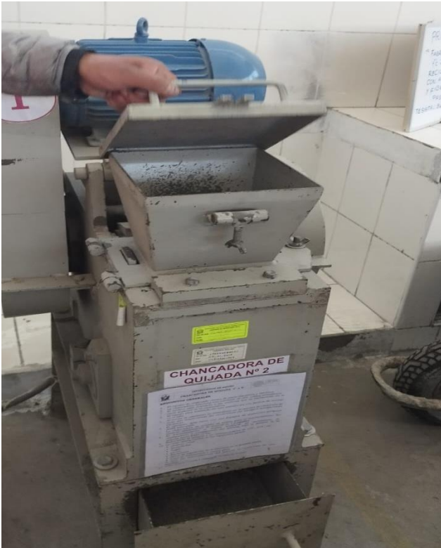
Imagen N° 9: observando el proceso de trituración de los especímenes de concreto reciclado en la chancadora de
