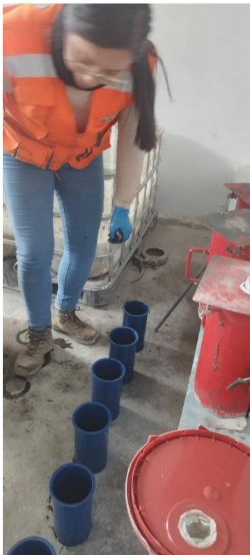
Imagen N° 39: realizamos los especímenes de concreto 4" x 6" para este tamaño con 2 capas con 15 chuseadas
