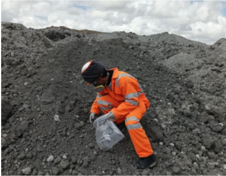
Imagen 01: Muestreo de material de relave filtrado de la zona de Apilamiento en Planta de Filtrado – Chungar.
