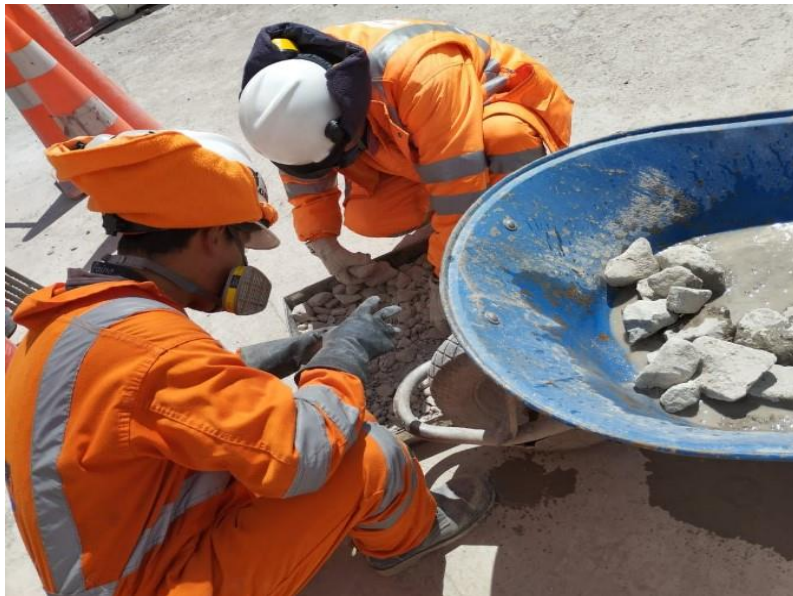
Imagen 02: Preparación y selección de material mezclado 3:1 para ensayo de proctor modificado en laboratorio.
