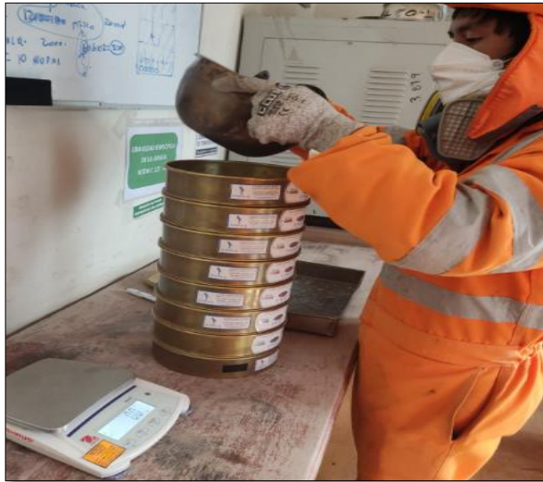
Ilustración 41: Mallas que se utilizaron para el ensayo.
