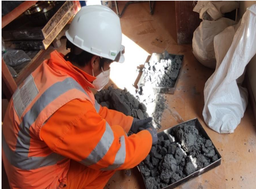
Imagen 03: Preparación de material relave filtrado para el ensayo de contenido de humedad.
