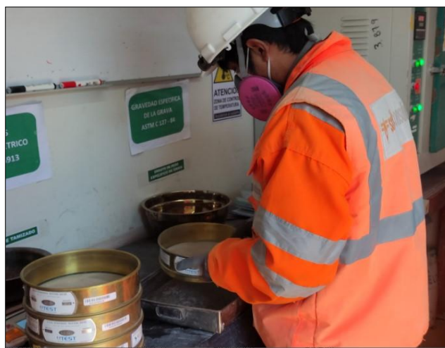
Ilustración 42: Tamizado de ensayo granulométrico.
