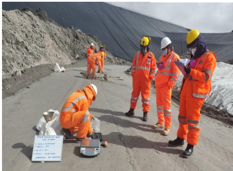
Imagen 10: Determinación de la densidad seca y el grado de compactación de la plataforma compactada para el proceso de liberación.
