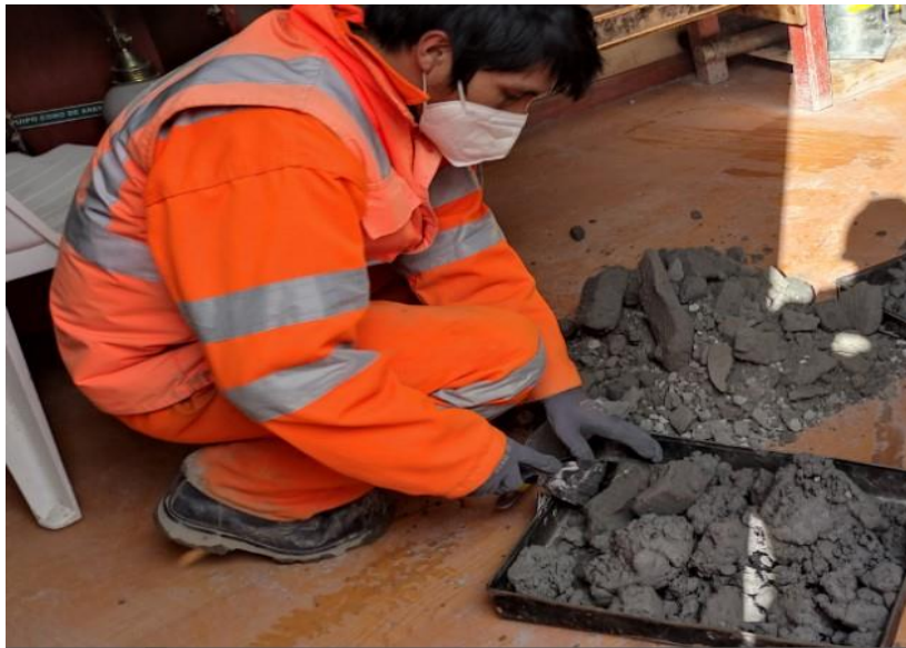
Imagen 04: Cuarteo y selección de material relave filtrado para el ensayo de proctor modificado en laboratorio.
