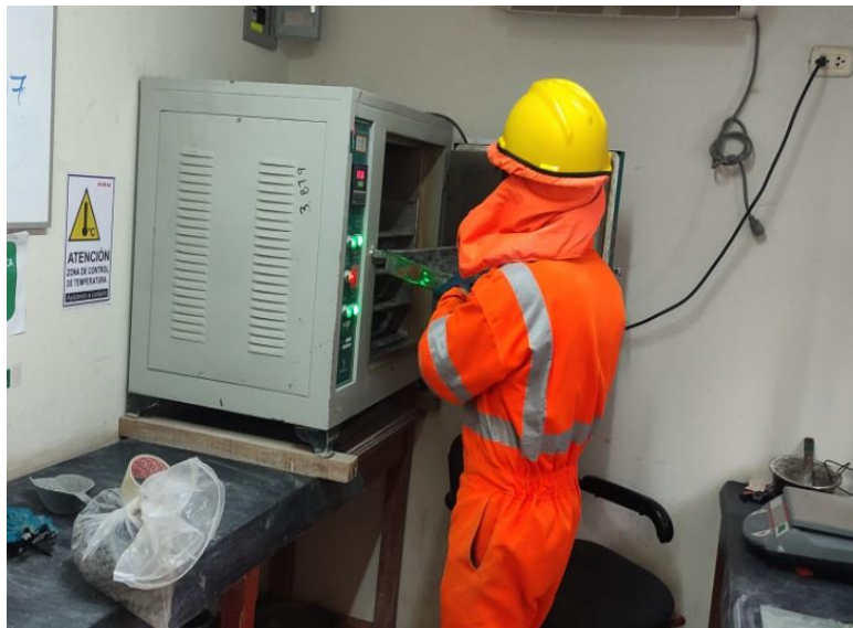
Imagen 06: Colocación de muestra en el horno para el secado de material para el ensayo granulométrico.
