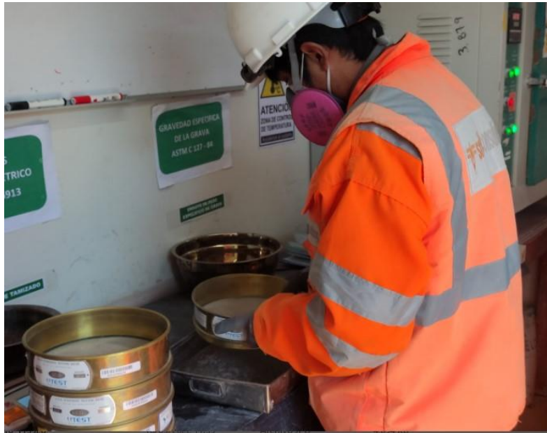
Imagen 07: Preparación de la serie de mallas para el tamizado de material para el ensayo del análisis granulométrico.
