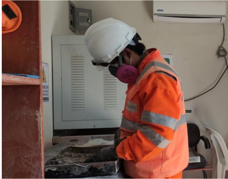
Imagen 05: Selección y preparación del material para el ensayo de límites de consistencia.
