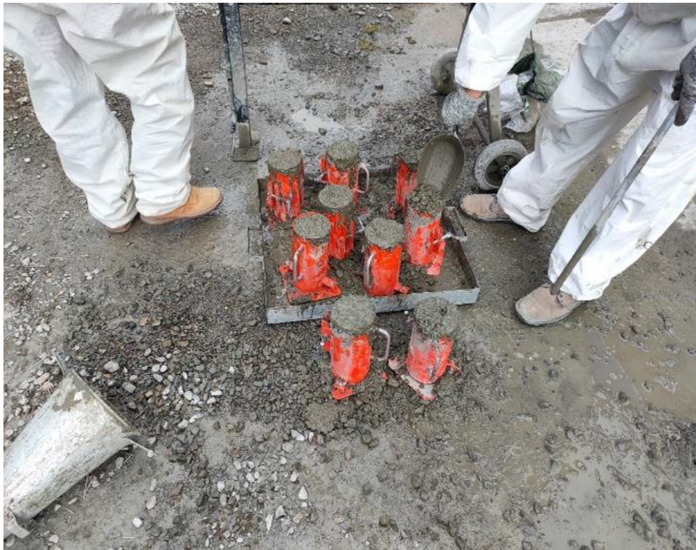
Fotografía 18. Elaboración de Probetas de concreto ASTM C31 (Método ACI).
