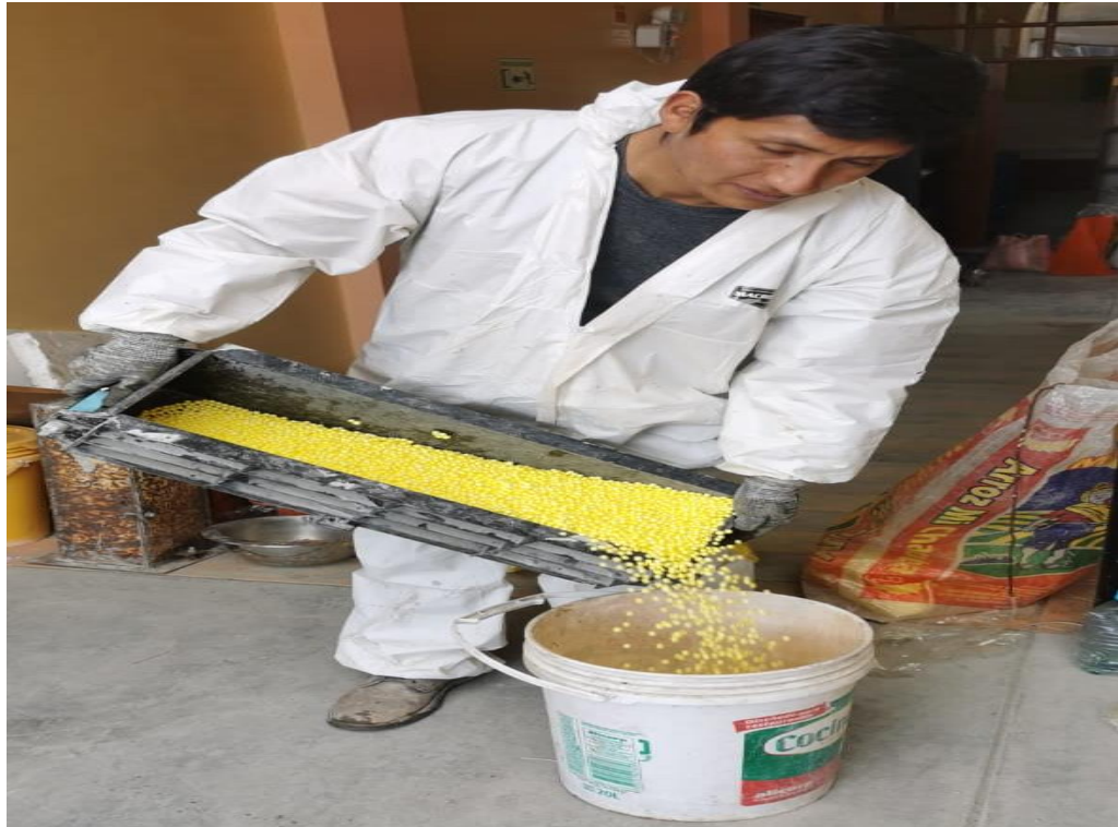
Fotografía 11. Dosificación de poliestireno expandido y fibras de acero 3D para nuestro concreto.
