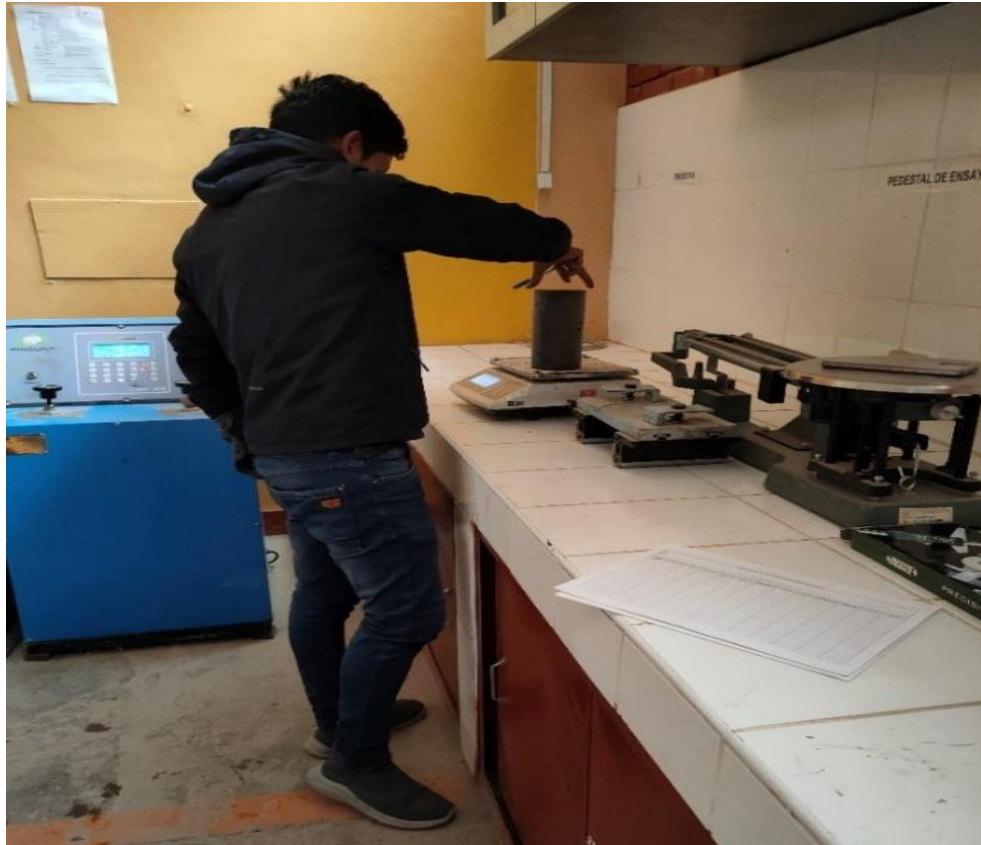
Fotografía 31. Se aprecia el pesado de cada probeta para después ser ensayadas.
