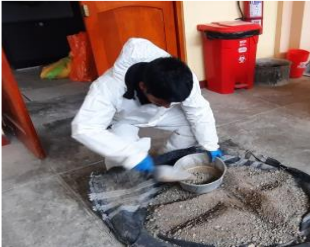
Fotografía 3. Cuarteo de los agregados finos y gruesos.
