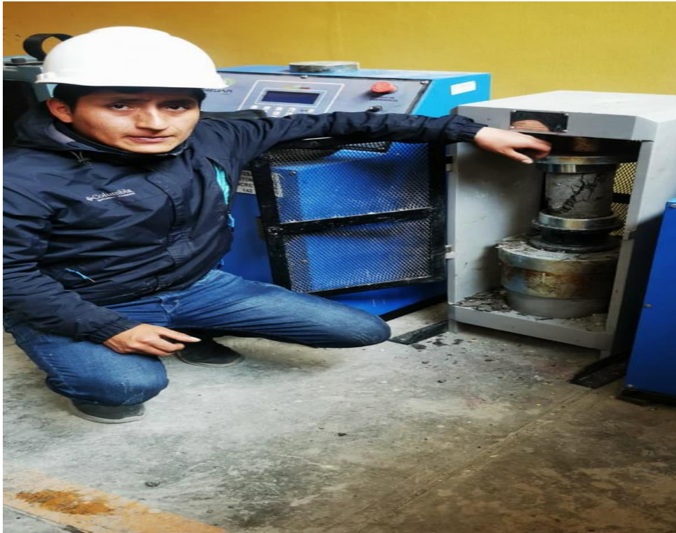
Fotografía 35. Verificación tipo de corte en el ensayo resistencia a la compresión de los testigos.
