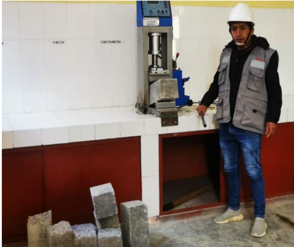
Fotografía 51. Proceso de ensayado y control de la velocidad en la rotura a compresión de los testigos.
