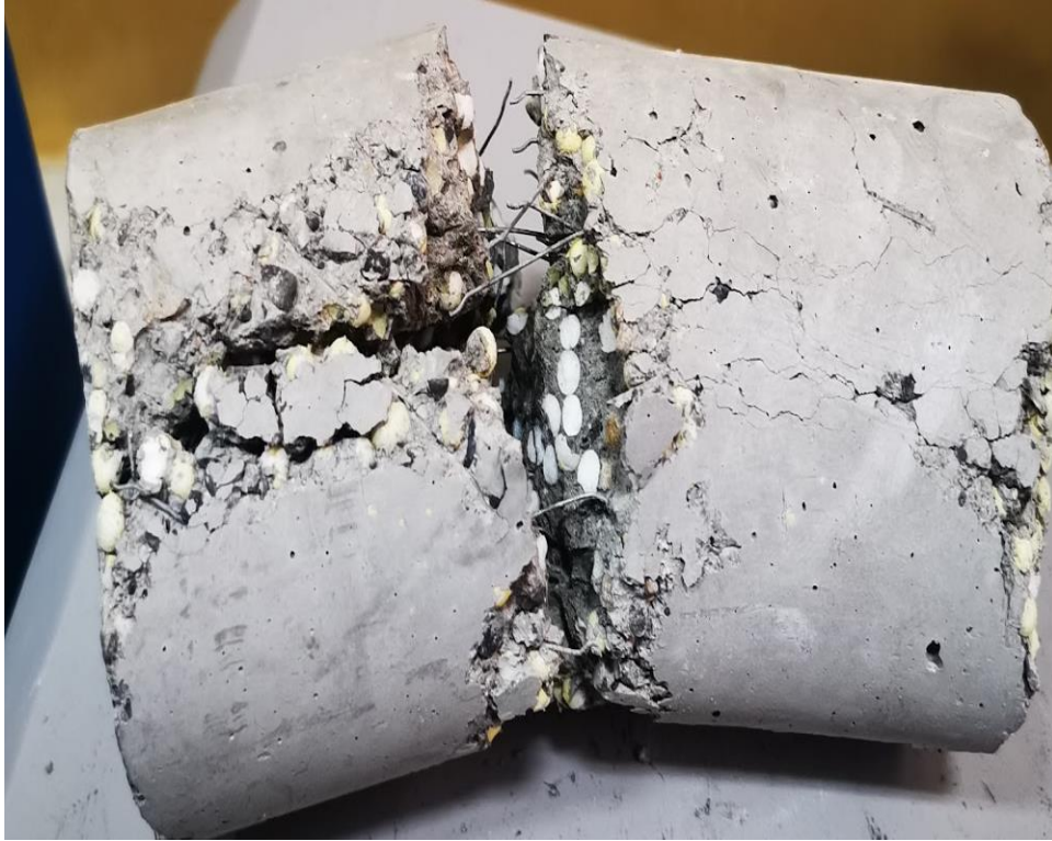
Fotografía 45. Se aprecia la probeta ensayada a resistencia a la tracción indirecta.
