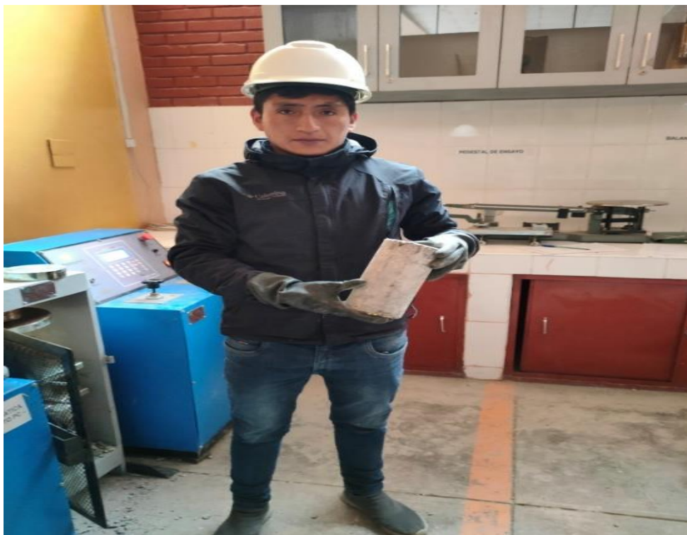
Fotografía 36. Verificación tipo de corte en el ensayo resistencia a la compresión de los testigos.
