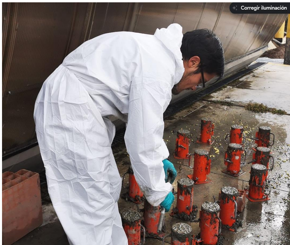
Fotografía 22. Elaboración de Probetas de concreto ASTM C31 (Método ACI).
