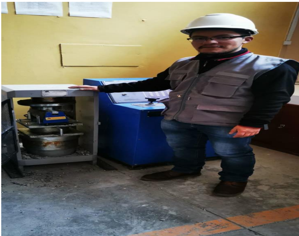
Fotografía 34. Proceso de ensayado y control de la velocidad en la rotura a tracción indirecta de los testigos.
