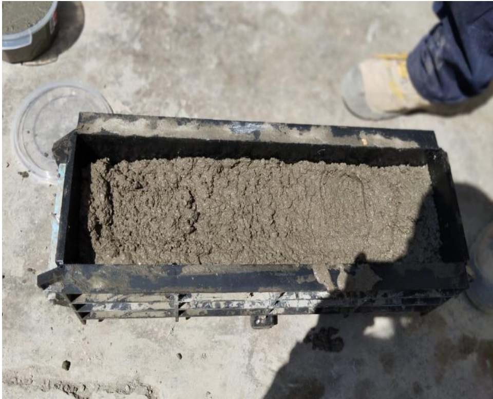
Fotografía 47. Elaboración de las vigas para ser ensayadas a flexión NTP
