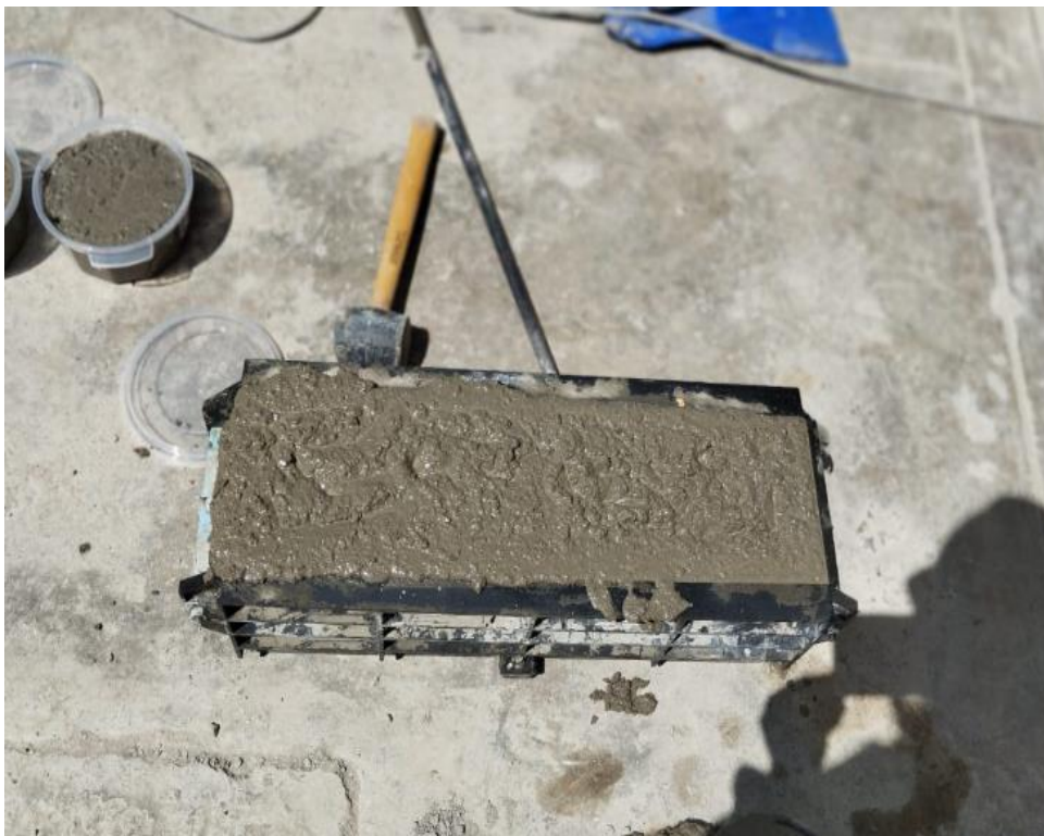
Fotografía 48. Elaboración de las vigas para ser ensayadas a flexión NTP
