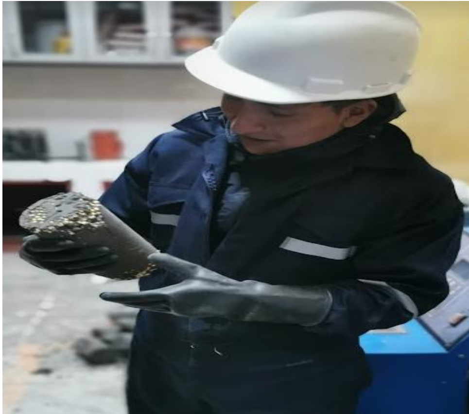
Fotografía 43. Se aprecia la probeta ensayada a resistencia a la compresión.
