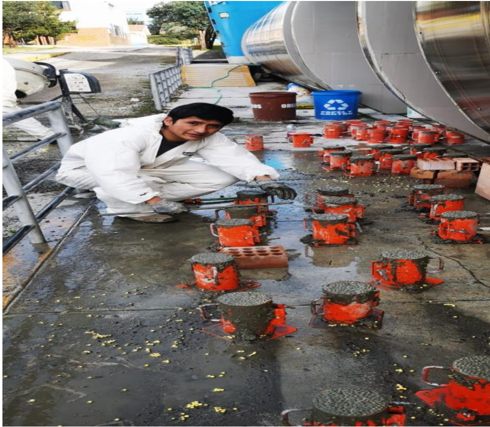
Fotografía 19. Elaboración de Probetas de concreto ASTM C31 (Método ACI).
