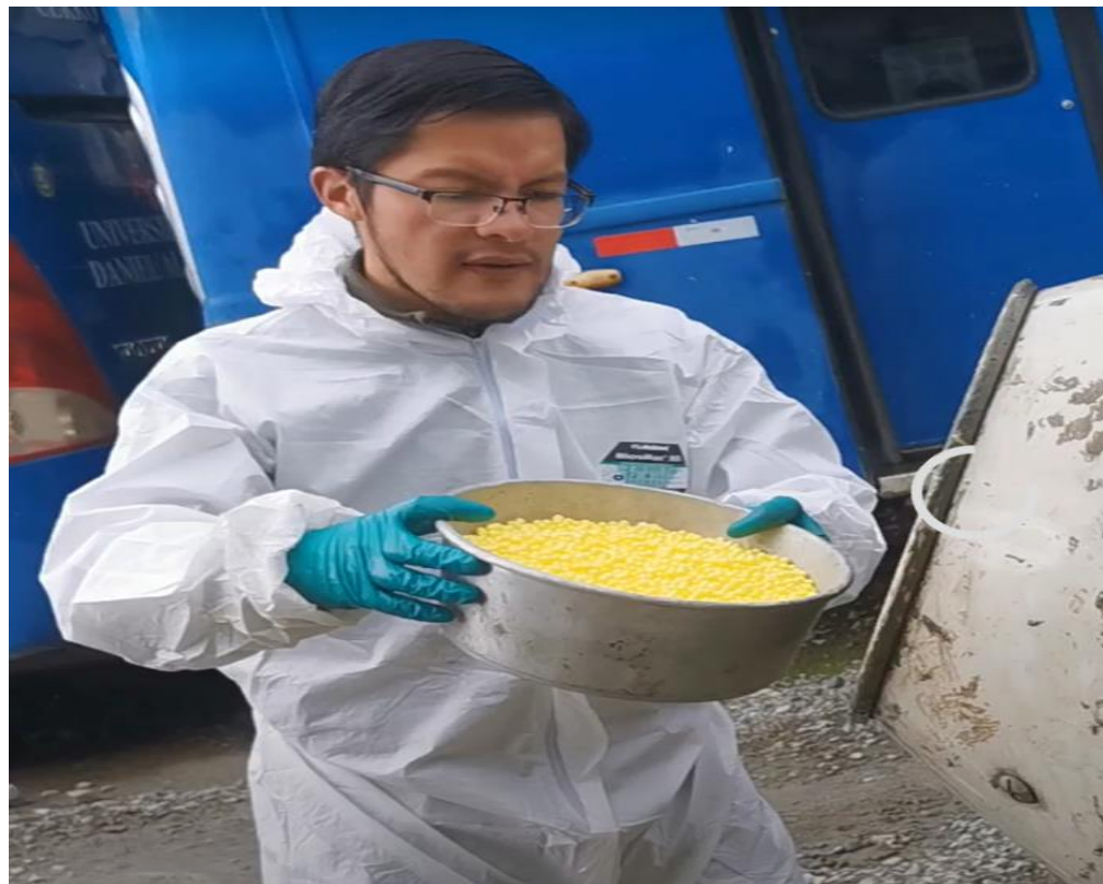
Fotografía 14. Dosificación de poliestireno expandido y fibras de acero 3D para nuestro concreto.
