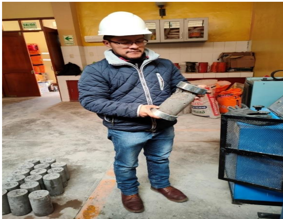
Fotografía 40. Verificación tipo de corte en el ensayo resistencia a la compresión de los testigos.
