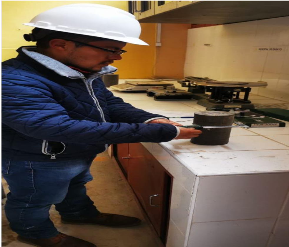
Fotografía 29. Toma de las dimensiones de las probetas para ser ensayadas.
