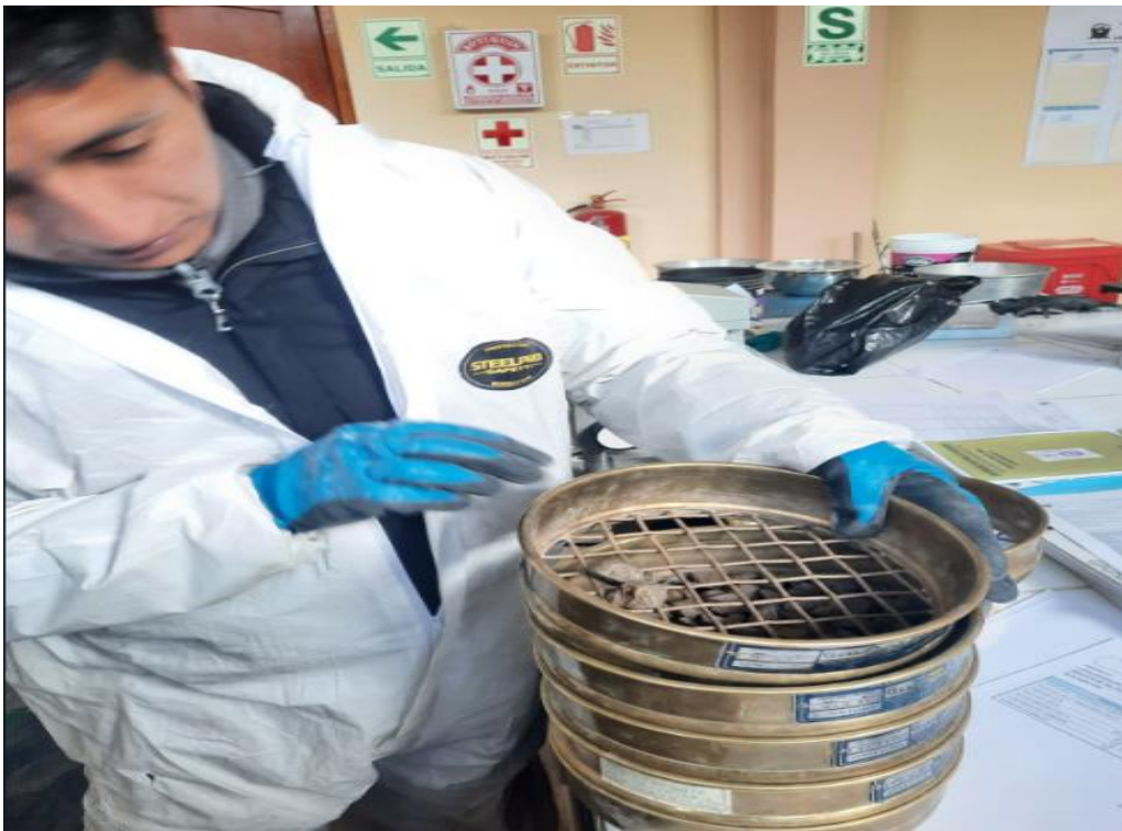
Fotografía 6. Método de prueba para el análisis granulométrico de agregados finos y gruesos.
