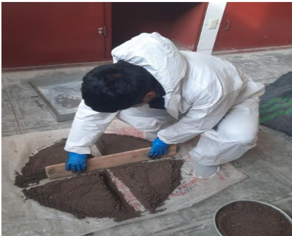
Fotografía 4. Cuarteo de los agregados finos y gruesos.
