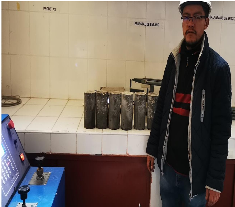
Fotografía 46. Proceso de ensayo y control de la velocidad en la rotura a la tracción indirecta de los testigos.
