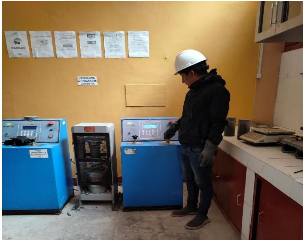
Fotografía 33. Proceso de ensayado y control de la velocidad en la rotura a compresión de los testigos.
