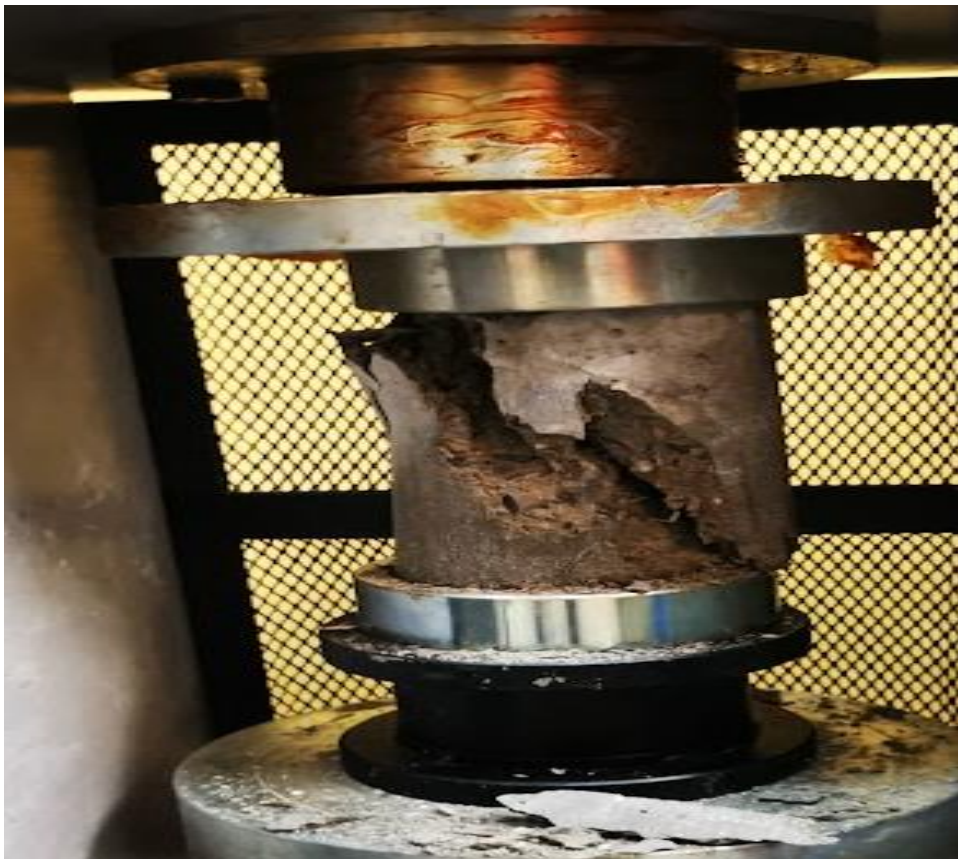
Fotografía 42. Se aprecia la probeta ensayada a resistencia a la compresión.
