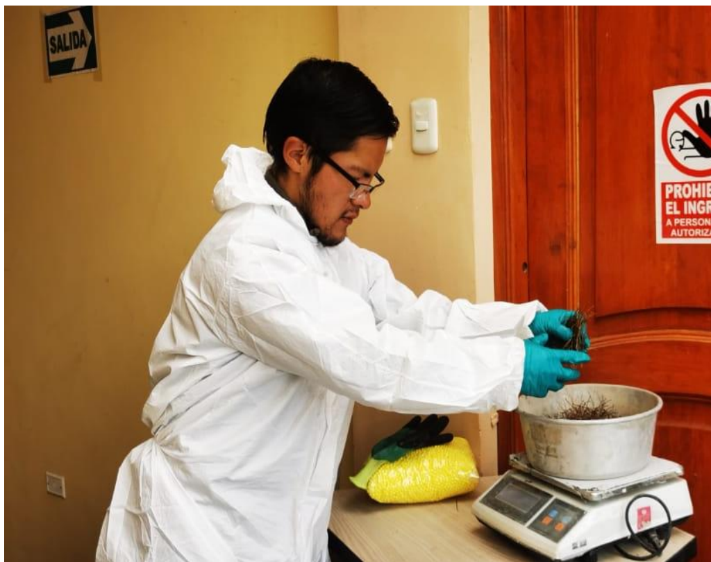
Fotografía 10. Dosificación de fibras de acero 3D para nuestro concreto.
