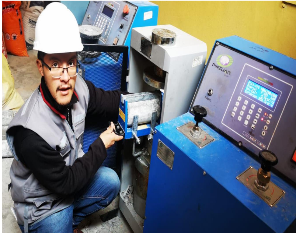
Fotografía 37. Proceso de ensayo y control de la velocidad en la rotura a la tracción indirecta de los testigos.
