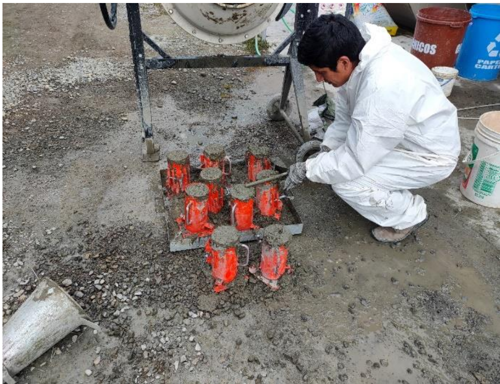
Fotografía 20. Elaboración de Probetas de concreto ASTM C31 (Método ACI).
