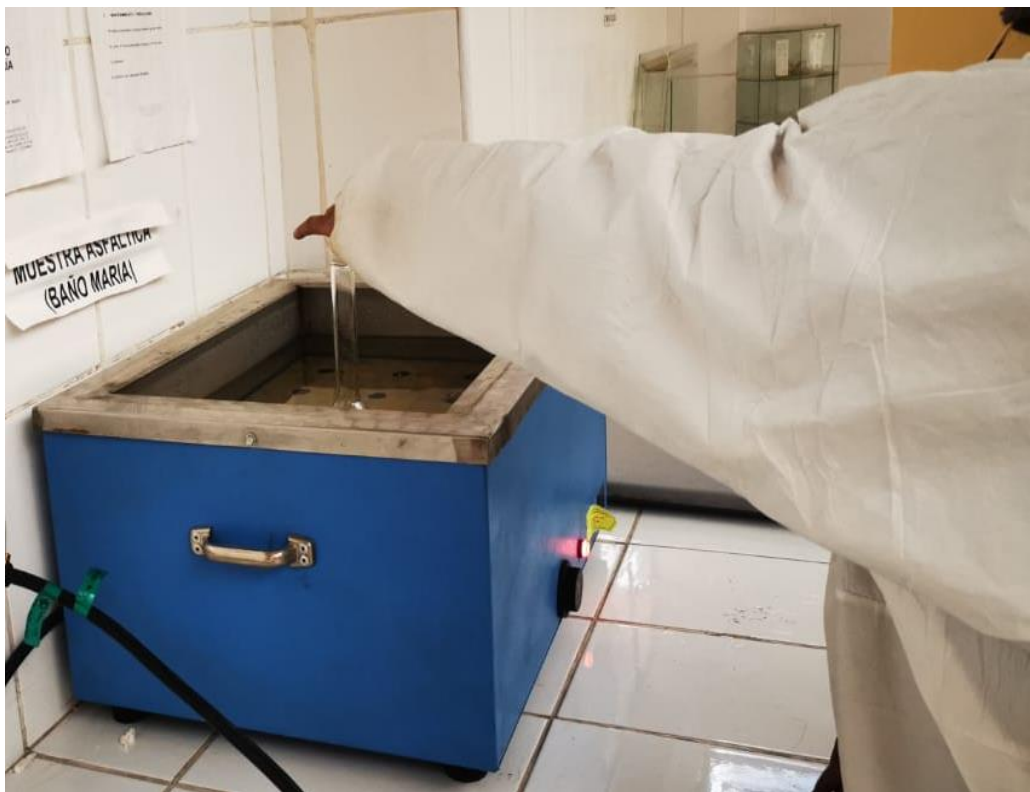
Fotografía 8. Determinación de la gravedad específica y absorción de los agregados
