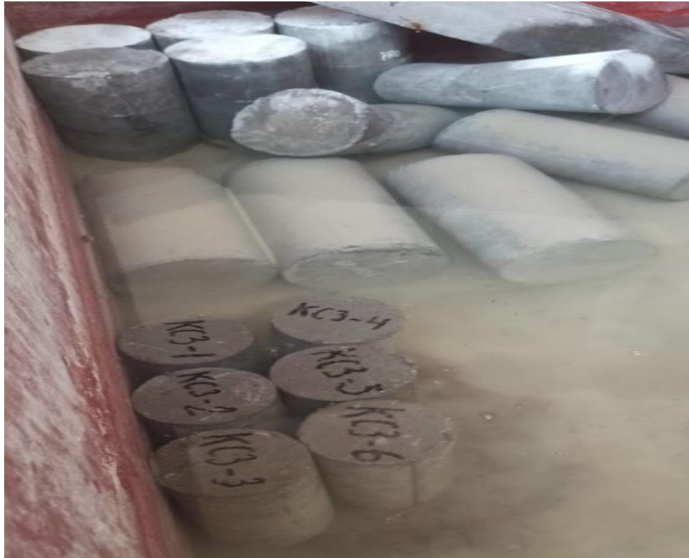
Fotografía 27. Curado de las probetas de concreto en 7, 14 y 28 días.
