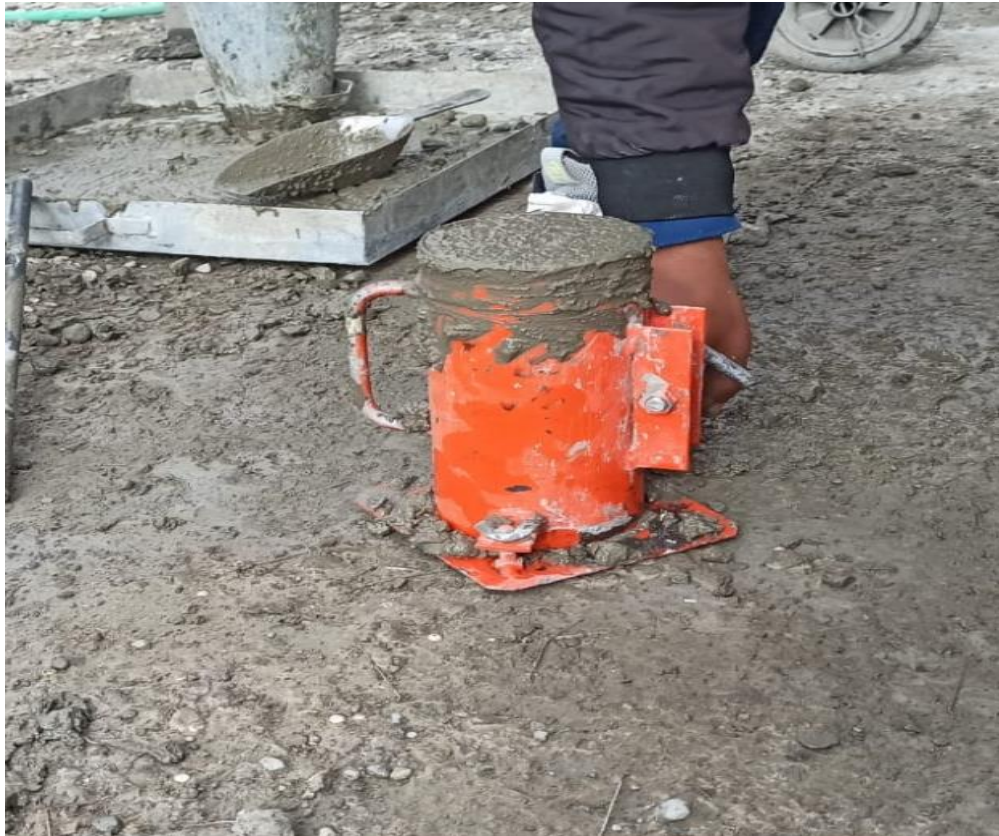
Fotografía 23. Enrase y limpieza final de las probetas de concreto
