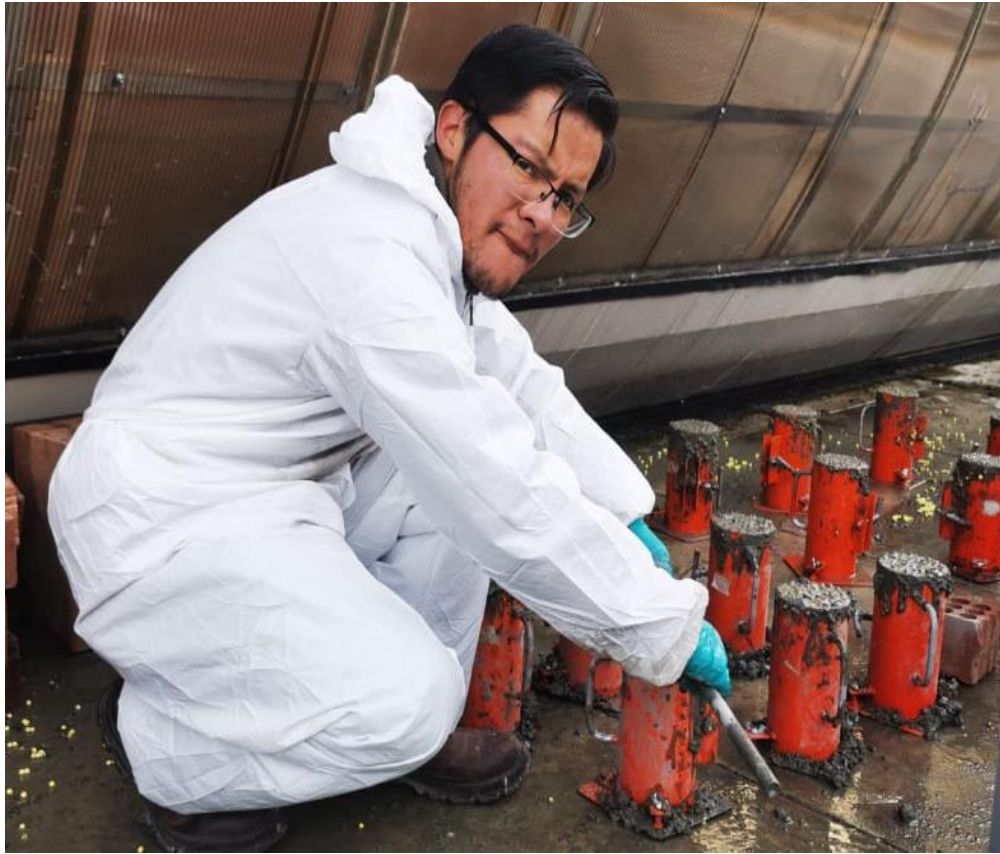
Fotografía 21. Elaboración de Probetas de concreto ASTM C31 (Método ACI).
