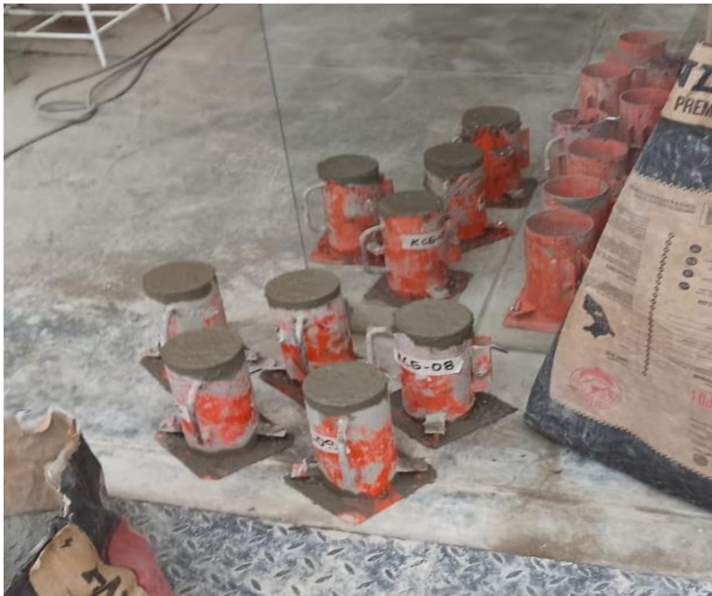
Fotografía 24. Probetas de concreto, clasificados según los patrones de diseño.
