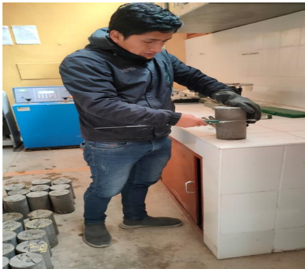
Fotografía 28. Toma de las dimensiones de las probetas para ser ensayadas.
