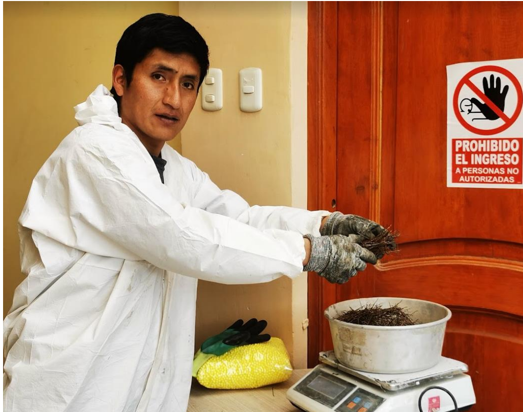
Fotografía 9. Dosificación de fibras de acero 3D para nuestro concreto.
