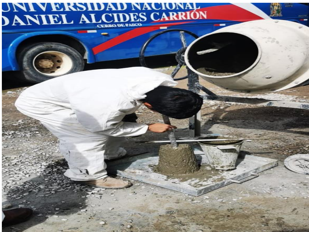
Fotografía 16. Verificación del SLUMP de concreto con el método de Cono de Abrams, verificándose que se tiene una medida máxima de 3''- 4'''.
