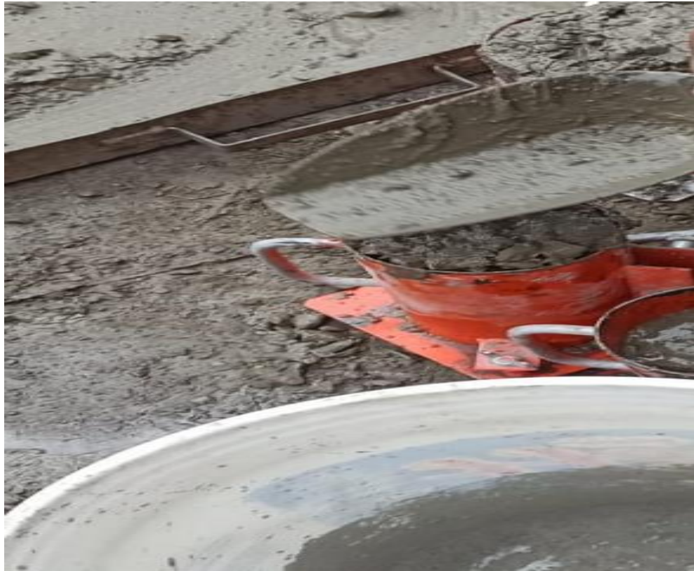
Fotografía 17. Elaboración de Probetas de concreto ASTM C31 (Método ACI).
