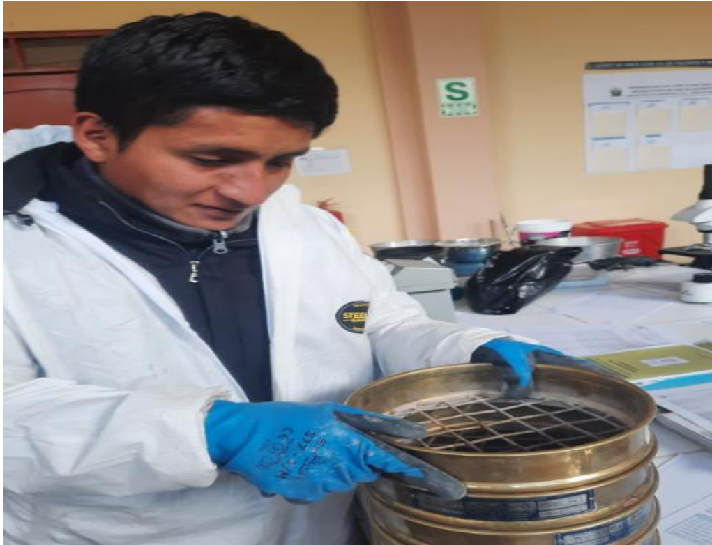
Fotografía 5. Método de prueba para el análisis granulométrico de agregados finos y gruesos.
