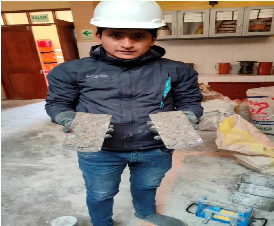
Fotografía 39. Verificación tipo de corte en el ensayo resistencia a la tracción indirecta de los testigos.
