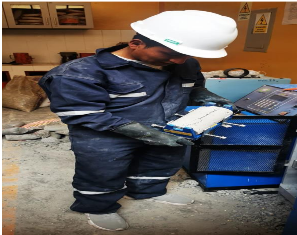
Fotografía 38. Verificación tipo de corte en el ensayo resistencia a la tracción indirecta de los testigos.
