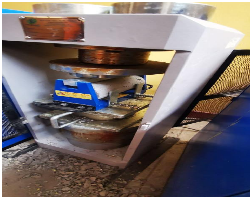
Fotografía 32. Se aprecia el ensayo a la Tracción indirecta de los testigos de concreto.
