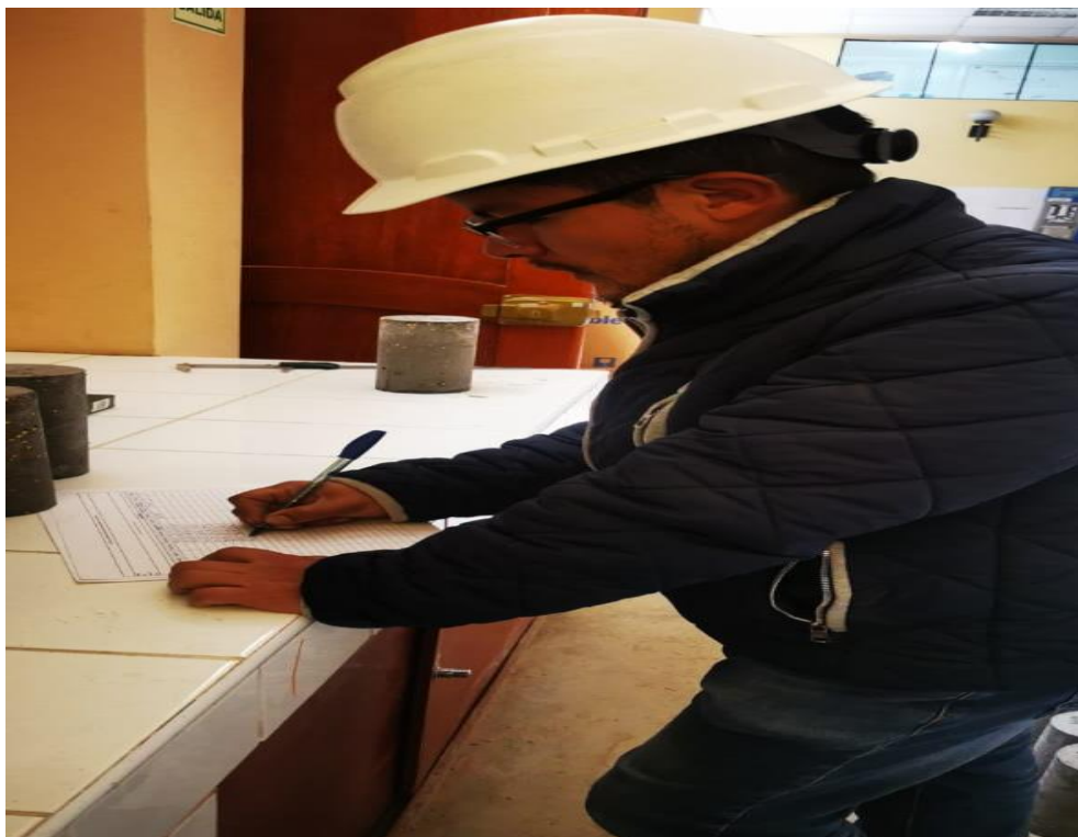
Fotografía 30. Toma de datos de los testigos de concreto en el proceso de ensayado.
