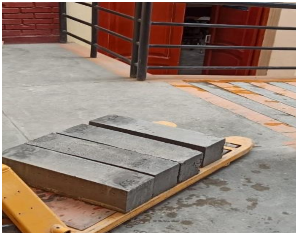
Fotografía 26. Se aprecia las vigas desencofradas para ser ensayadas por el método de flexión.
