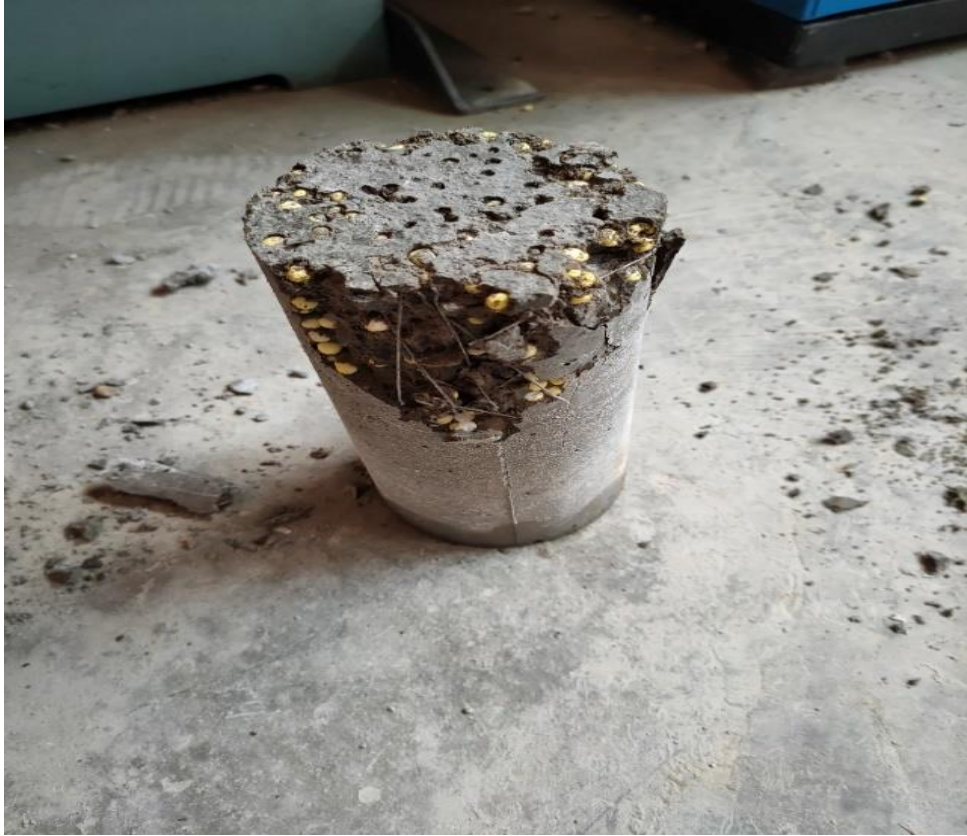
Fotografía 41. Se aprecia la probeta ensayada a resistencia a la compresión.
