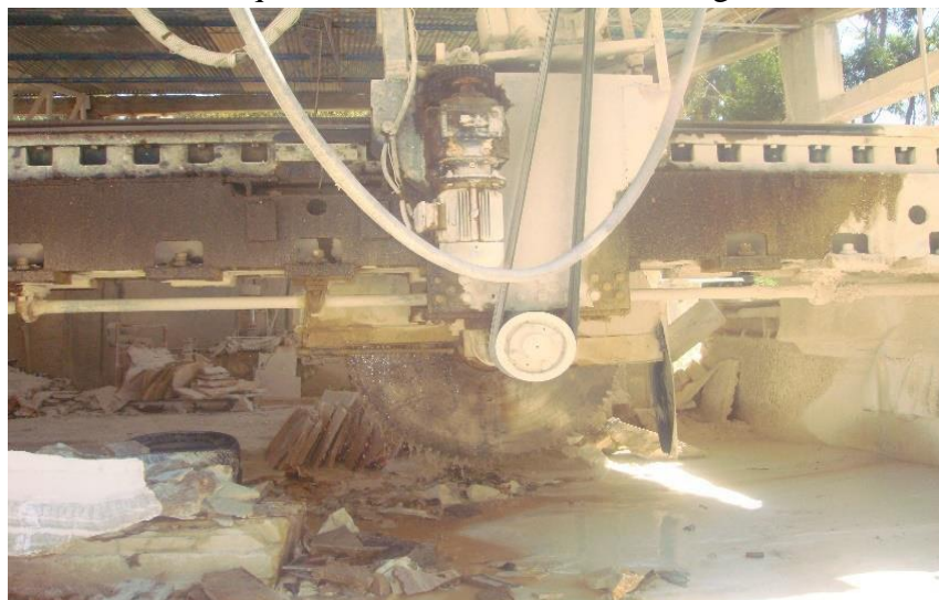
Foto 3. Máquina de corte hidráulico con riesgo eléctrico
