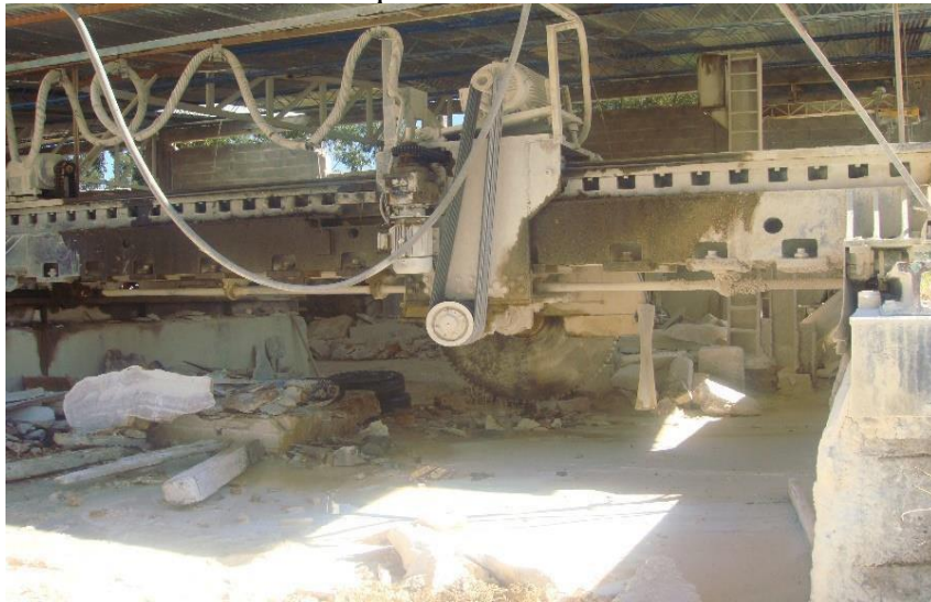
Foto 3. Máquina de corte hidráulico con riesgo eléctrico
