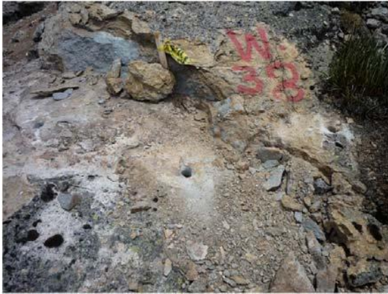
FOTO N° 1.- Método de muestreo mediante Pionjar. UTM: 309800 E, 8842953 N.
