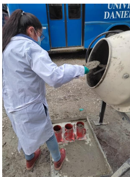
Fig. 12.- Fabricación de especímenes cilíndricos.
