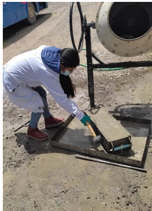
Fig. 18.- Liberación de los vacíos mediante golpe a lados exteriores.
