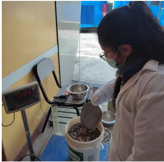
Fig.05.- Control de la dosificación del agregado RCD.
