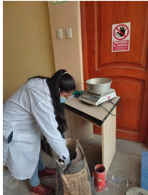
Fig. 08.- Control de la dosificación del cemento.
