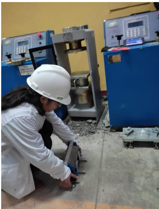
Fig. 29.- Colocación del espécimen al dispositivo de tensión.
