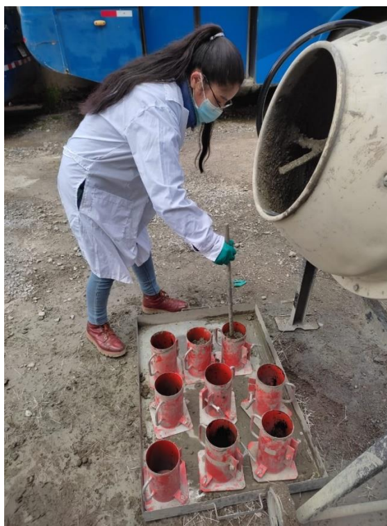
Fig. 13.- Compactación con el método del varillado.
