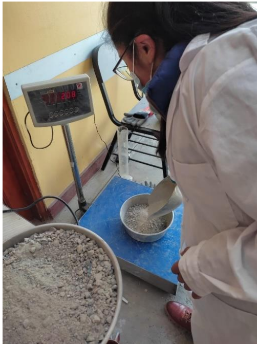
Fig.07.- Control de la dosificación del agregado.
