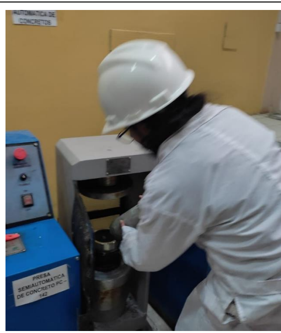
Fig. 24.- Colocación de probetas en la máquina para el ensayo de compresión.
