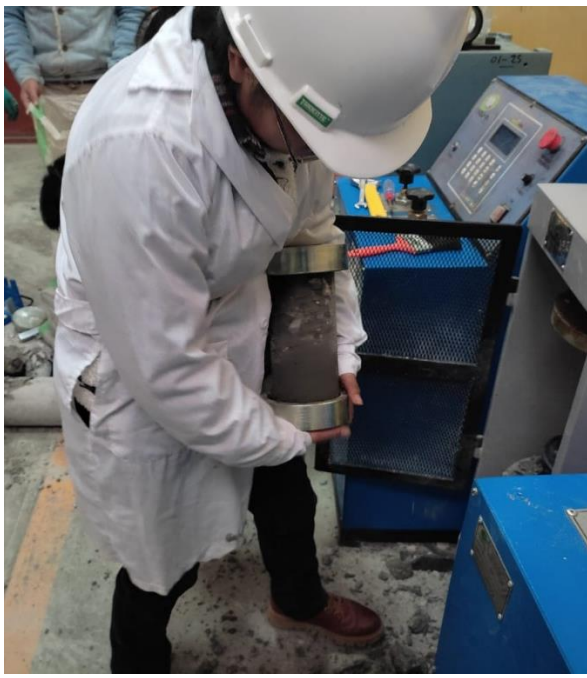
Fig. 27.- Extracción del espécimen para verificación de falla.
