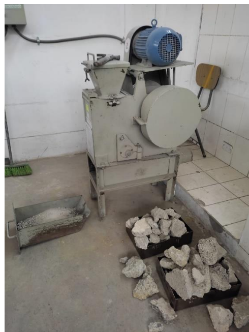
Fig. 03.- Trituración y cribado del RCD.
