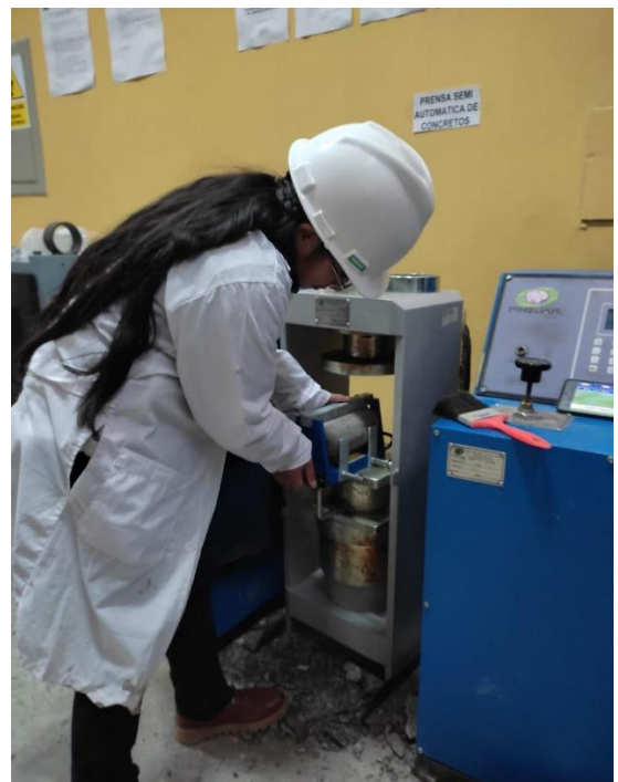
Fig. 30.- Colocación a la maquina digital para el ensayo.
