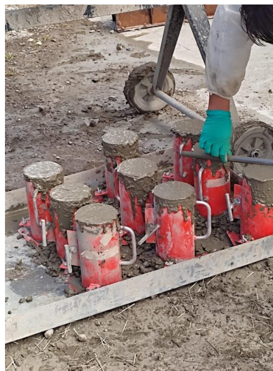
Fig. 12.- Fabricación de especímenes cilíndricos.
