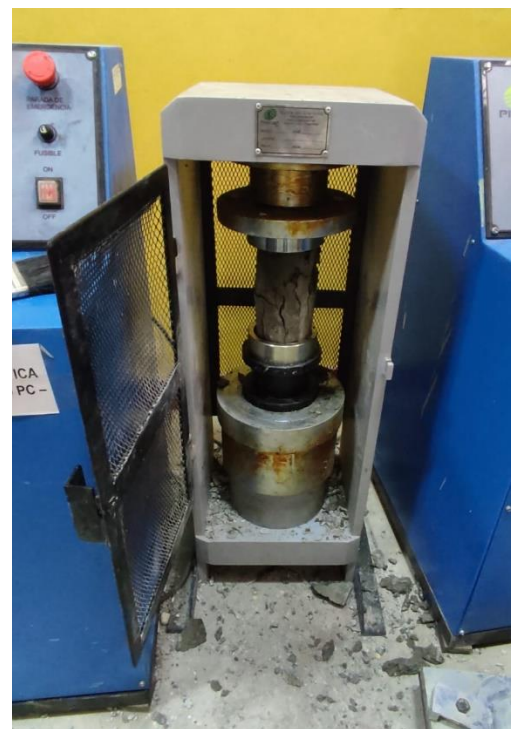
Fig. 26.- Ensayo a la compresión.
