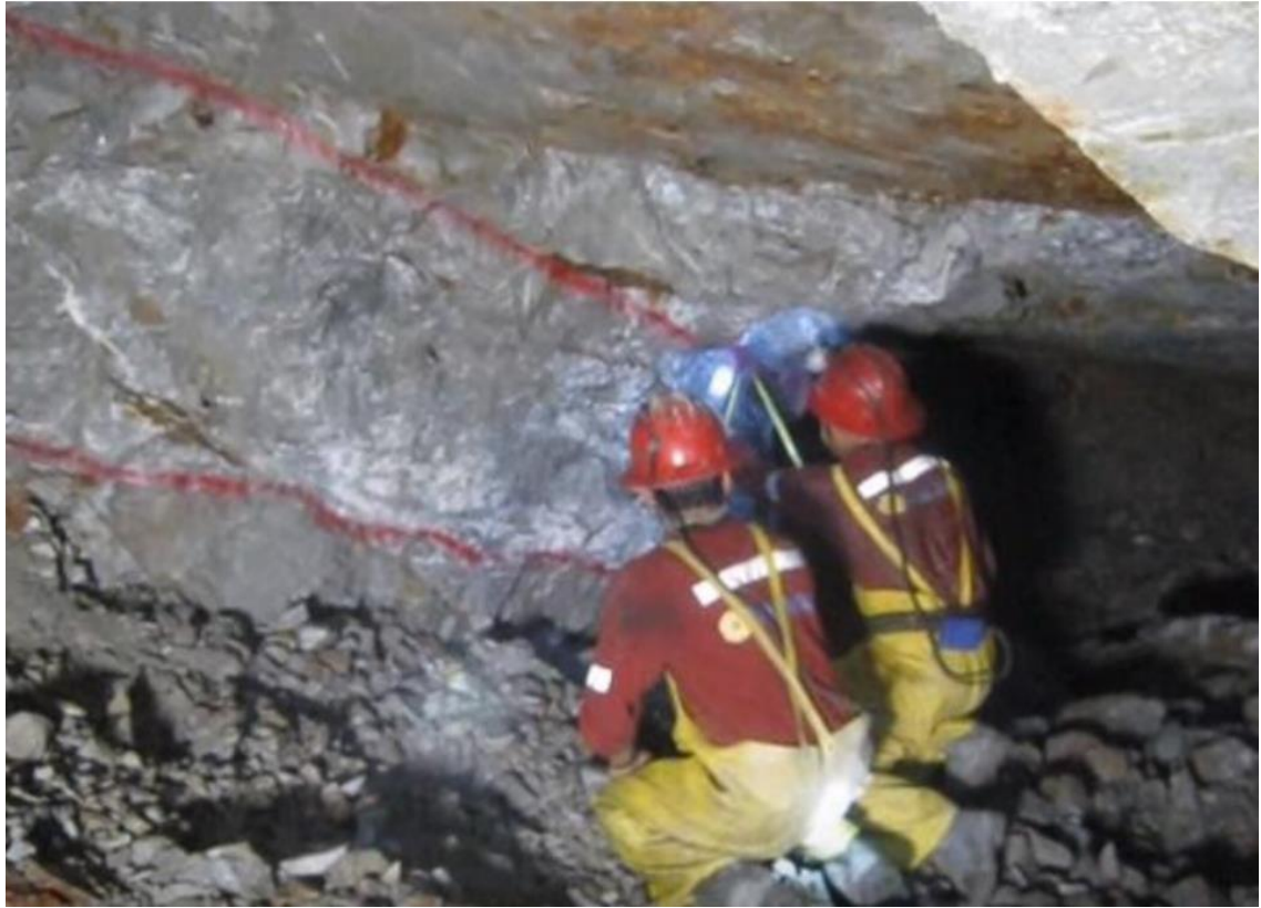
Figura 36. Pintado y señalización de vetas angostas Fuente: Departamento de Geología de la Mina Casapalca
