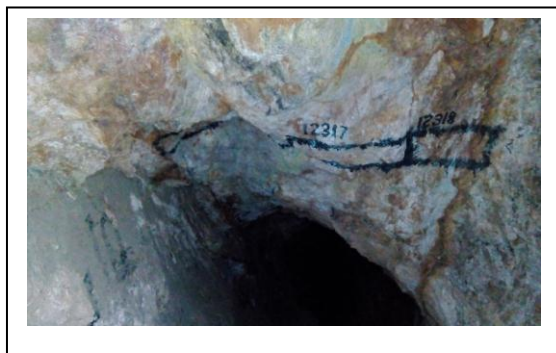
Foto1,2: Veta Colorada Niv. 1000, a) Nótese el plano de falla, en contacto con min mixtos de sulfuros y óxidos. Pátinas de malaquita, limonitas, goetita. b) Gossan poroso con fuerte impregnación de limonita indígena “palillado” en una matriz de cuarzo gris y caolín (M. 10916: ley 1.4 OzAu).
