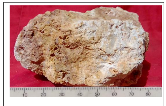
Foto1,2: Veta Colorada Niv. 1000, a) Nótese el plano de falla, en contacto con min mixtos de sulfuros y óxidos. Pátinas de malaquita, limonitas, goetita. b) Gossan poroso con fuerte impregnación de limonita indígena “palillado” en una matriz de cuarzo gris y caolín (M. 10916: ley 1.4 OzAu).
