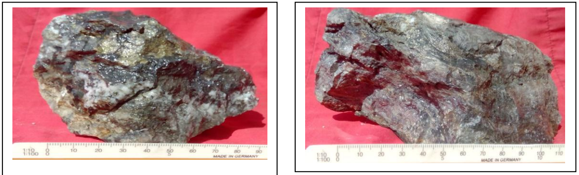
Foto 5,6: a) Veta Colorada Nótese los flujos de sulfuros de con pirita, pirrotita, marmatita, galena, puntos de calcopirita en una matriz de cuarzo gris. ,marmatita, pirrotita, pirita ,calcopirita (M: 10803 ley 3.9 Oz Au.). a) Veta Raquel sulfuros masivos textura brechada y laminada con esfalerita, galena, venillas de calcopirita, en una matriz de pirrotita, pirita y cuarzo gris.
