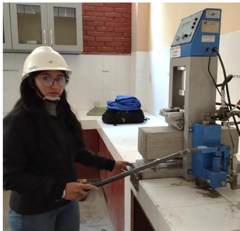
FOTOGRAFÍA N° 34: ENSAYO DE RESISTENCIA A LA TRACCIÓN
