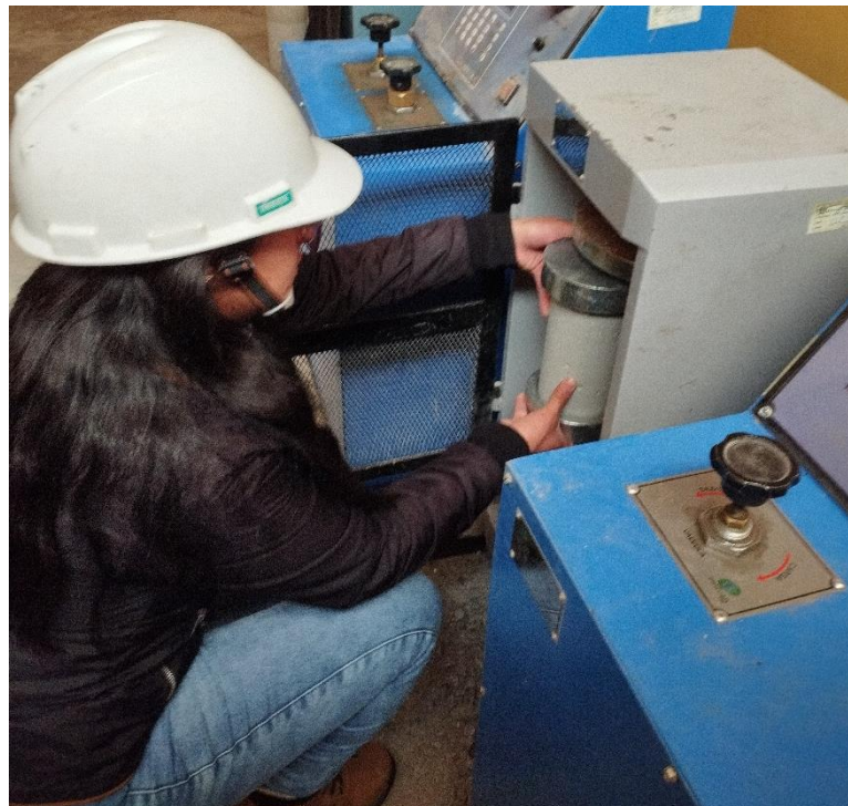
FOTOGRAFÍA N° 32: ENSAYO DE RESISTENCIA A LA COMPRESIÓN
