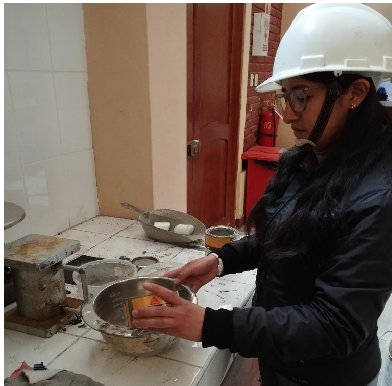
FOTOGRAFÍA N° 6: DOSIFICACIÓN DE ADITIVOS
