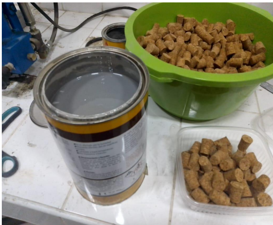
FOTOGRAFÍA N° 8: MEZCLA DE ADITIVO CON CORCHO
