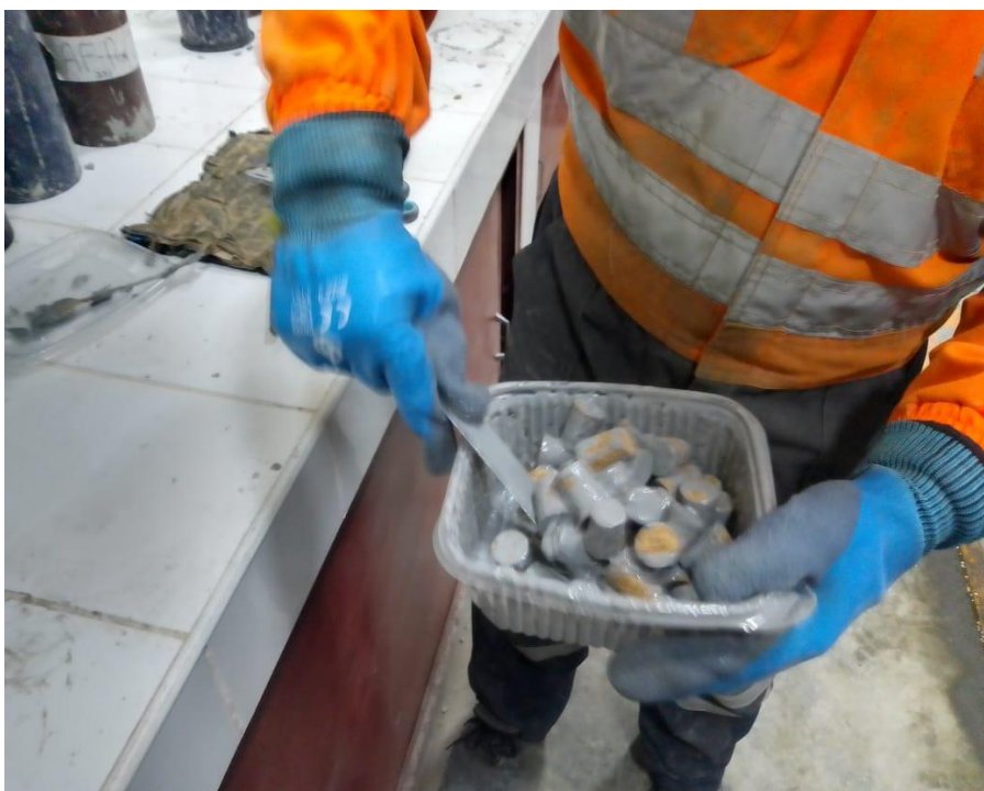
FOTOGRAFÍA N° 8: MEZCLA DE ADITIVO CON CORCHO
