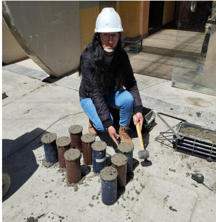
FOTOGRAFÍA N° 23: ELIMINACIÓN DE AIRE
