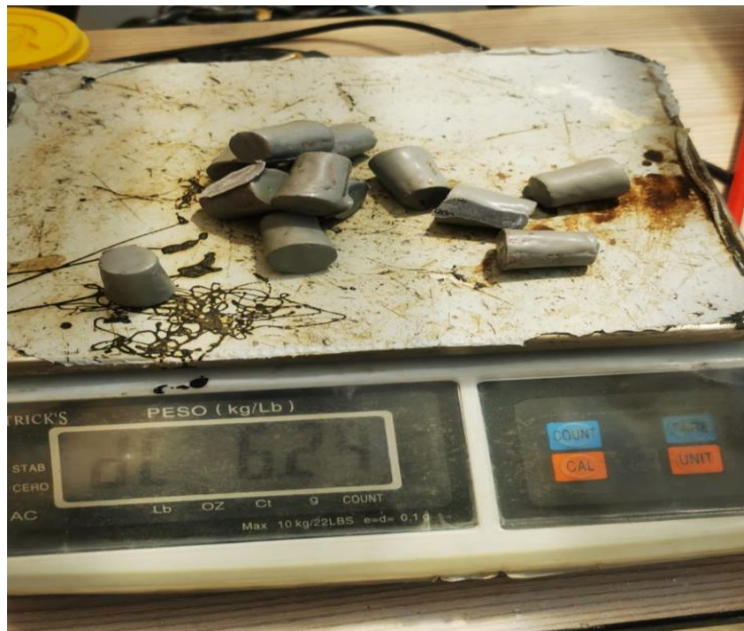
FOTOGRAFÍA N° 12: MUESTRA DE CORCHO ENDURECIDO
