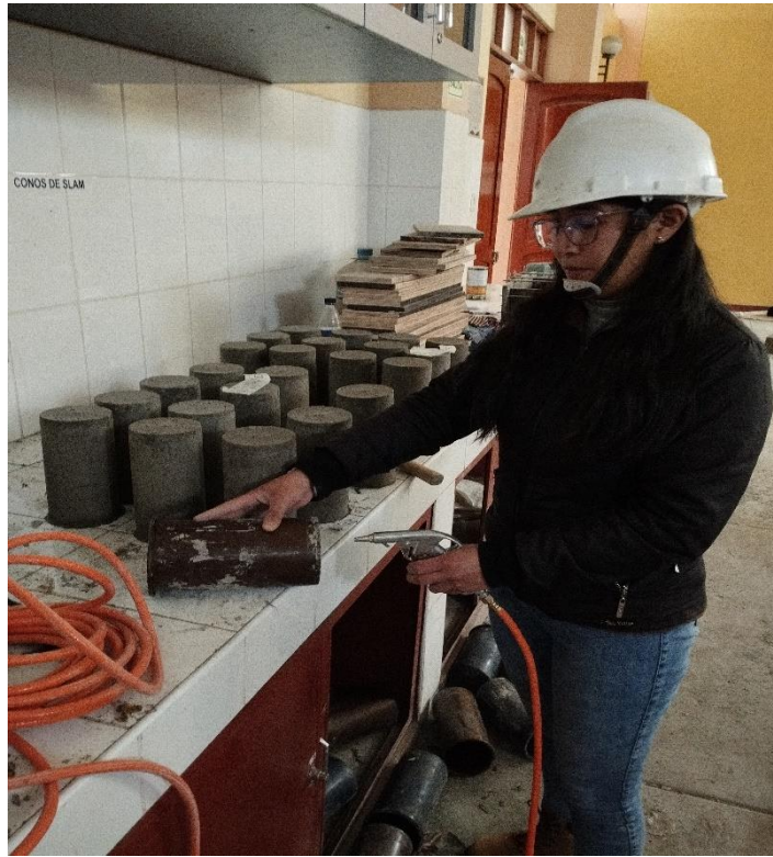
FOTOGRAFÍA N° 27: DESENCOFRADO DE MOLDE CILÍNDRICO
