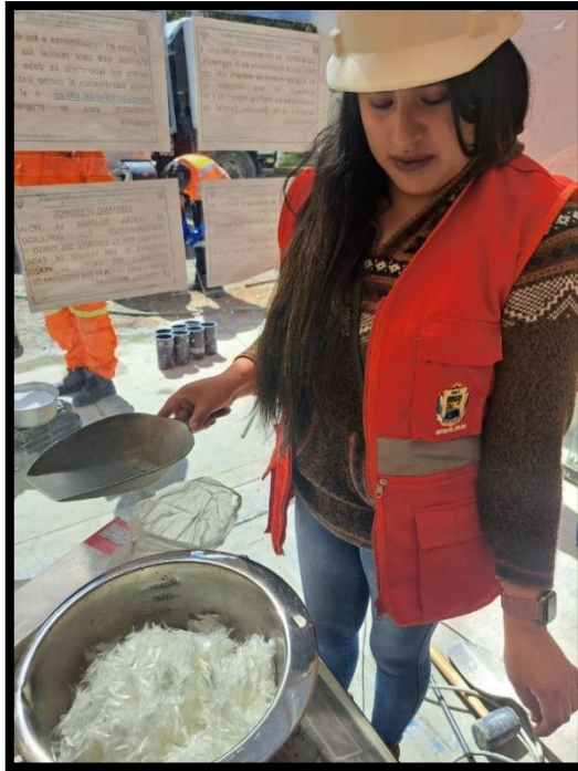
Fotografía 5.- Tara de recipiente y peso de microfibra en distintos porcentajes planteados
