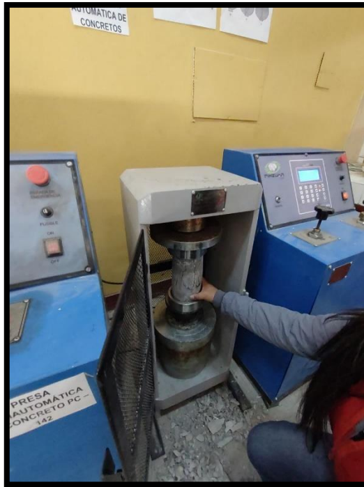
Fotografía 31.- Verificando el tipo de falla producido
