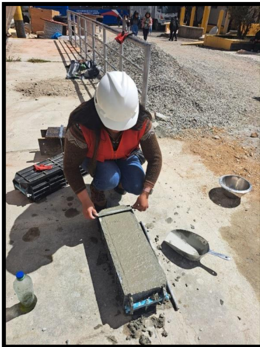
Fotografía 20.- Enrasado de la superficie de la viga
