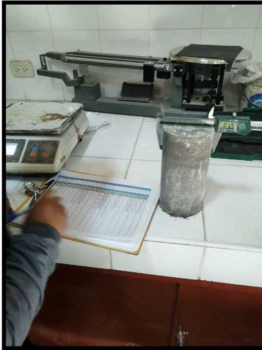
Fotografía 33.- Toma de nota de las resistencias obtenidas y tipos de fallo
