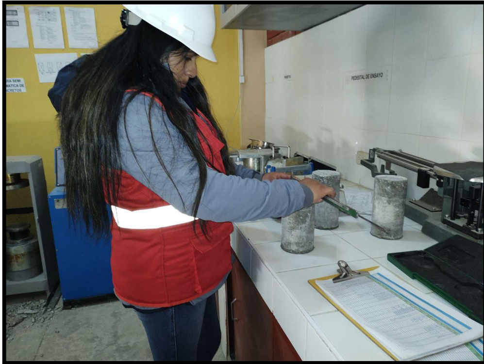
Fotografía 23.- Medida de diámetros de las probetas
