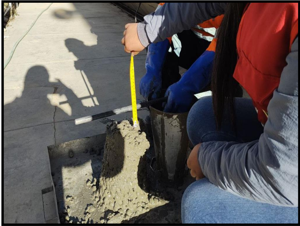
Fotografía 15.- Medida del slump obtenido del ensayo
