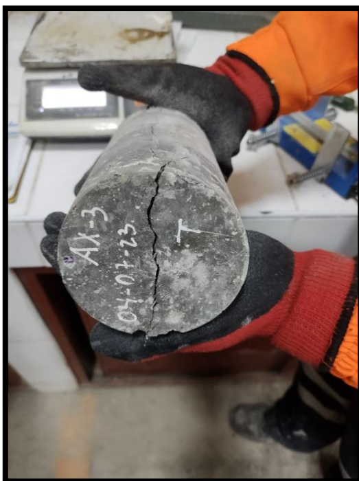
Fotografía 35.- Vista del fallo obtenido del ensayo a Tracción Indirecta de la muestra de código AX-3
