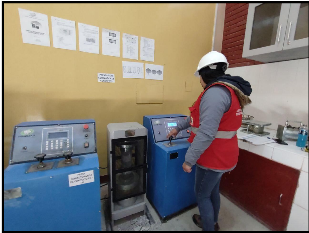
Fotografía 29.- Regulando la velocidad de rotura de la probeta según normativa
