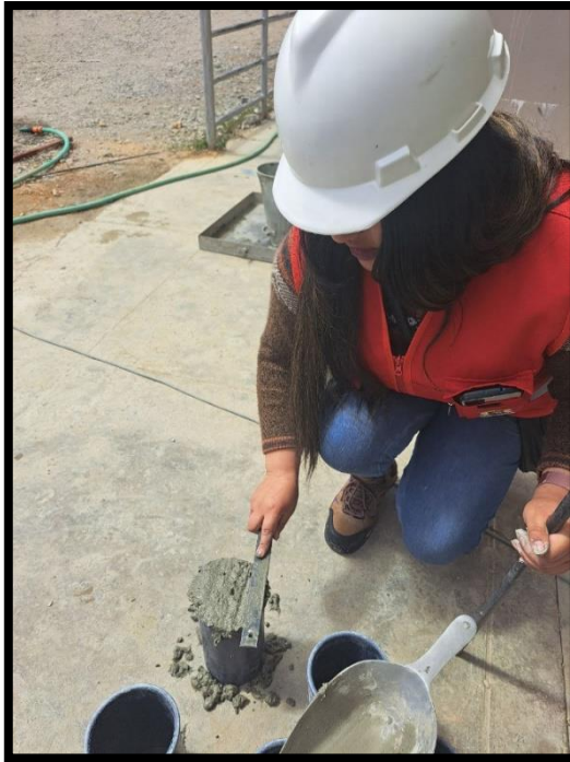
Fotografía 21.- Enrasado de probetas
