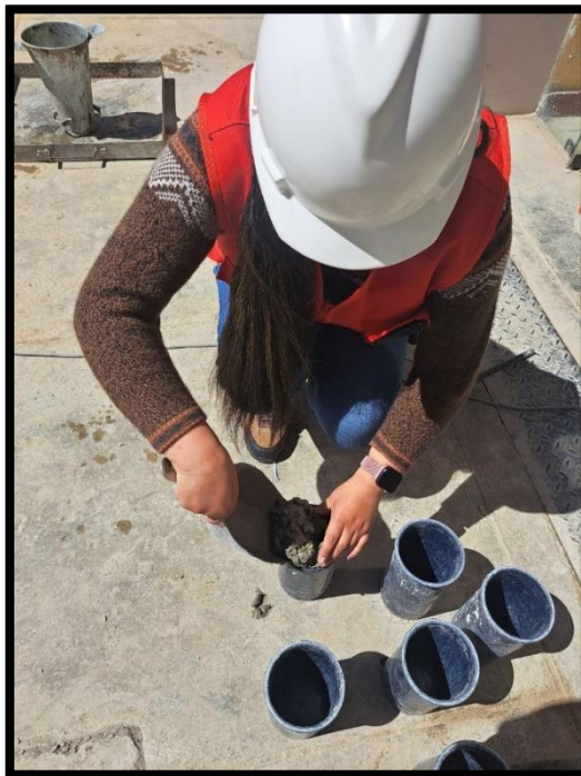
Fotografía 16.- Llenado en tres capas de las probetas
