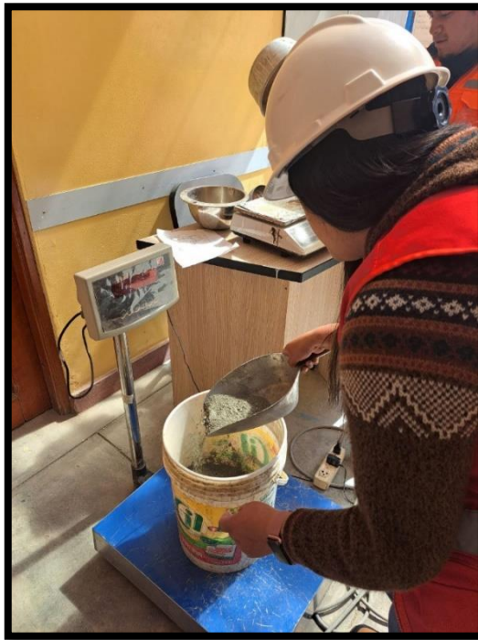
Fotografía 1.- Pesando el cemento según el diseño de mezcla
