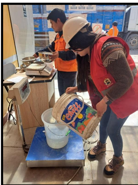
Fotografía 4.- Pesando el agua según el diseño de mezcla
