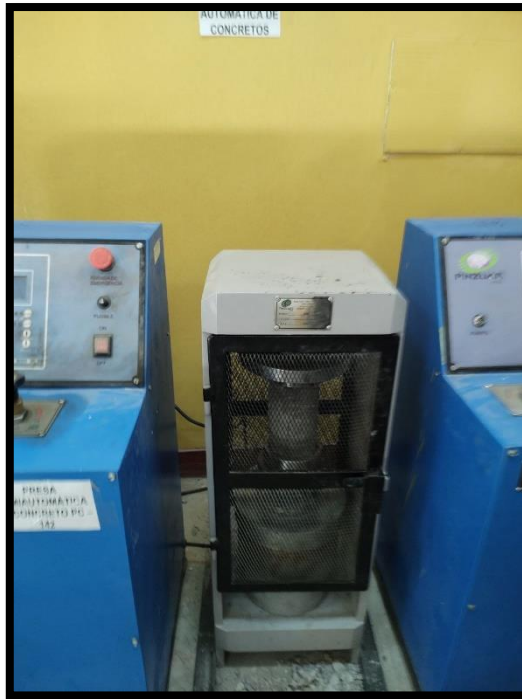
Fotografía 27.- Colocación de la probeta dentro de la prensa para el ensayo a compresión
