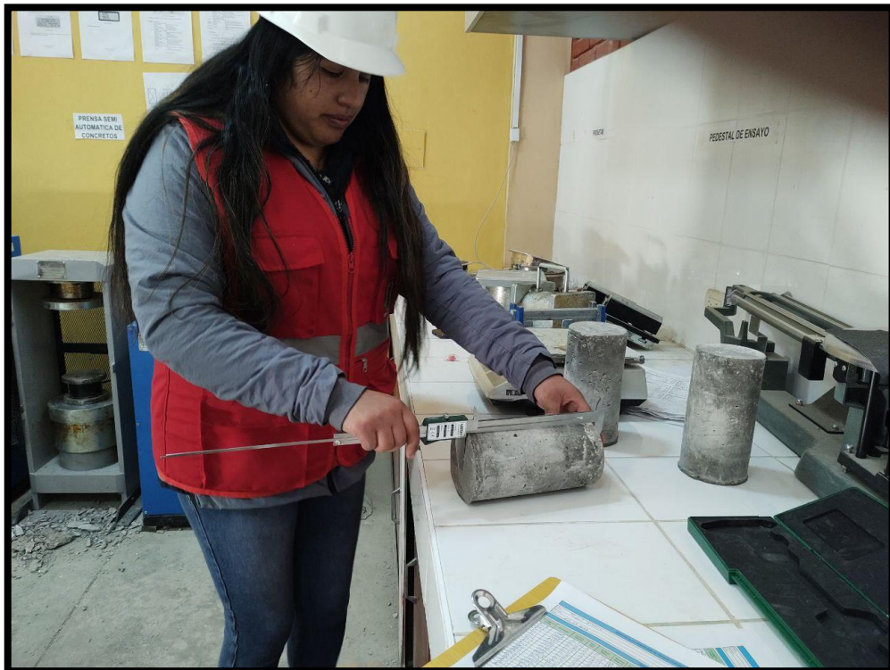
Fotografía 24.- Medida de altura de las probetas
