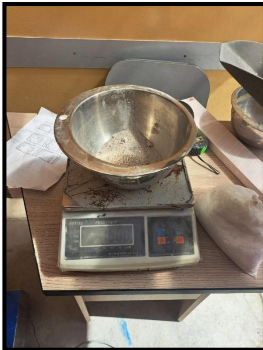
Fotografía 6.- Tara de recipiente y peso de la ceniza de calcinación en distintos porcentajes planteados
