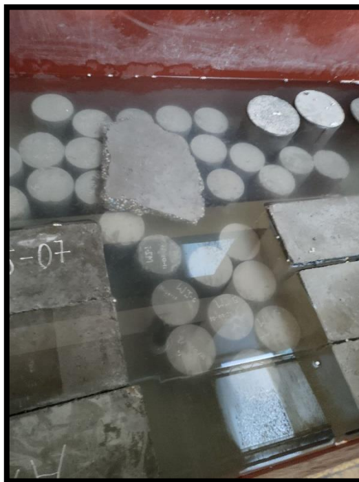
Fotografía 22.- Probetas colocadas en el pozo de curado
