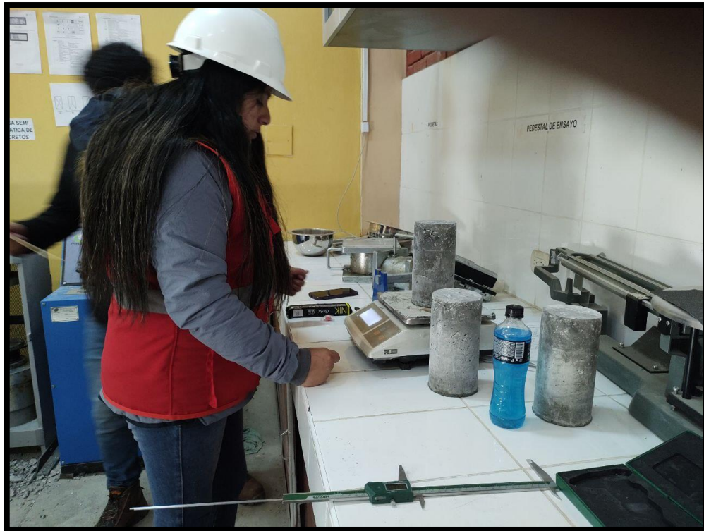
Fotografía 25.- Obteniendo el peso de las probetas a ser ensayadas
