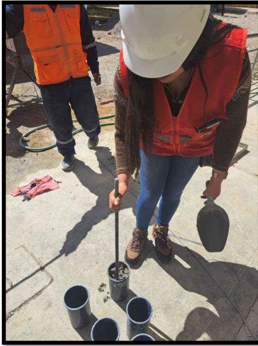
Fotografía 17.- Varillado del concreto en las probetas para su correcta compactación
