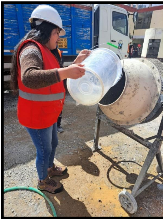
Fotografía 8.- Comienzo de mezclado con el 10% del agua
