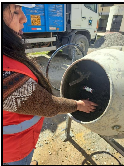
Fotografía 13.- Toma de medida de la temperatura del concreto
