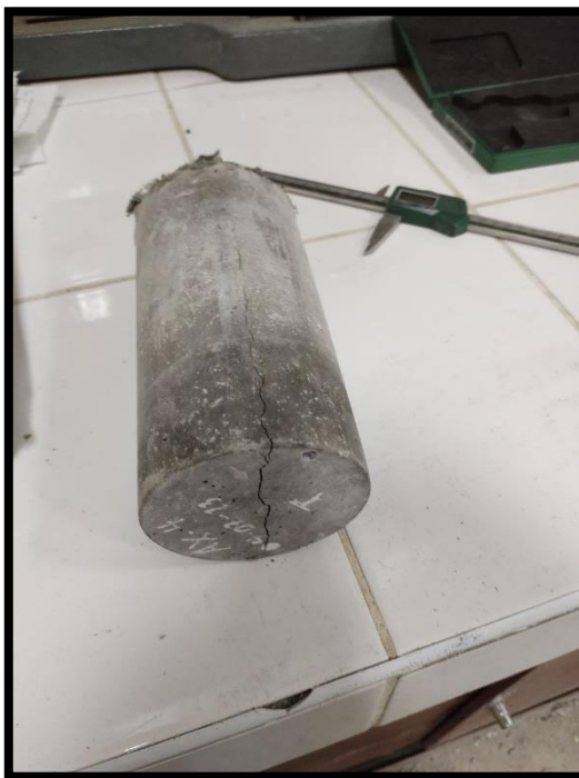
Fotografía 34.- Vista del fallo obtenido del ensayo a Tracción Indirecta de la muestra de código AX-4
