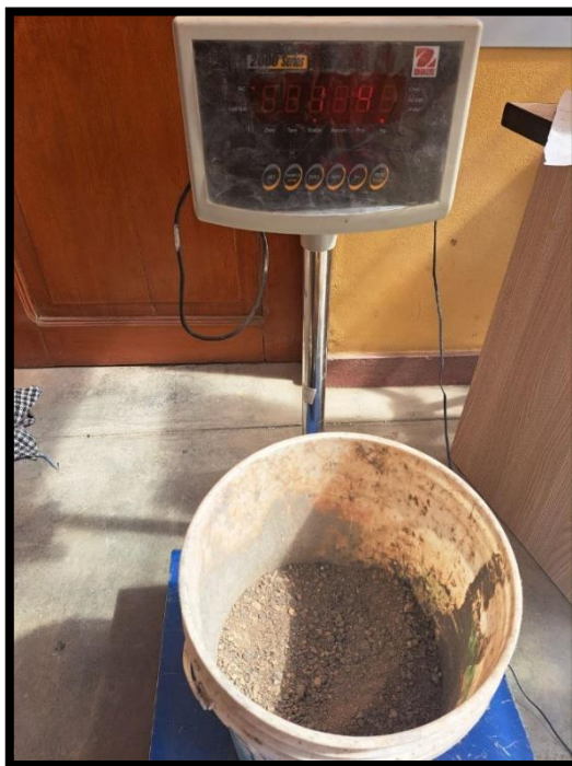
Fotografía 2.- Pesando el agregado fino según el diseño de mezcla
