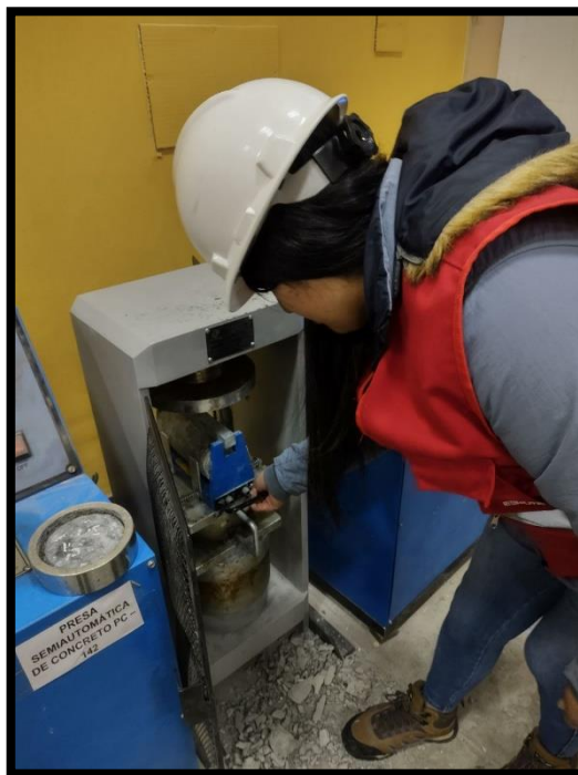
Fotografía 32.- Colocación de la muestra sometida al ensayo de Tracción Indirecta dentro de la prensa
