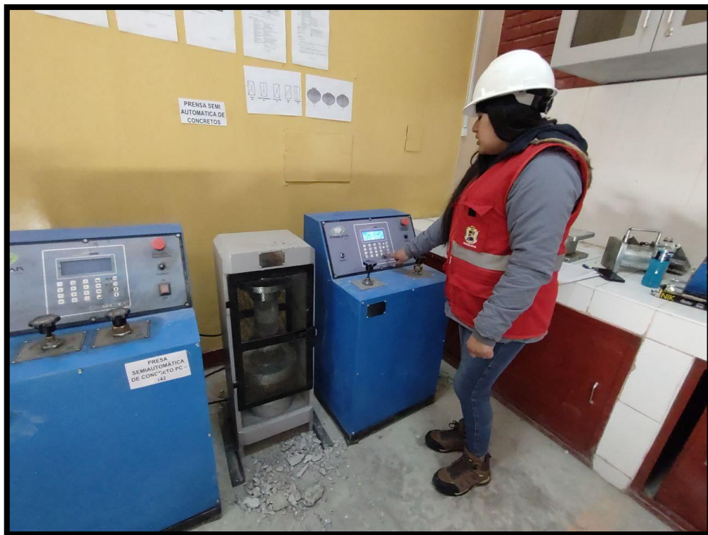
Fotografía 28.- Configuración de la prensa para el ensayo a compresión
