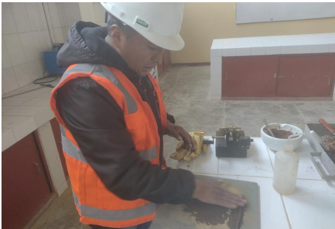
Imagen 14. Mesclamos 20 g de material con agua y lo amasamos para realizar rollitos de aproximadamente 3mm de diámetro para determinar el límite plástico.
