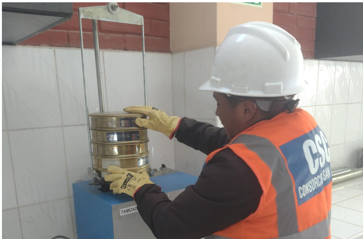
Imagen 10. Llevamos el material al agitador mecánico para evaluar su granulometría por tamizado.
