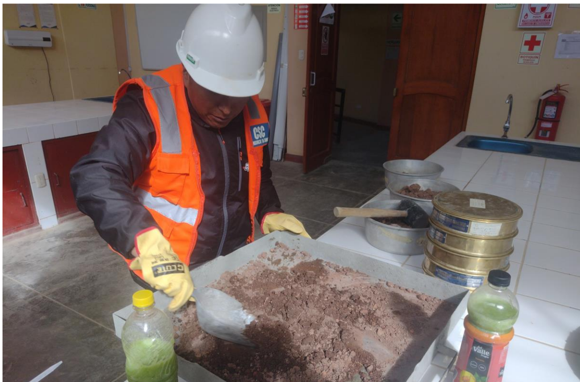
Imagen 20. Realizamos la mezcla uniforme para hacer el ensayo del Proctor modificado.
