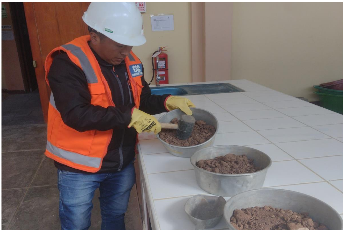
Imagen 5. Muestras del material extraídas de las calicatas en el área del proyecto a investigar R - 01, R - 02 y R - 03.
