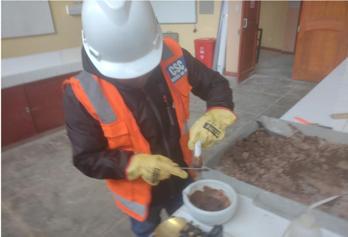
Imagen 11. Mesclamos el material que paso por el tamiz N° 40 con agua y adicionamos mucilago de penca de tuna para realizar el límite líquido.
