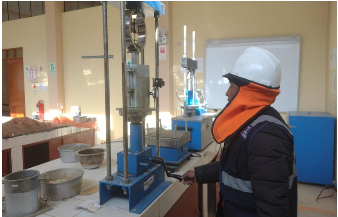
Imagen 25. Realizando el ensayo con la prensa CBR (relación de soporte californiana) -penetración.
