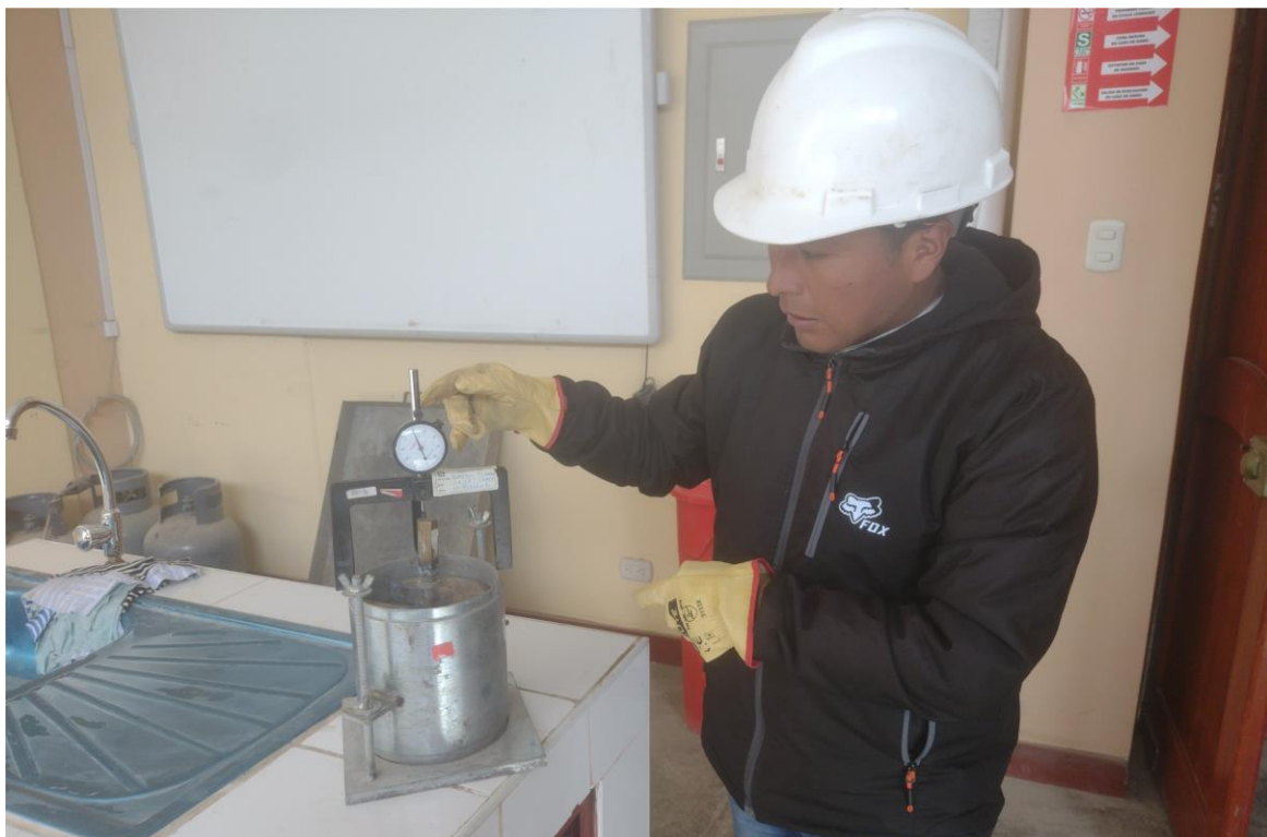
Imagen 24. Realizamos Ensayo de Relación de soporte de California CBR-Expansión.
