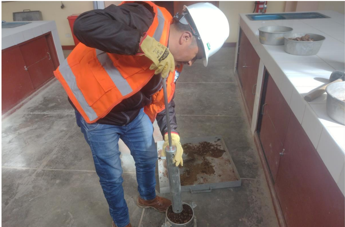
Imagen 21. Ensayo del Proctor modificado – compactación en 5 capas a cada 25 golpes.
