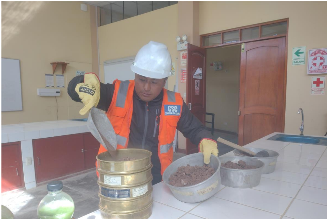
Imagen 9. Empezamos a colocar el material en los tamices.
