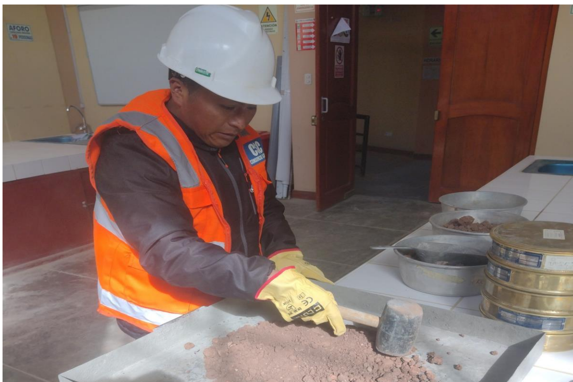
Imagen 7. Separación de partículas del material que esta unidas entre si con un martillo de hule.
