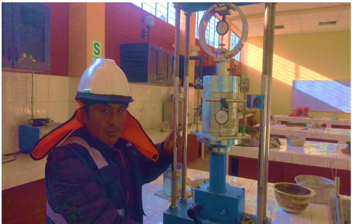
Imagen 26. Finalmente analizamos con la prensa CBR los cálculos de los discos.
