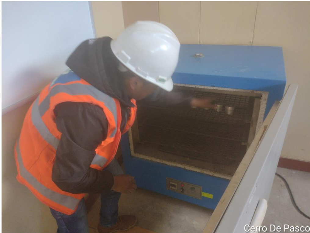
Imagen 13. Llenamos una porción de la muestra al recipiente pequeño de forma cilíndrica y lo llevamos al horno por 24 horas.
