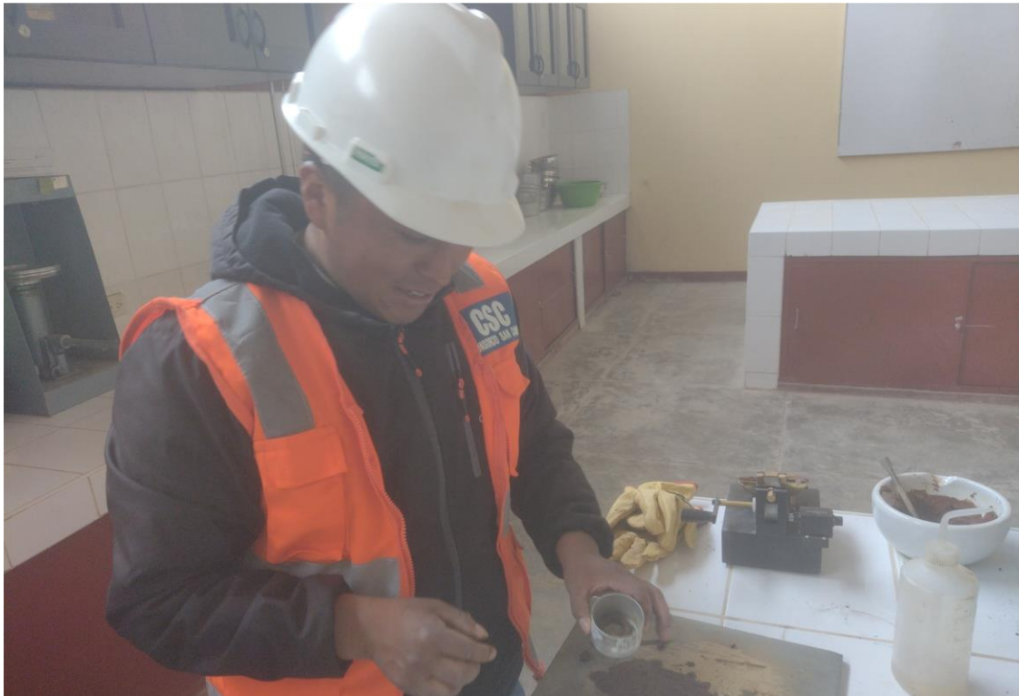
Imagen 15. Sacamos la muestra de esos rollitos de 3mm de diámetro al recipiente pequeño de forma cilíndrica.
