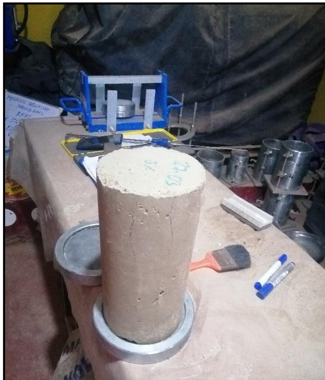
FOTOGRAFIA N°012: Vista del tipo de falla de las probetas de RFRC
