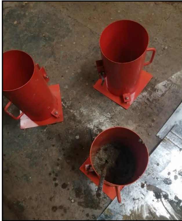
FOTOGRAFIA N°007: Vista de la elaboración de probetas de RFRC
