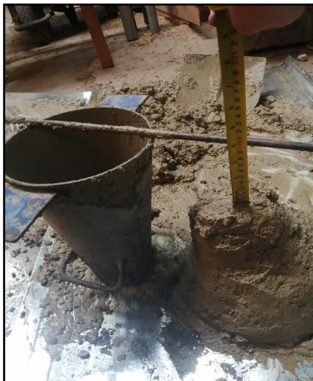
FOTOGRAFIA N°008: Vista de la prueba de revenimiento (Slump)
