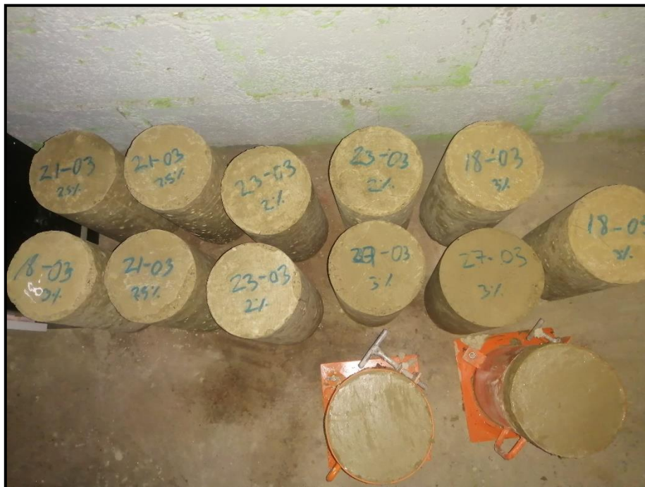
FOTOGRAFIA N°010: Vista de las probetas con distintos % cemento de RFRC
