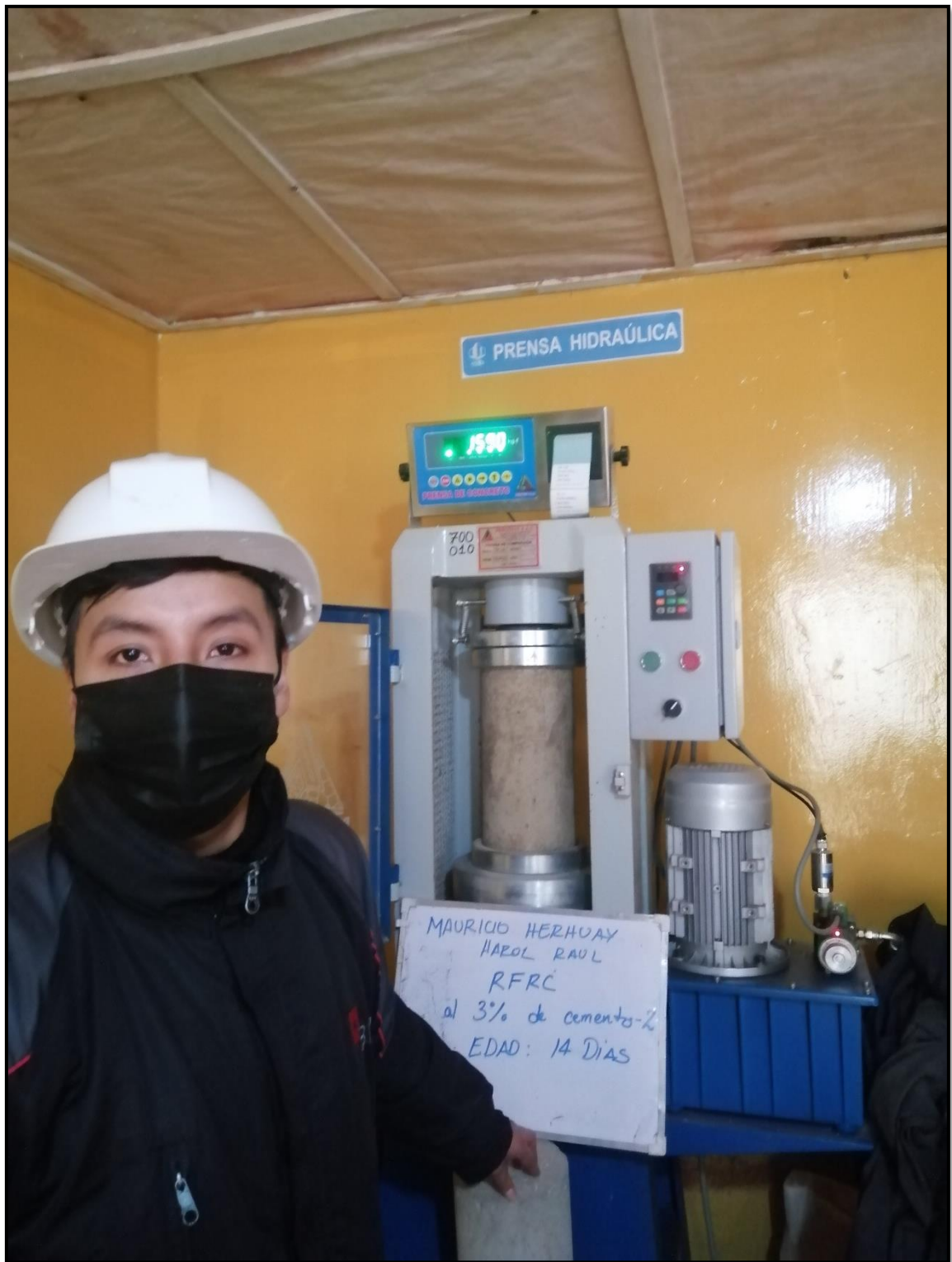
FOTOGRAFIA N°013: Vista realizando el ensayo a la compresión de las probetas de RFRC
