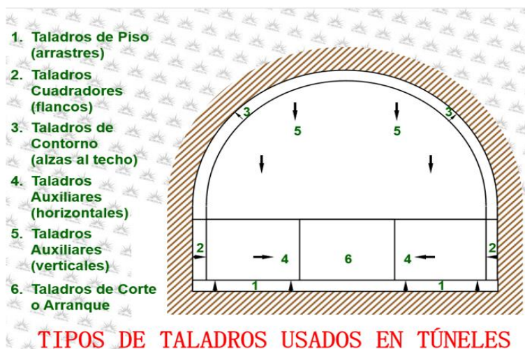
Tipos de taladros usados en túneles
