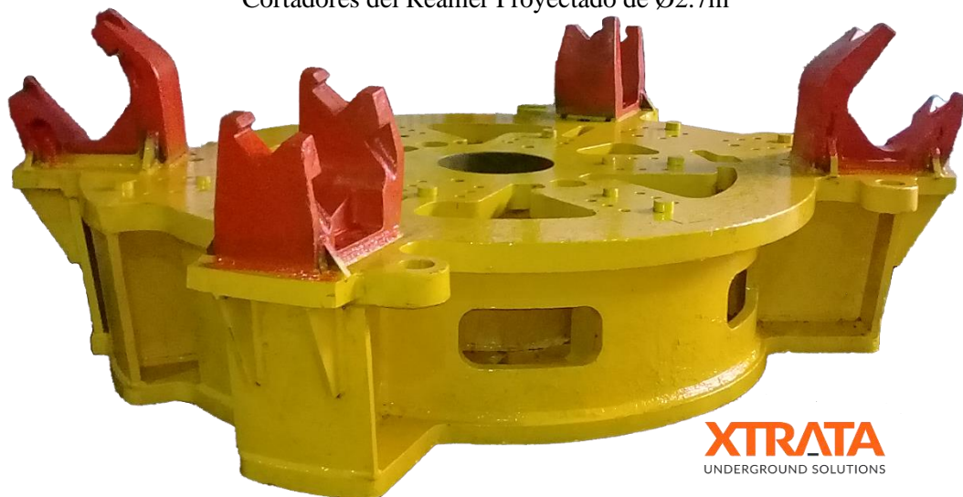
Figura 53. Expansión Reamer Existente de Ø2.4m – considerando Distribución de Cortadores del Reamer Proyectado de Ø2.7m
