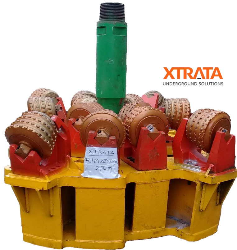
Figura 2. Reamer Proyectoado de \text{Ø}2.7\text{m} – Diámetro Admisible de Corte 2.727m - Dressing Distribución de Cortadores
