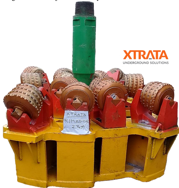
Figura 56. Montaje Reamer Proyectoado 2.727m – CMH
