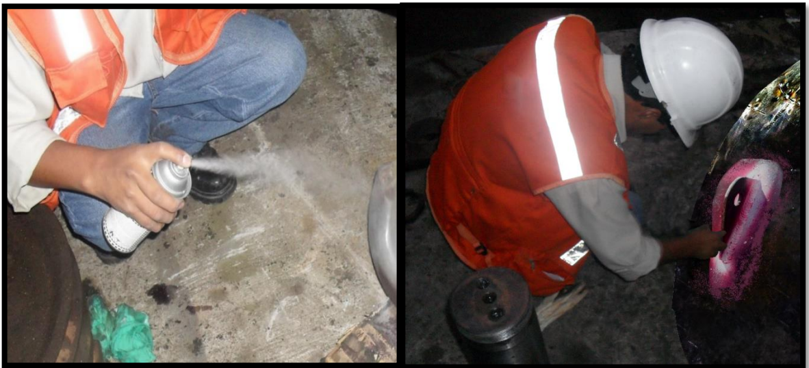
Gráfico 12: Inspección por líquidos penetrantes.
