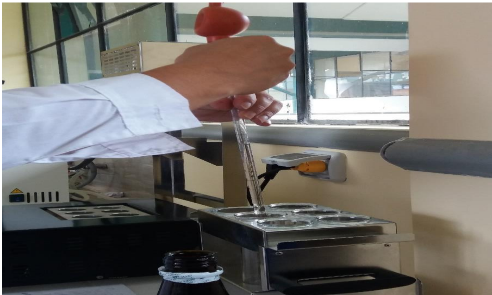
Foto 8. Adición de ácido sulfúrico con muestras en los crisoles del digestor
