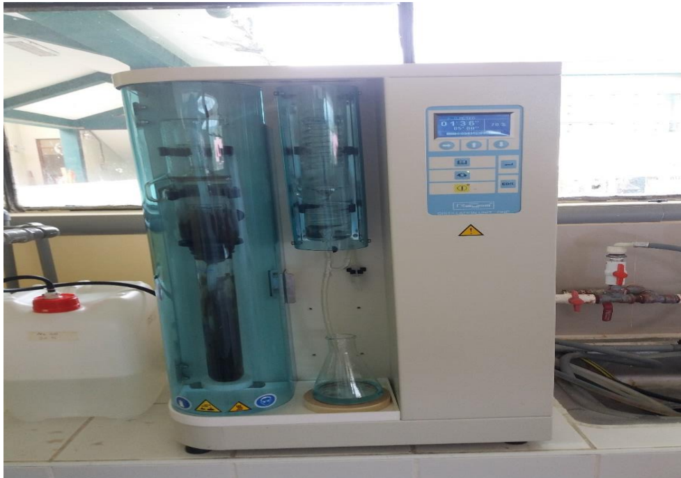
Foto 13. Tercera parte de destilación de la muestra
