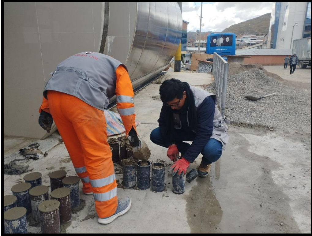
Fotografía 17.- Llenando y compactando las probetas con el concreto de cemento puzolánico
