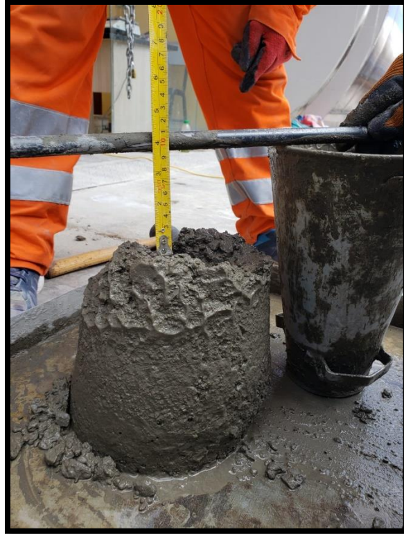
Fotografía 9.- Medida del slump del concreto con cemento tipo I
