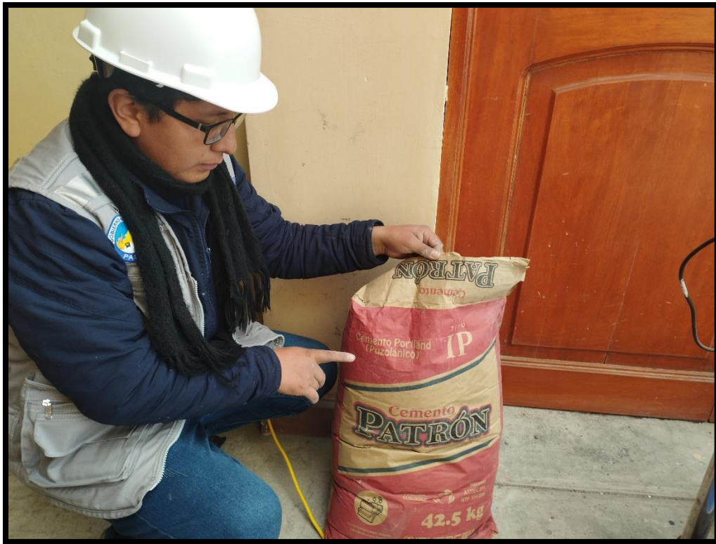
Fotografía 10.- Cemento puzolánico traído desde una región de la costa del Perú
