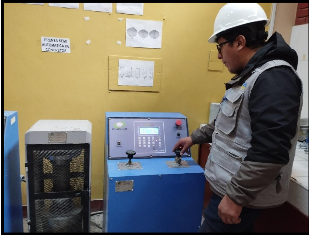
Fotografía 23.- Operando la prensa para el ensayo a compresión
