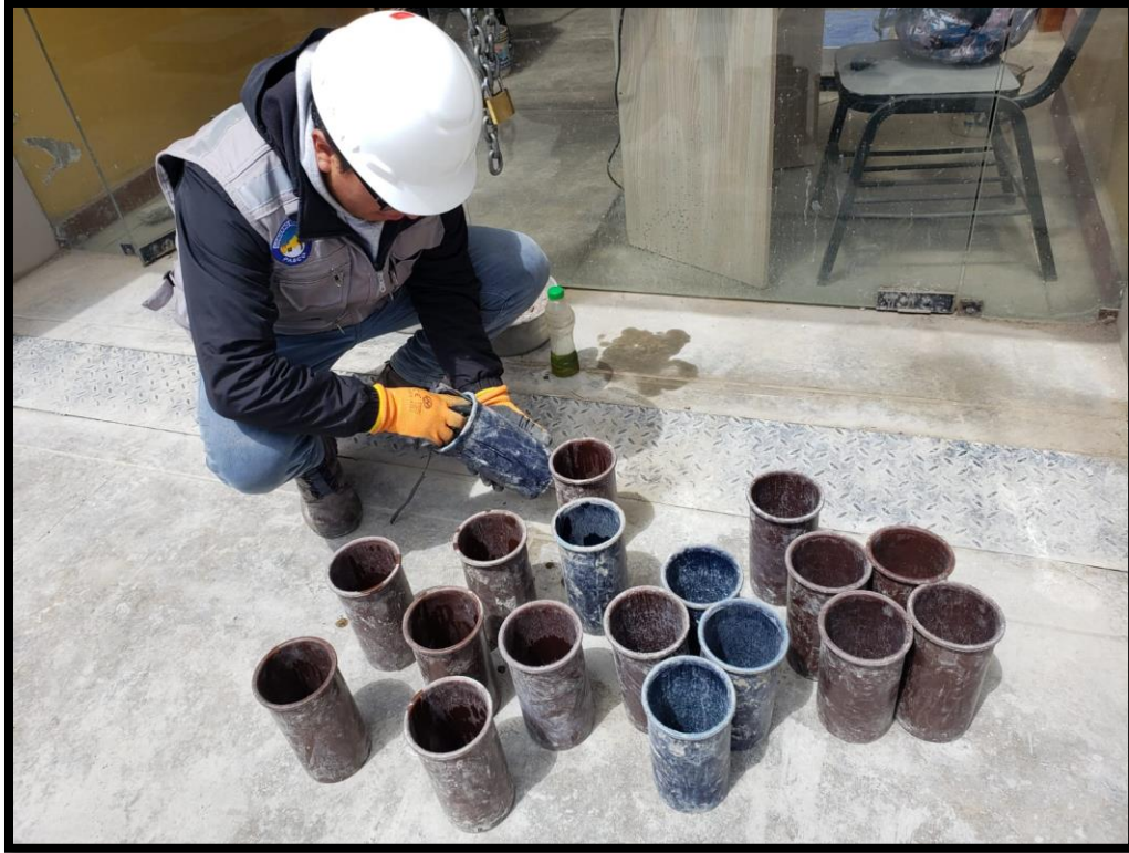
Fotografía 5.- Embadurnado de probetas con desmoldante
