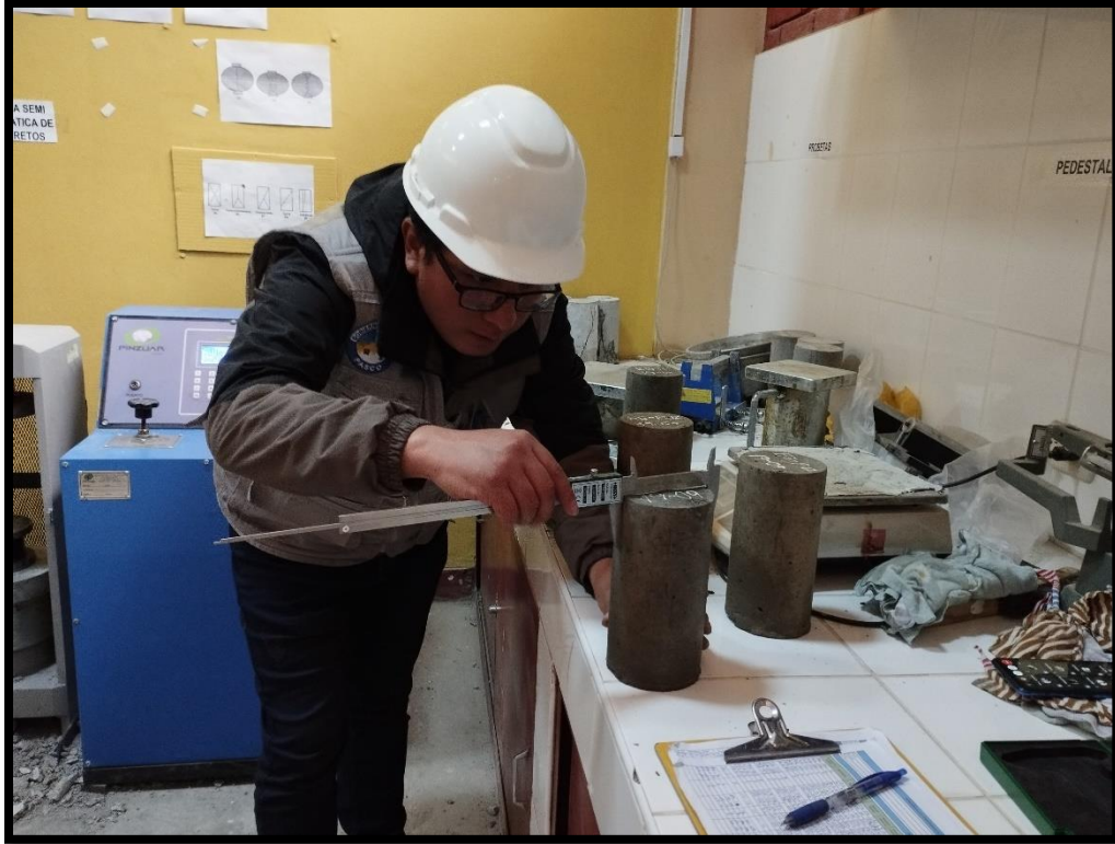
Fotografía 21.- Toma de medidas de diámetro de las probetas
