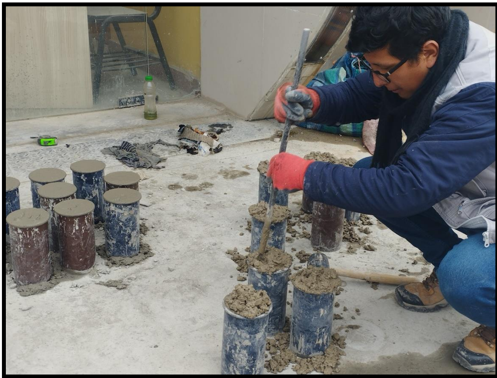
Fotografía 18.- Varillado para la compactación del concreto en las probetas
