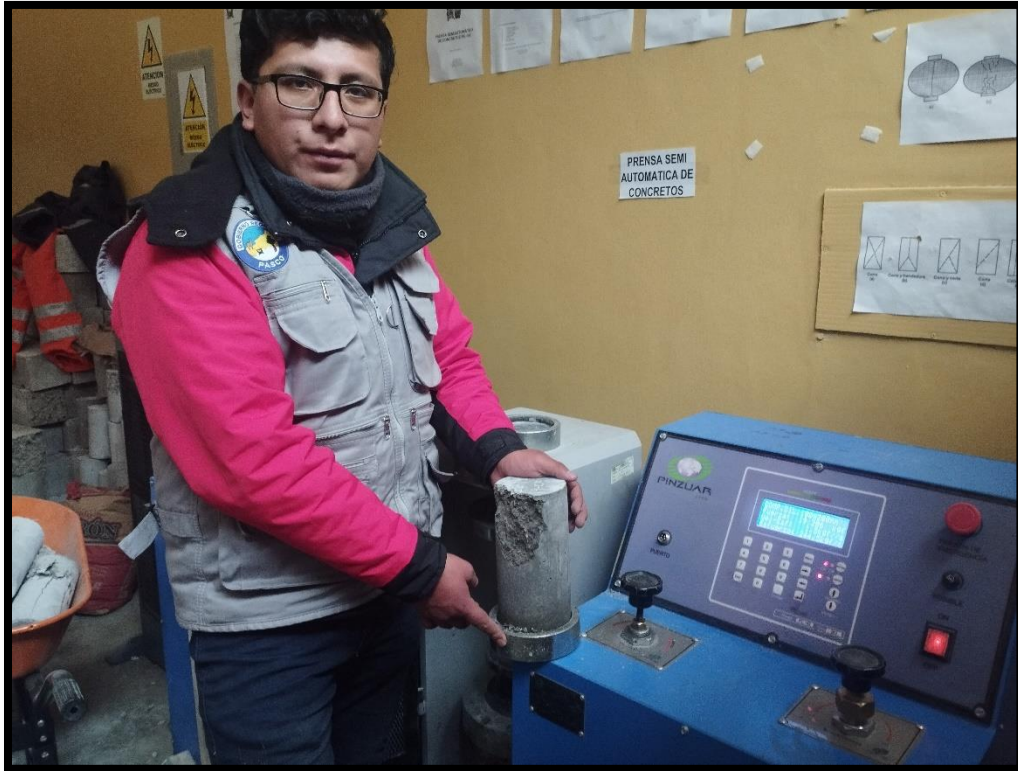
Fotografía 29.- Ensayando las probetas a los 14 días
