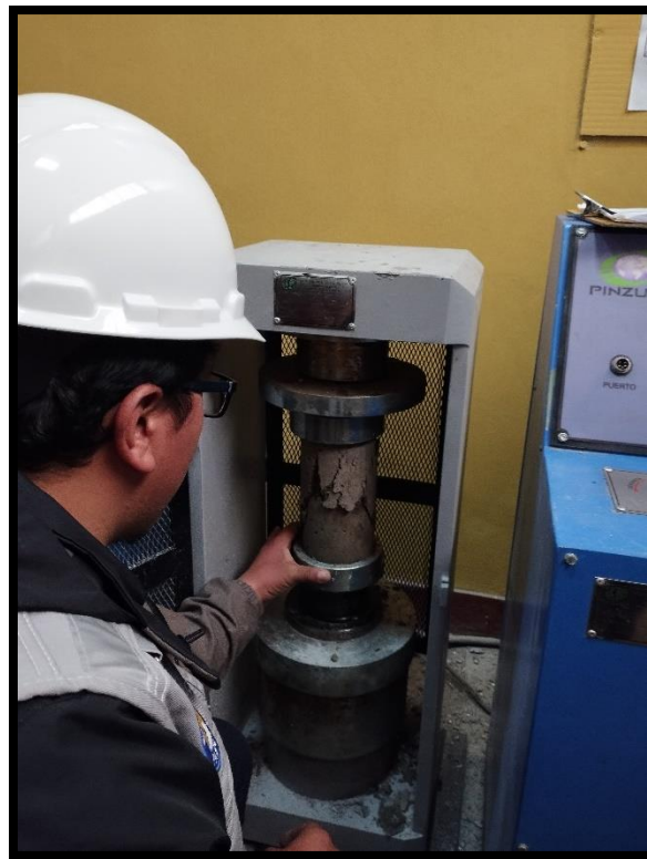
Fotografía 24.- Retirando la probeta tras la falla
