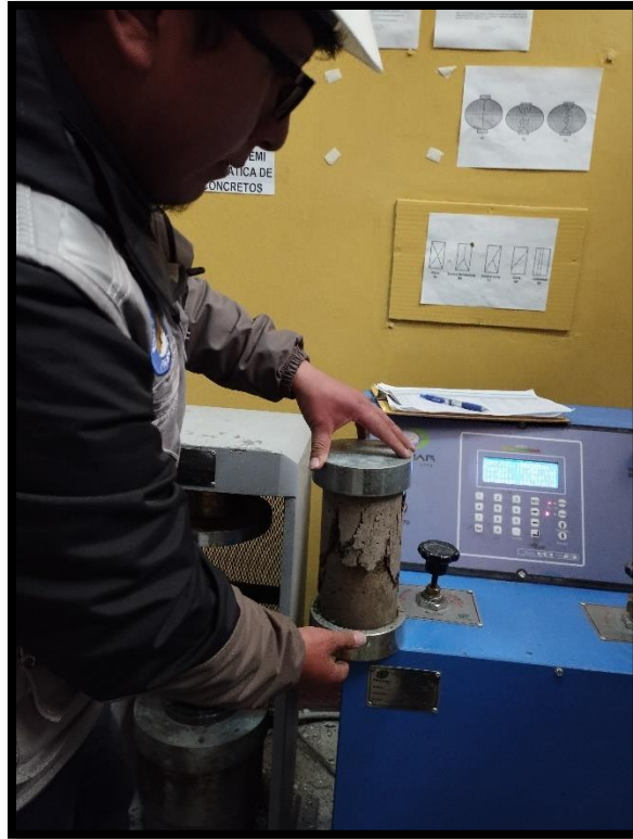
Fotografía 25.- Verificando el tipo de falla y la resistencia obtenida
