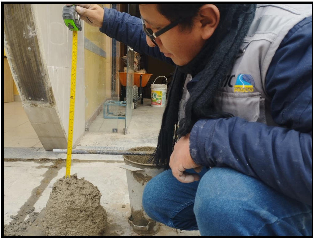
Fotografía 16.- Medida del slump del concreto con cemento puzolánico
