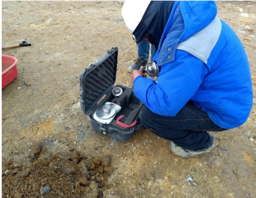
Figura 17. Prueba de humedad in situ con el Speedy
