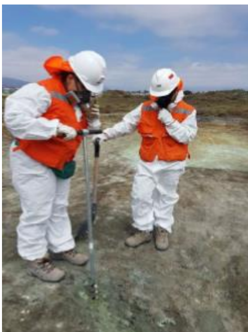
Figura 6. Sondaje manual en el depósito de relaves
