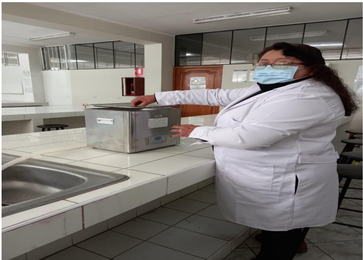
Foto 6. Equipo ultrasonido para lavado de muestras de lana.
