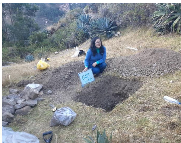
Foto 08. Estudio de suelos. Calicata N°2, ubicada en la Quebrada Chaquipa.
