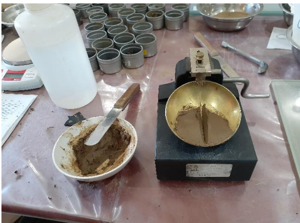
Foto 17. Determinación del límite líquido del suelo empleando la copa de Casagrande.
