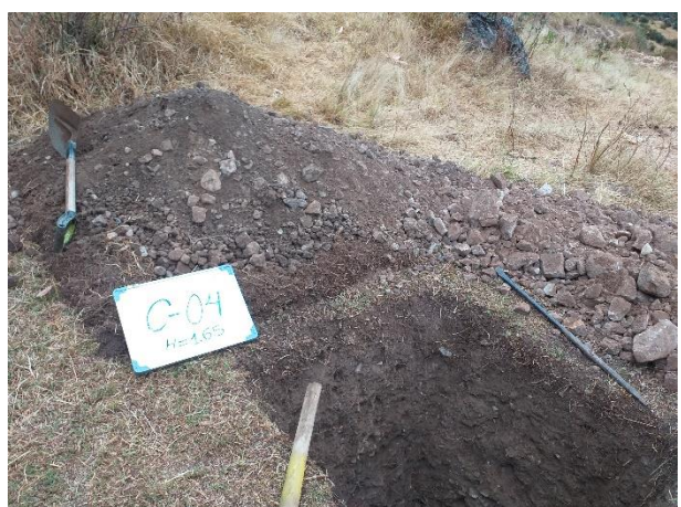
Foto 11. Estudio de suelos. Calicata N°4, ubicada en la Quebrada Maranchacra.
