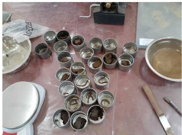
Foto 18. Determinación del límite plástico por el método de rollos.
