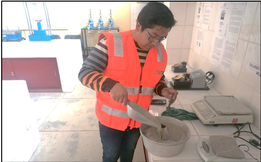
Fotografía 9 : Ensayo para determinar el Peso Específico del Agregado Fino
