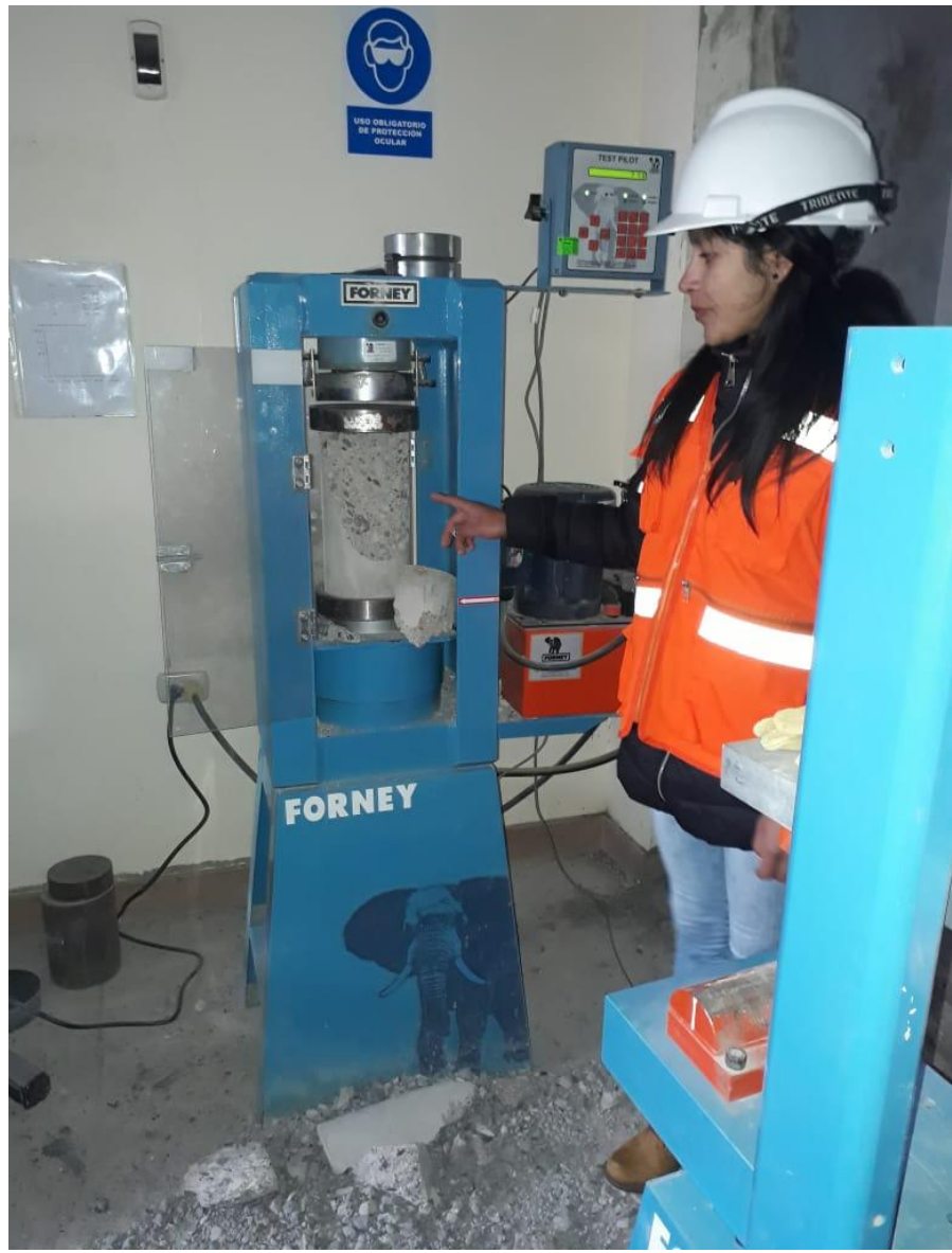
Figura 16. Ensayo a la compresión simple.
