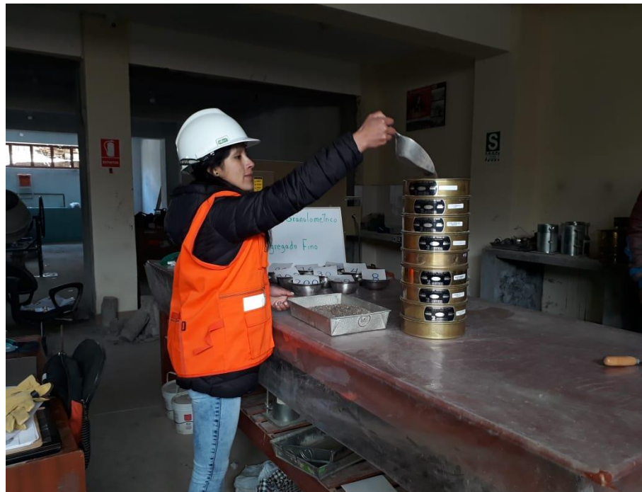
Figura 4. Ensayo de granulometría del agregado fino
