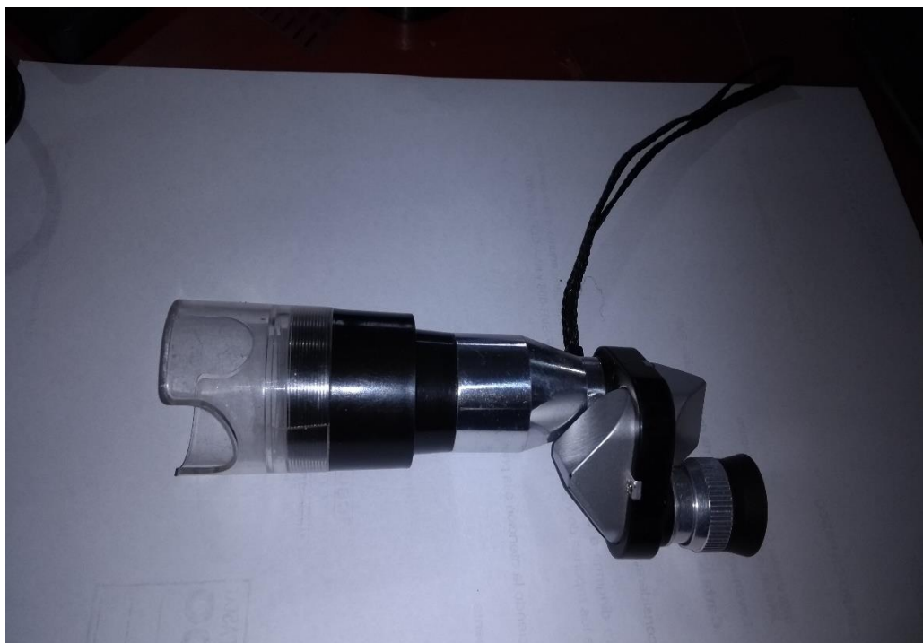
Figura 19. Microscopio para visualizar grietas.
