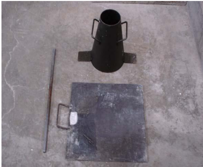
Figura 14. Equipo para determinar el asentamiento del concreto
