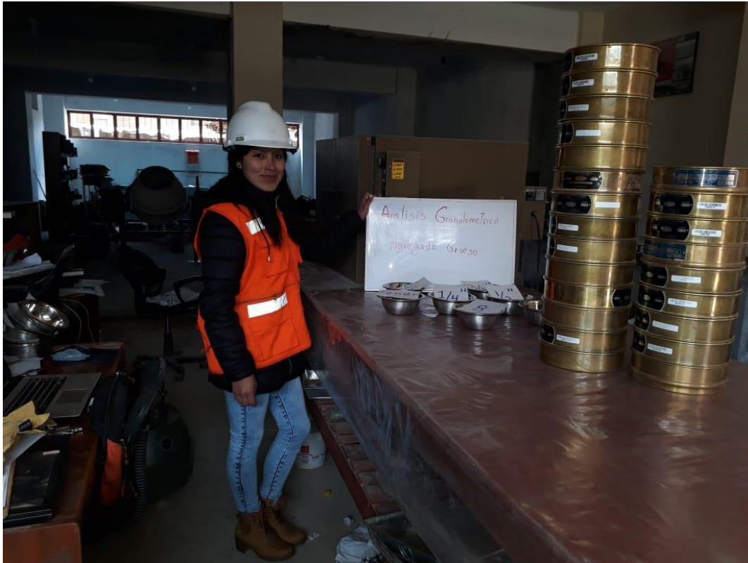
Figura 3. Ensayo de granulometría del agregado grueso.
