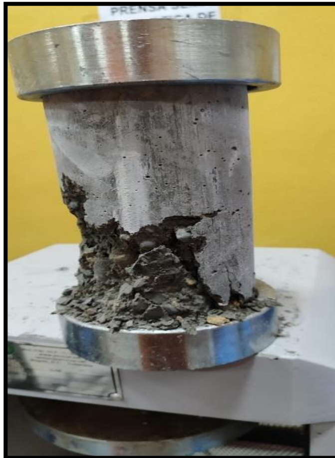
Imagen N° 32: Muestra fisurada a compresión tipo corte (d).
