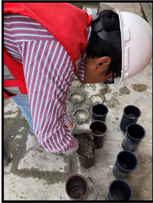
Imagen N° 15: Vaciado del concreto en las probetas cilíndricas previamente aceitadas.
