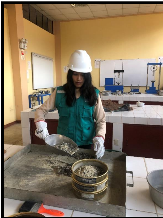
Imagen N° 02: Tamizaje del vidrio molido.
