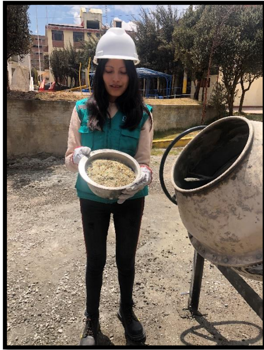
Imagen N° 13: Vaciado del vidrio molido en trompo mezclador.
