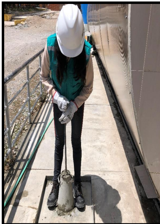
Imagen N° 24: Compactación del concreto en el cono de Abrams, con varilla lisa de acero.
