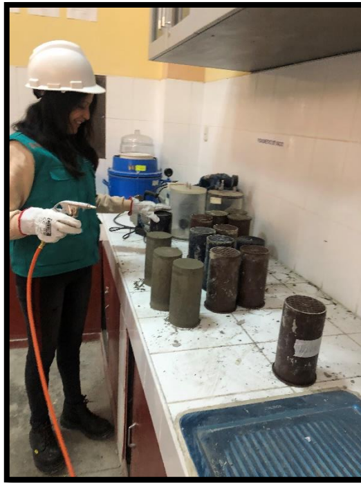
Imagen N° 27: Desmoldado de las probetas de concreto.
