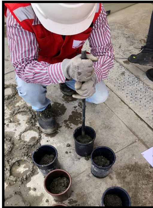
Imagen N° 16: Compactación del concreto con la varilla lisa de acero.
