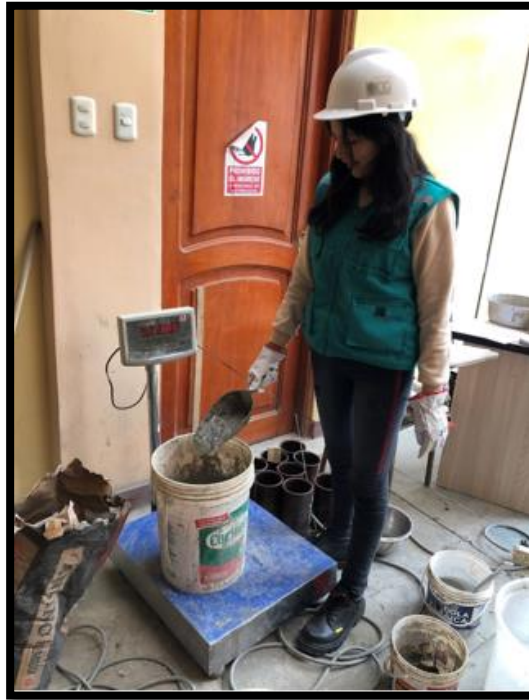
Imagen N° 07: Peso de la dosificación del agregado grueso para la mezcla del concreto.
