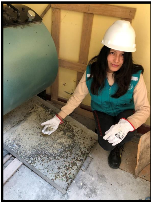
Imagen N° 01: Molienda del vidrio en la máquina de los Ángeles.
