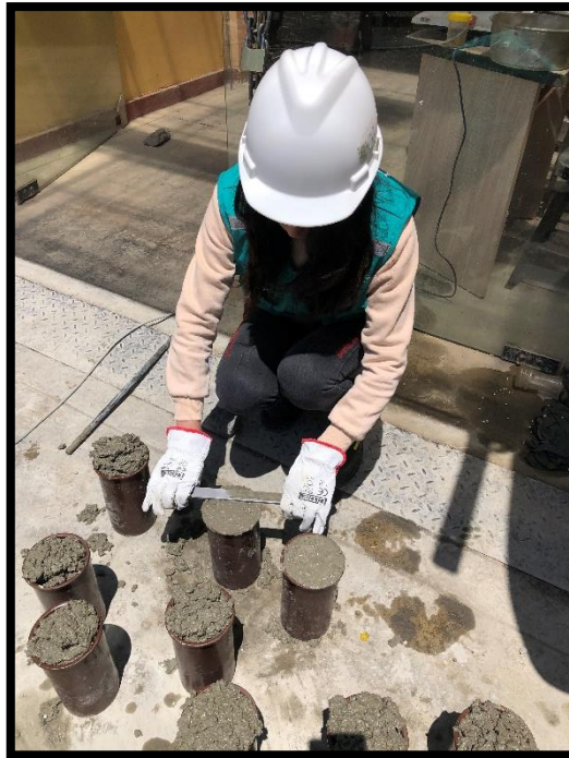
Imagen N° 23: Nivelación con plancha de acero para obtener superficie lisa y plana.
