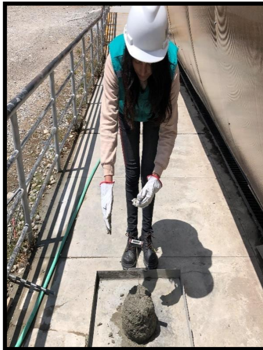
Imagen N° 26: Medición de la temperatura del concreto en la prueba de revenimiento.
