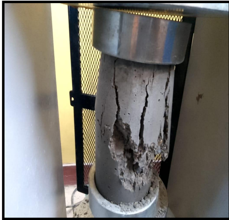
Imagen N° 33: Muestra fisurada a compresión tipo corte (b).
