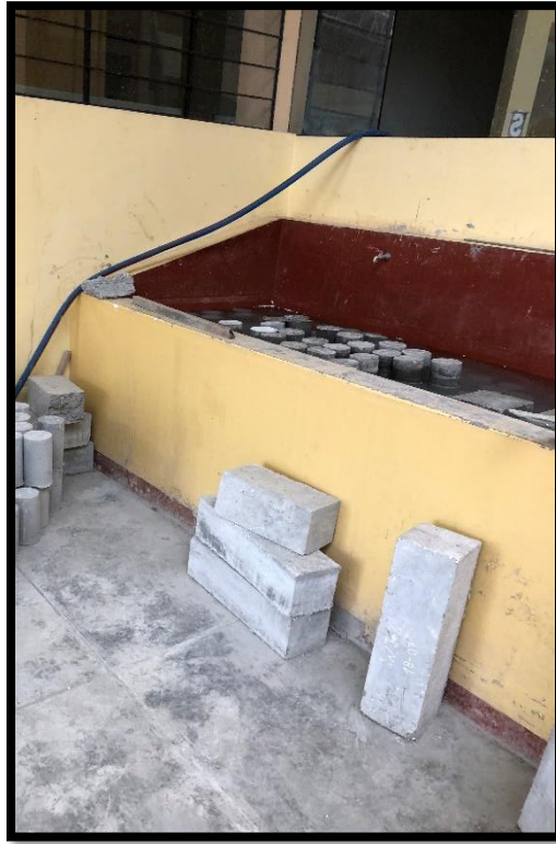
Imagen N° 29: Curado de los moldes de concreto.
