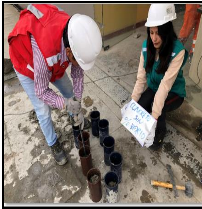
Imagen N° 17: Vaciado de concreto sin % de vidrio molido.
