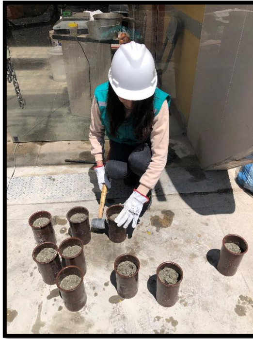
Imagen N° 21: Golpes con el martillo de goma para liberar burbujas de aire en las probetas.
