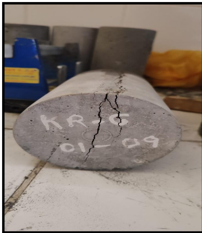
Imagen N° 34: Muestra fisurada a tracción tipo corte (a).
