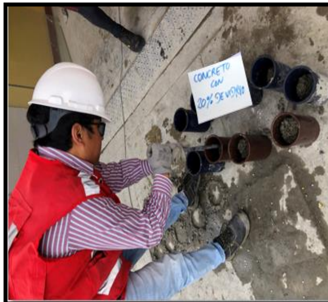
Imagen N° 20: Vaciado de concreto con 20% de vidrio molido.
