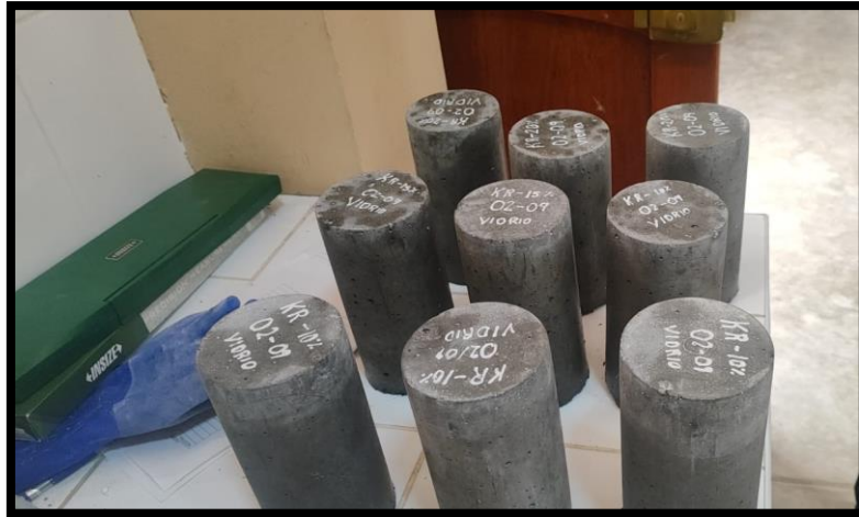
Imagen N° 31: Muestras para los ensayos a compresión y tracción del concreto.
