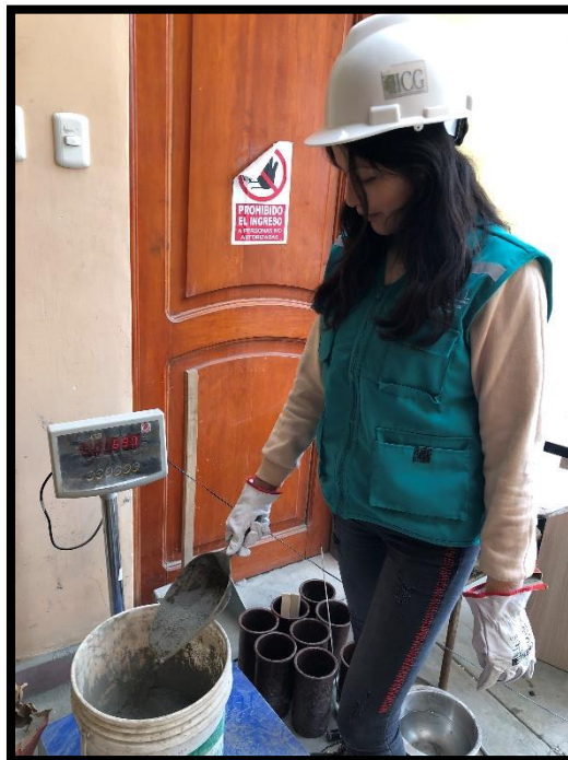
Imagen N° 04: Peso de la dosificación del cemento para la mezcla de concreto.
