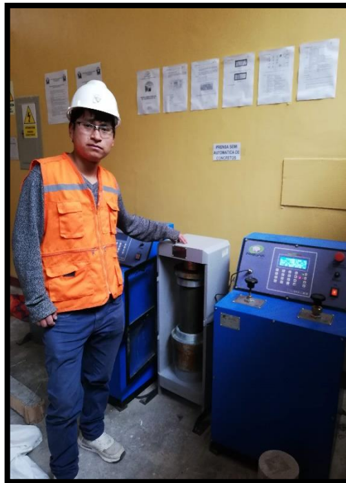
Imagen N° 30: Empezando con los ensayos a compresión y tracción del concreto.
