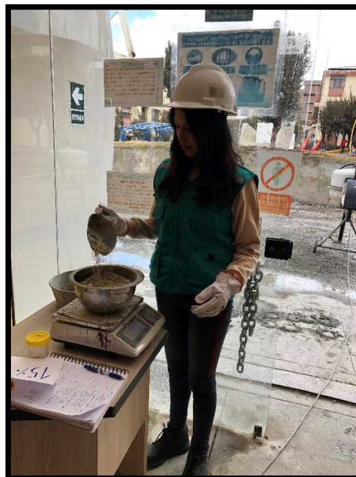
Imagen N° 08: Peso de la dosificación del vidrio molido para la mezcla del concreto.
