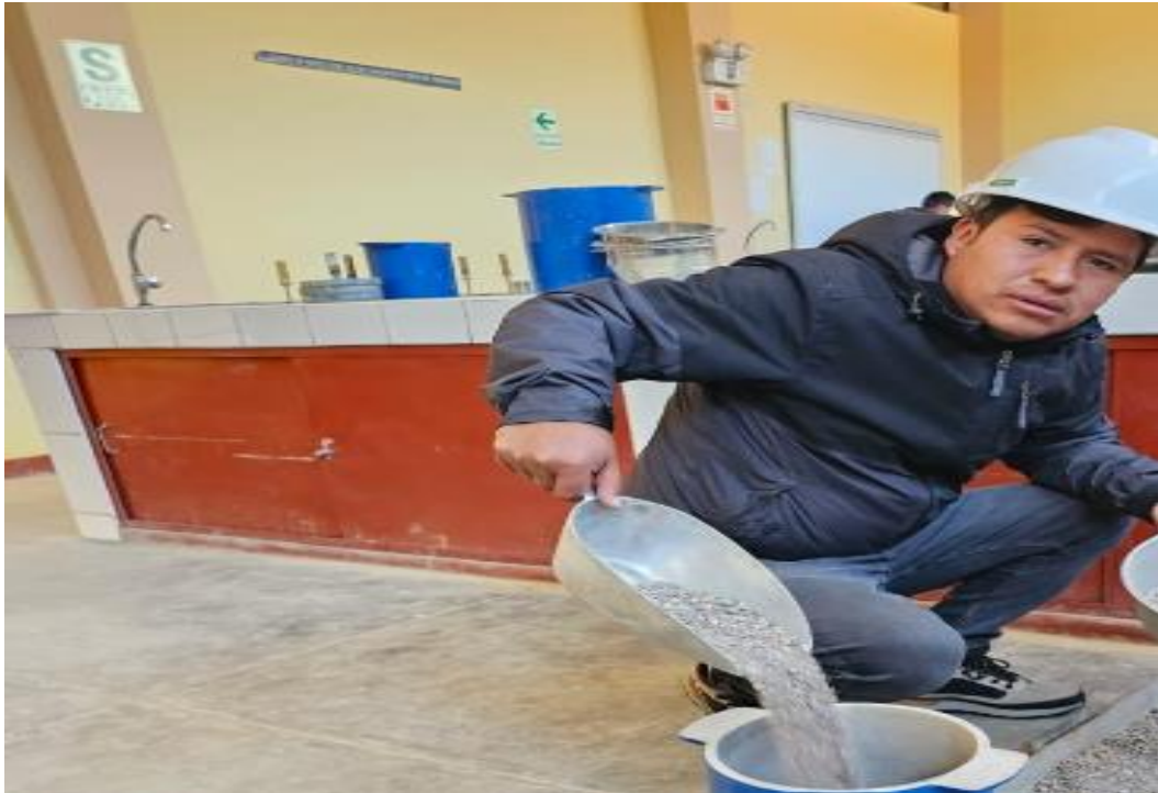
Fotografía 03. Proceso de determinación de peso unitario suelto y compactado de los agregados.
