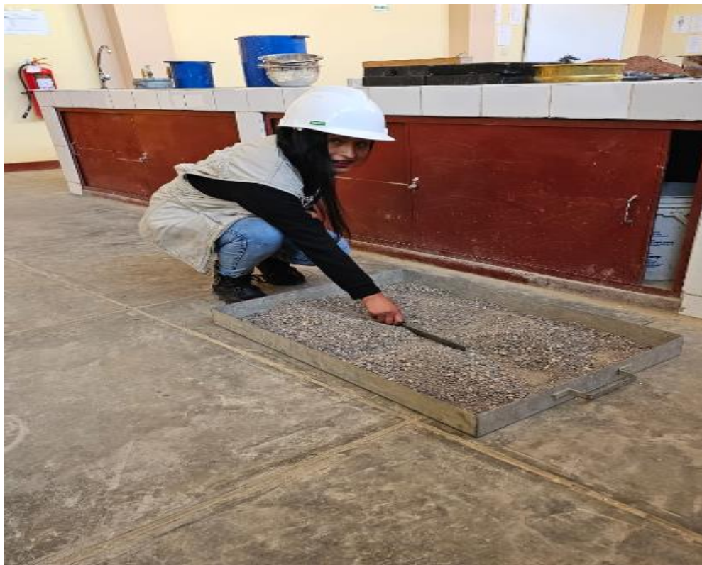
Fotografía 02. Proceso de cuarteo de los agregados para determinar las propiedades físicas de los agregados
