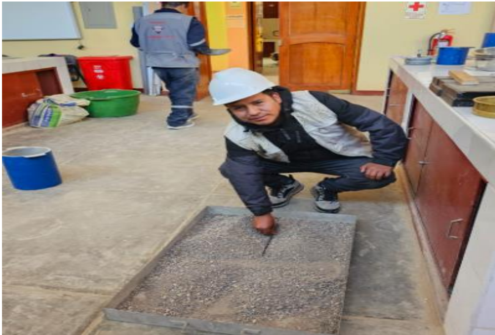
Fotografía 01. Proceso de cuarteo de los agregados para determinar las propiedades físicas de los agregados
