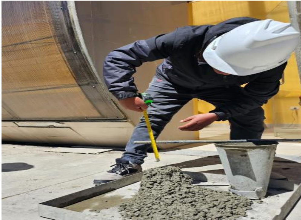
Fotografía 21. Método de prueba con el cono de Abrams para determinar la consistencia del concreto.
