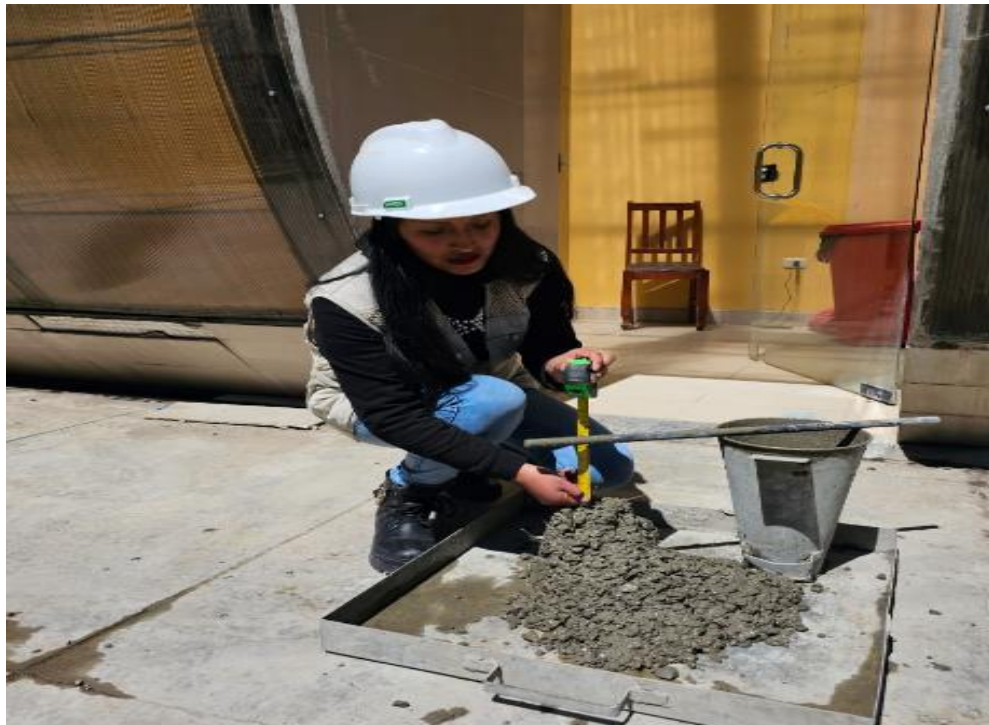
Fotografía 20. Método de prueba con el cono de Abrams para determinar la consistencia del concreto.
