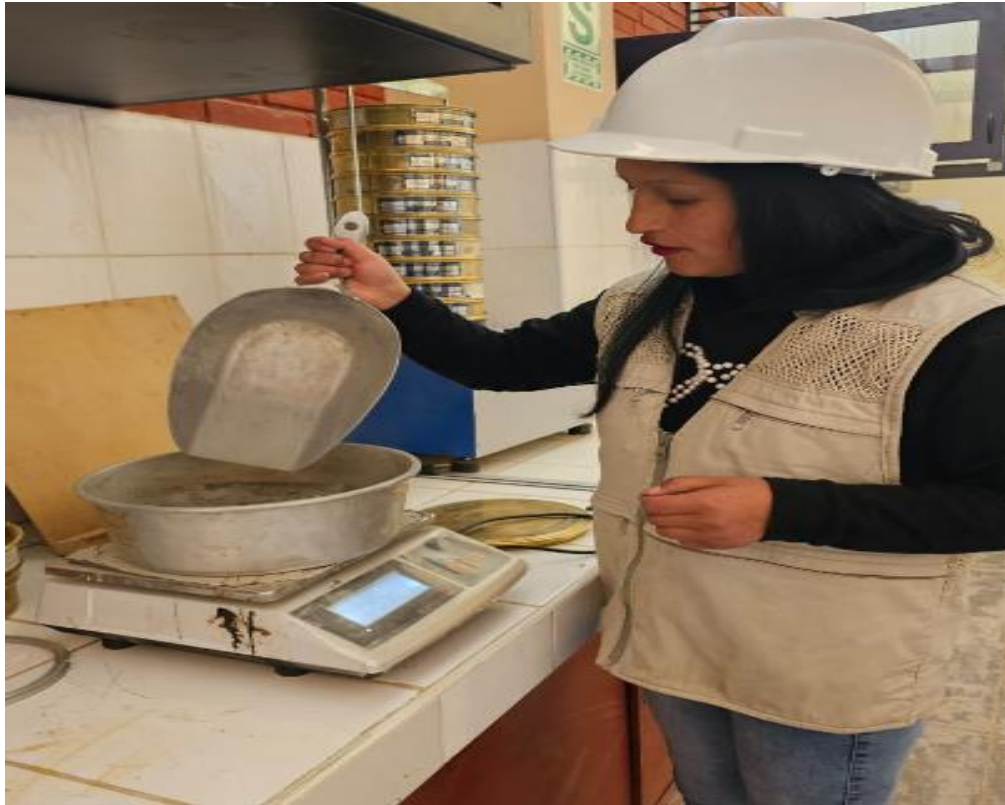
Fotografía 07. Proceso de determinación de las propiedades físicas del relave minero
