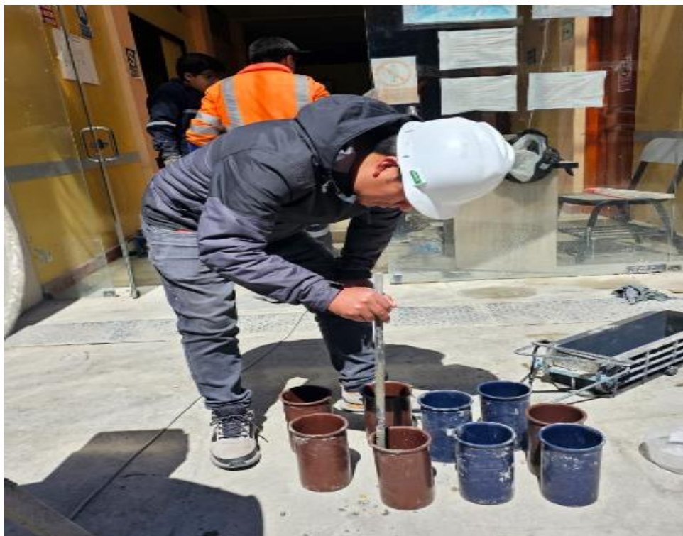
Fotografía 22. proceso de la realización de las probetas de concreto, varillado de 25 golpes por cada capa en un total de 3 capas por molde.
