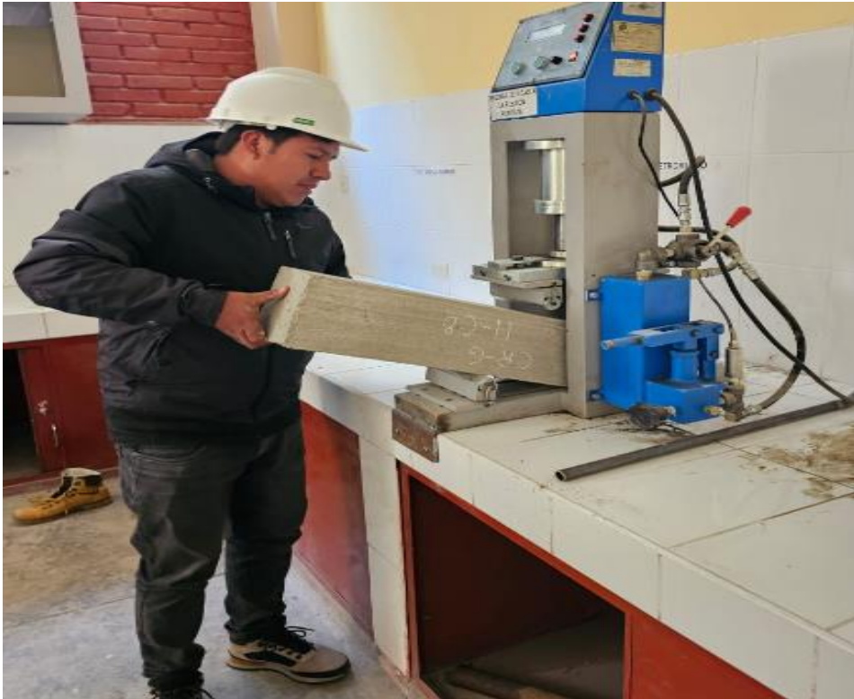
Fotografía 33. Proceso del ensayo de las vigas para determinar la tenacidad máxima a la flexión.
