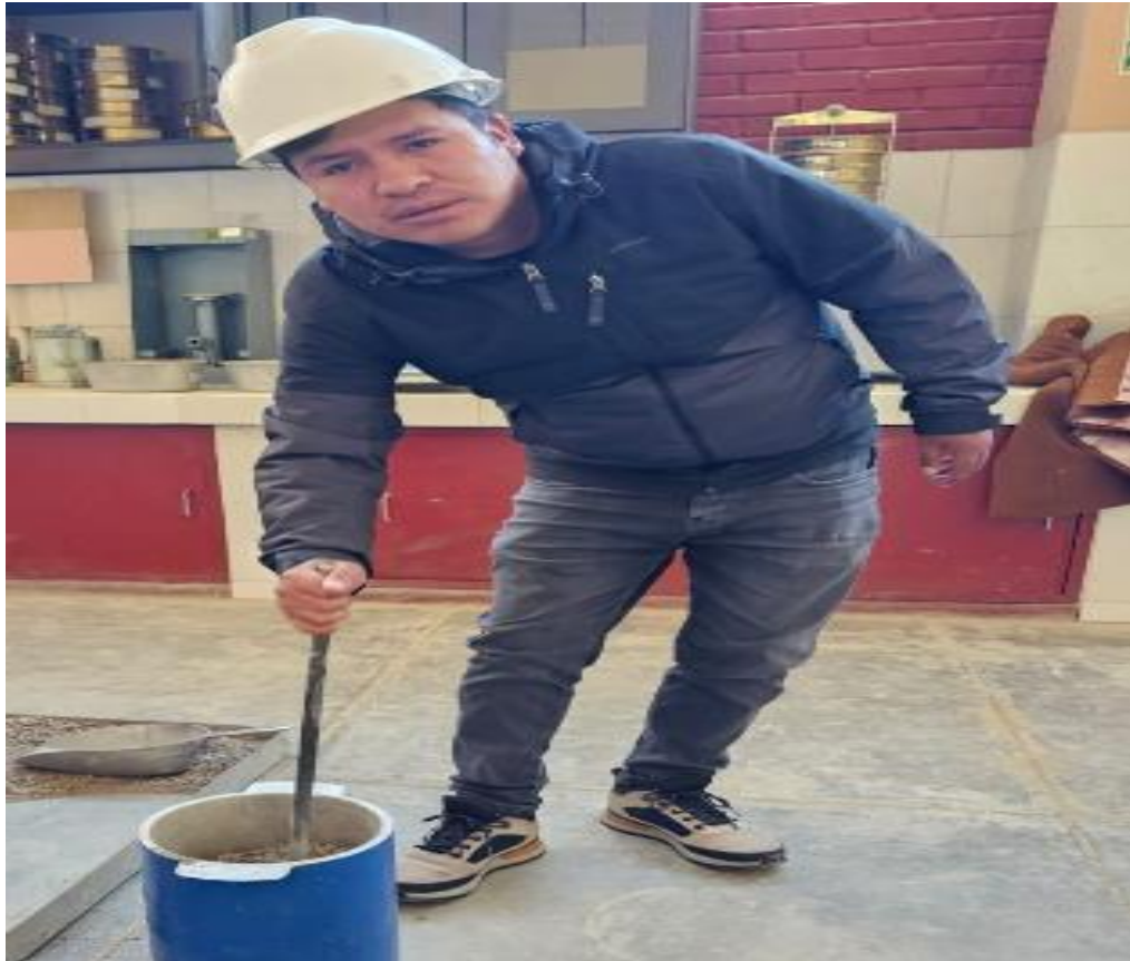
Fotografía 05. Proceso de determinación de peso unitario suelto y compactado de los agregados.
