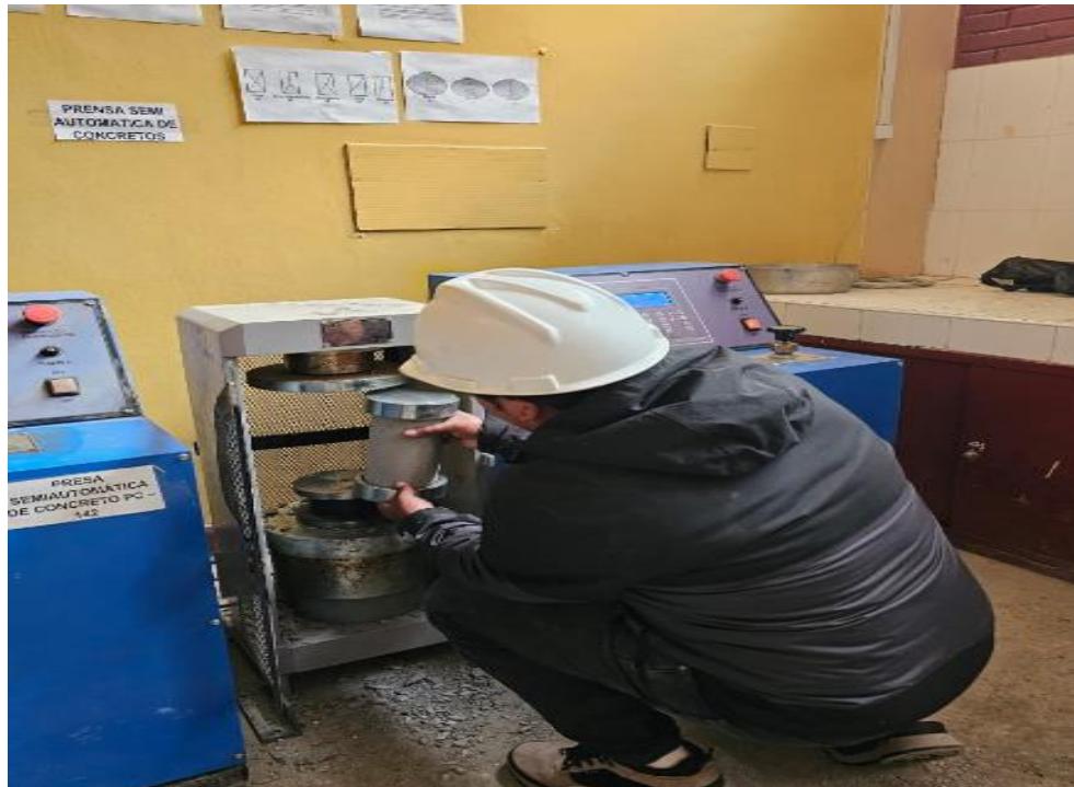
Fotografía 29. Proceso del ensayado de los testigos para determinar la resistencia a la compresión.
