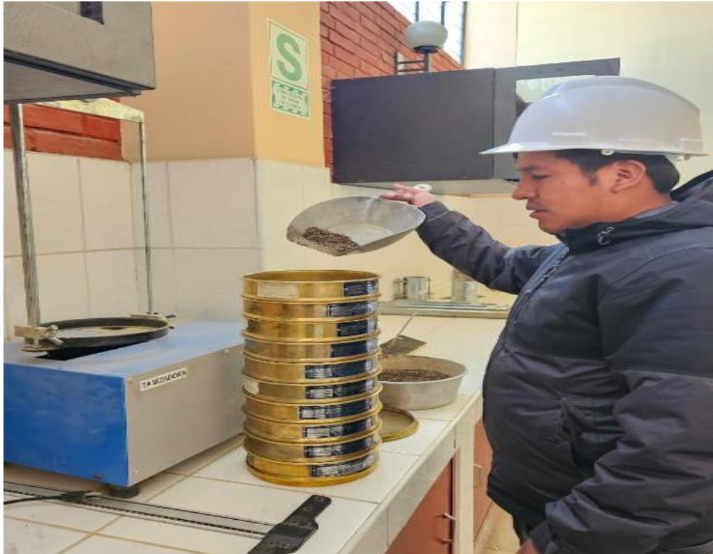
Fotografía 09. Proceso del análisis granulométrico de los agregados y del relave minero
