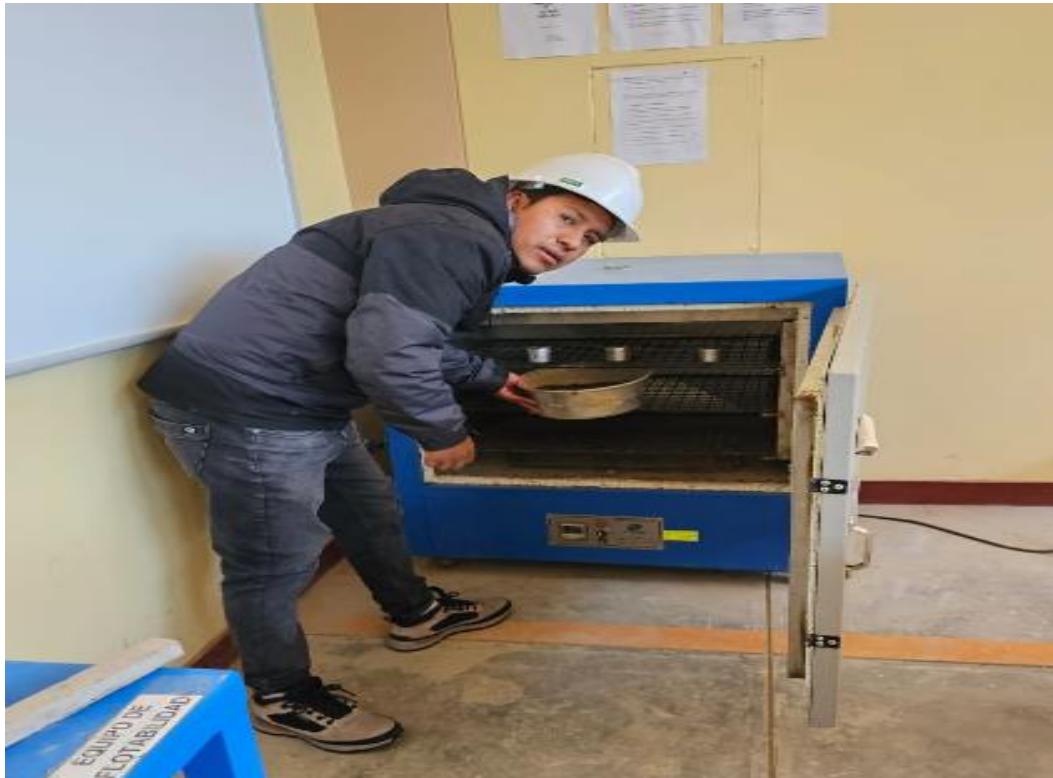
Fotografía 12. Proceso de la determinación del contenido de humedad de los agregados
