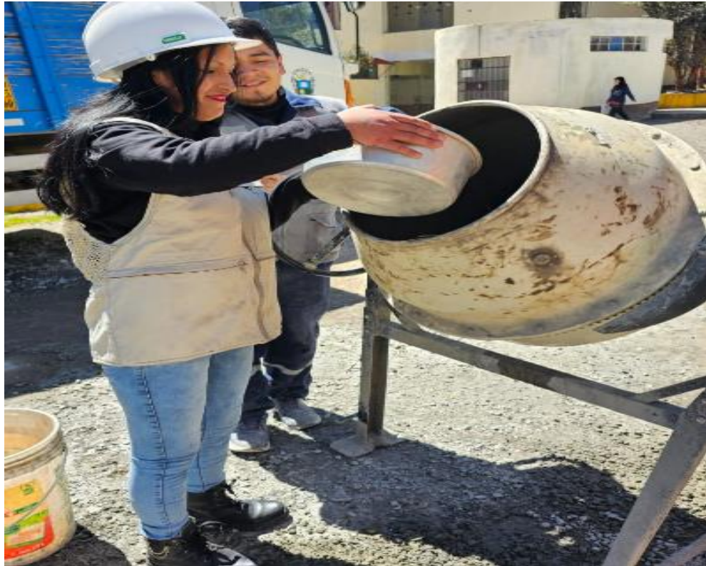
Fotografía 13. Dosificación de los materiales a utilizarse para el diseño de mezcla
