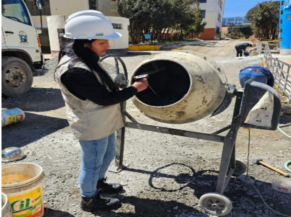
Fotografía 19. Determinación de la temperatura del concreto fresco, de la muestra diseño y muestras con diseños factoriales.
