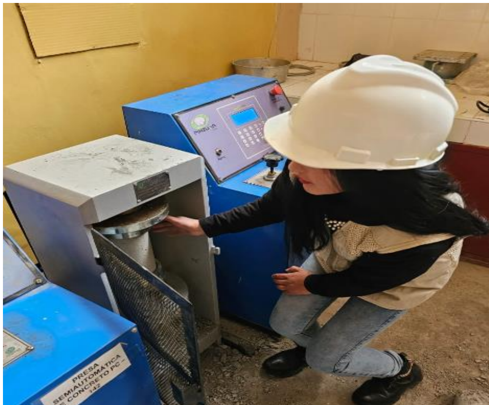
Fotografía 28. Proceso del ensayo de los testigos para determinar la resistencia a la compresión.
