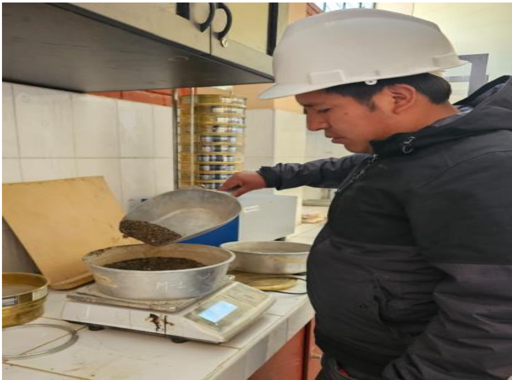
Fotografía 08. Dosificación de los agregados para el diseño de mezcla
