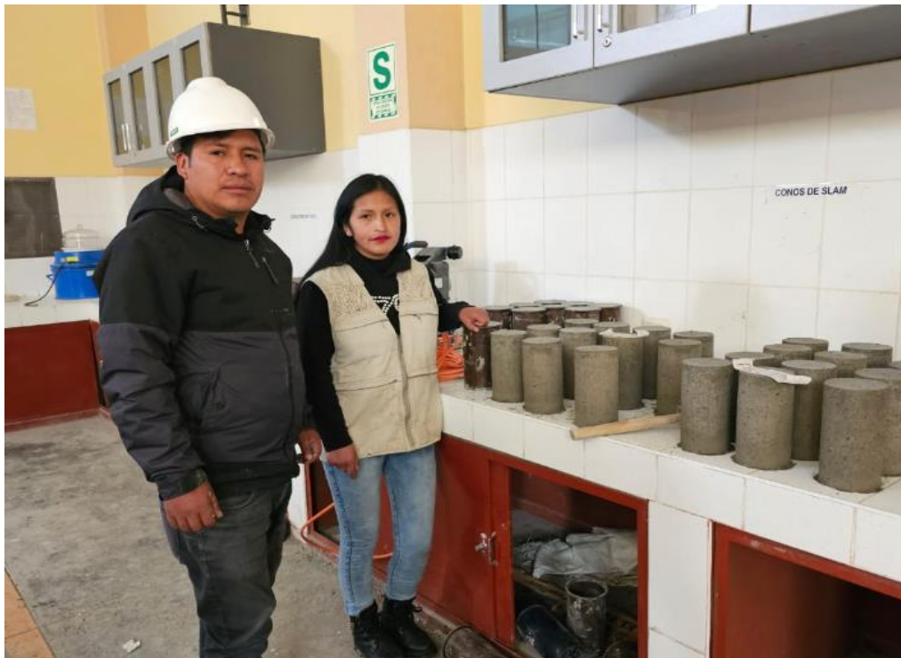
Fotografía 24. Probetas después de ser retiradas del pozo de curación para posterior ser ensayadas.
