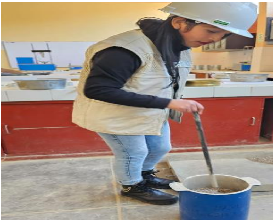
Fotografía 04. Proceso de determinación de peso unitario suelto y compactado de los agregados.
