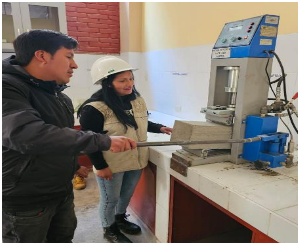
Fotografía 34. Proceso del ensayo de las vigas para determinar la tenacidad máxima a la flexión.
