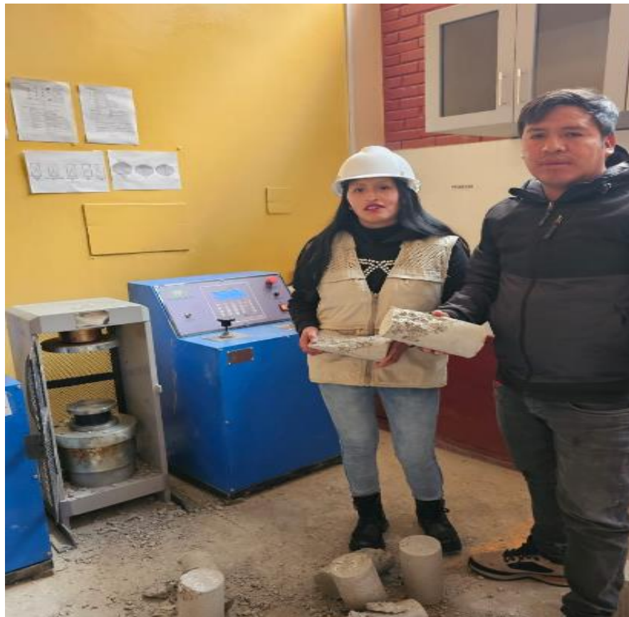
Fotografía 32. Verificación del tipo de falla de las probetas ensayadas.
