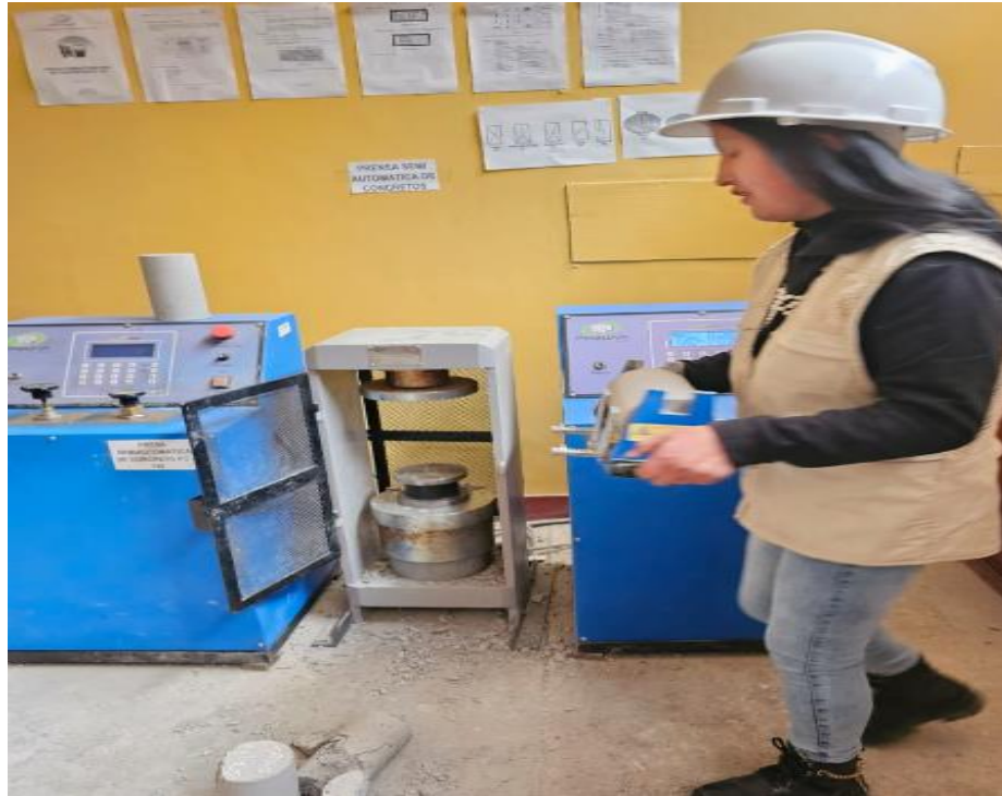
Fotografía 31. Proceso del ensayo de los testigos para determinar la resistencia a la tracción indirecta.
