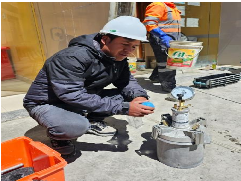
Fotografía 18. Proceso de la incorporación del contenido de aire al concreto
