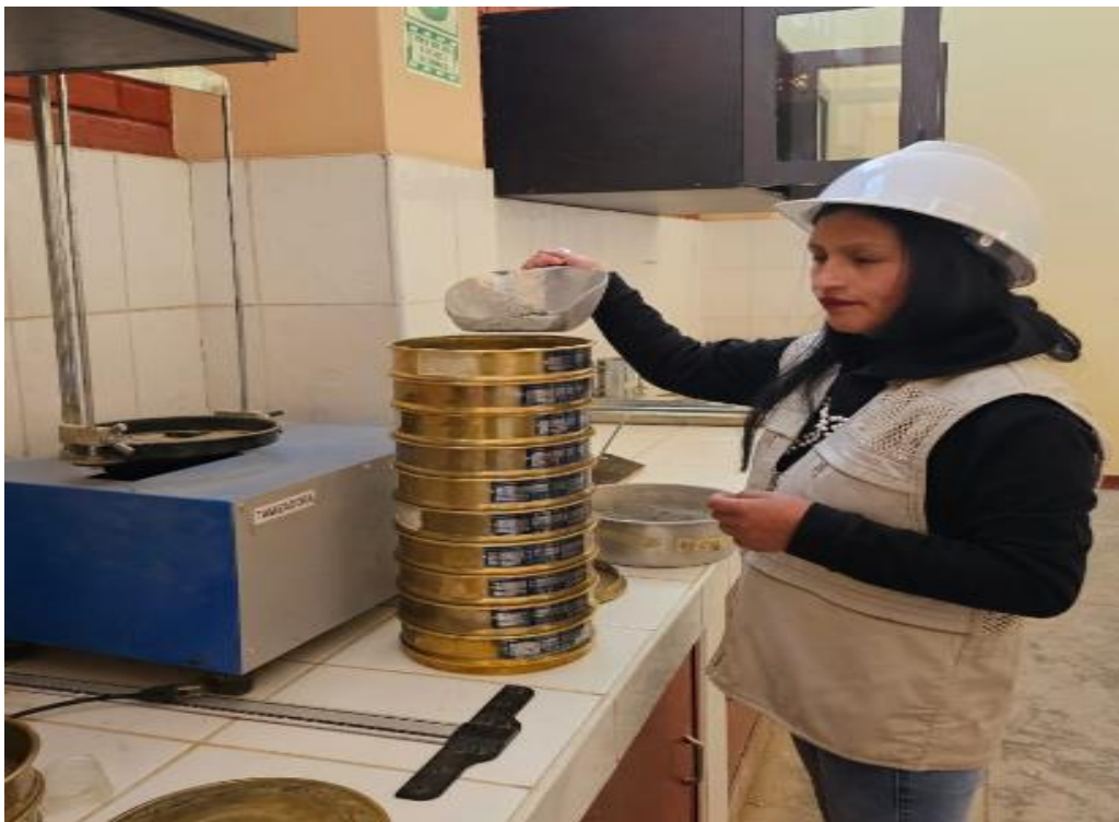
Fotografía 10. Proceso del análisis granulométrico de los agregados y del relave minero
