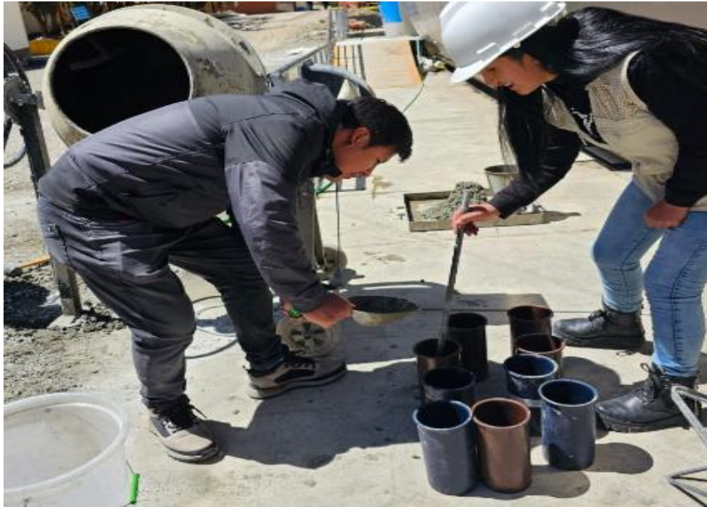
Fotografía 23. proceso de la realización de las probetas de concreto, varillado de 25 golpes por cada capa en un total de 3 capas por molde.
