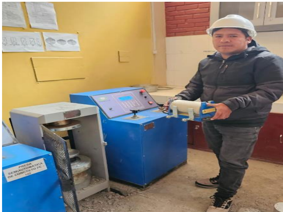
Fotografía 30. Proceso del ensayado de los testigos para determinar la resistencia a la tracción indirecta.
