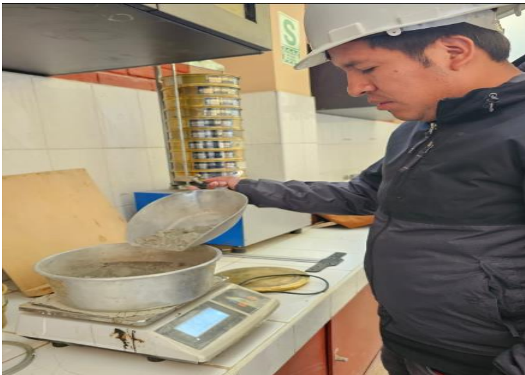
Fotografía 06. Proceso de determinación de las propiedades físicas del relave minero
