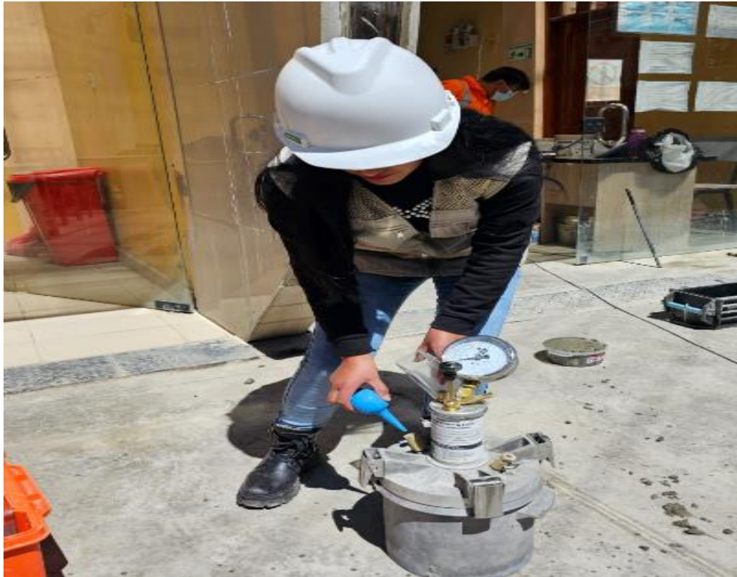
Fotografía 17. Proceso de la incorporación del contenido de aire al concreto
