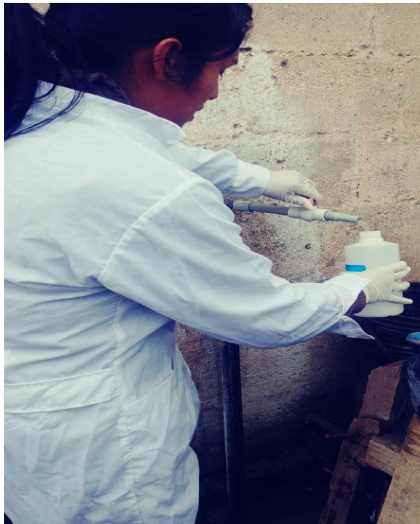
IMAGEN N° 08: Toma de Muestra en Pileta - Para Metales Totales
