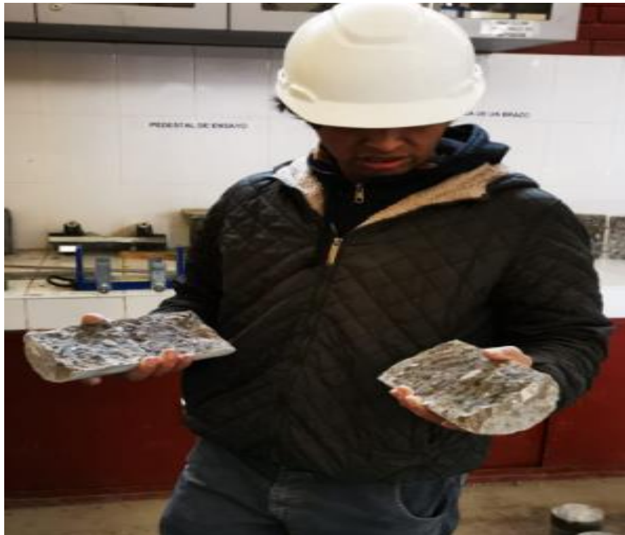
Fotografía 23. Ensayo a la tracción indirecta de las probetas de concreto
