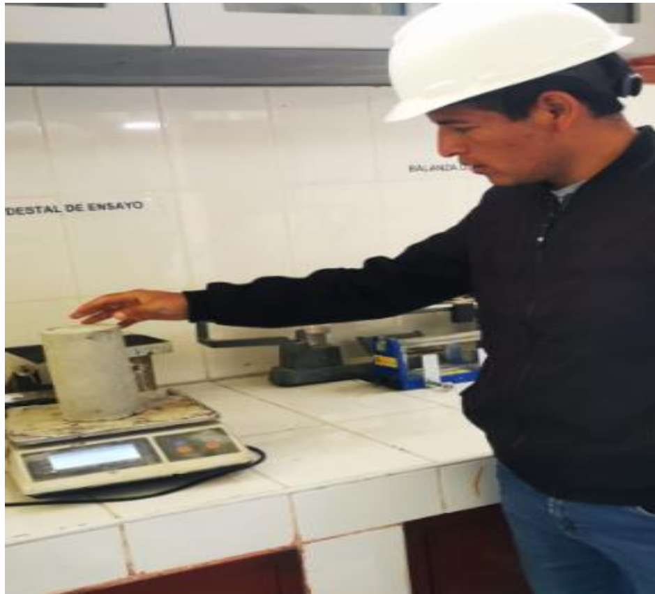
Fotografía 15. Proceso de toma de datos como medidas y peso de las probetas de concreto
