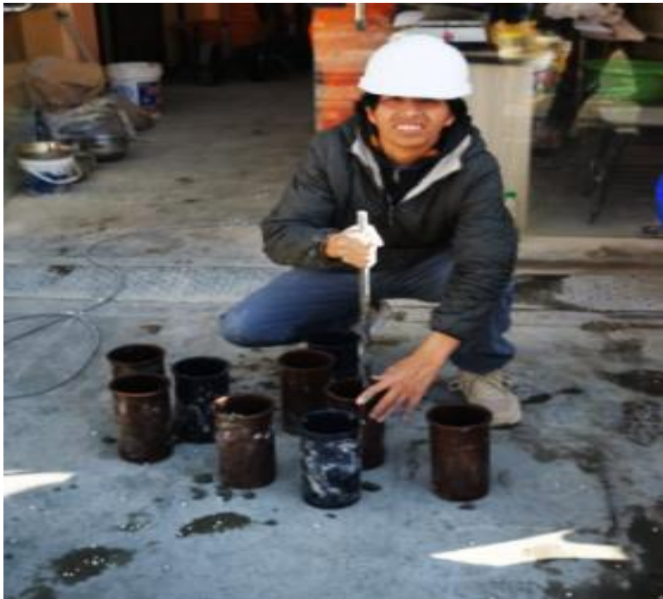
Fotografía 10. Proceso de elaboración de las probetas y vigas de concreto
