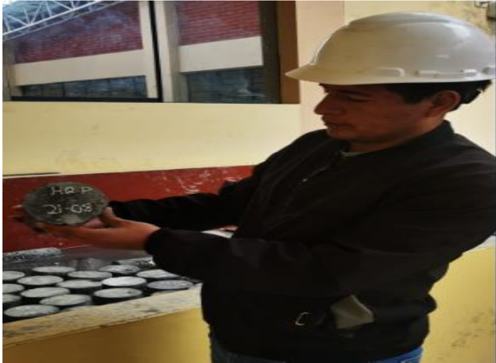
Fotografía 11. Proceso de curado de las probetas y vigas de concreto.
