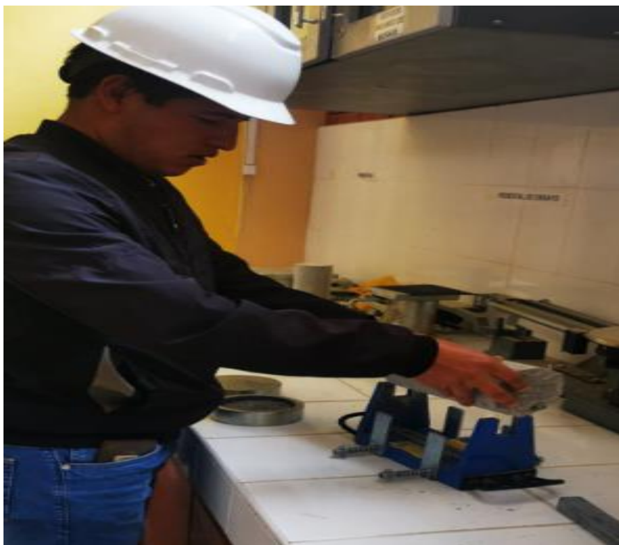
Fotografía 24. Ensayo a la tracción indirecta de las probetas de concreto
