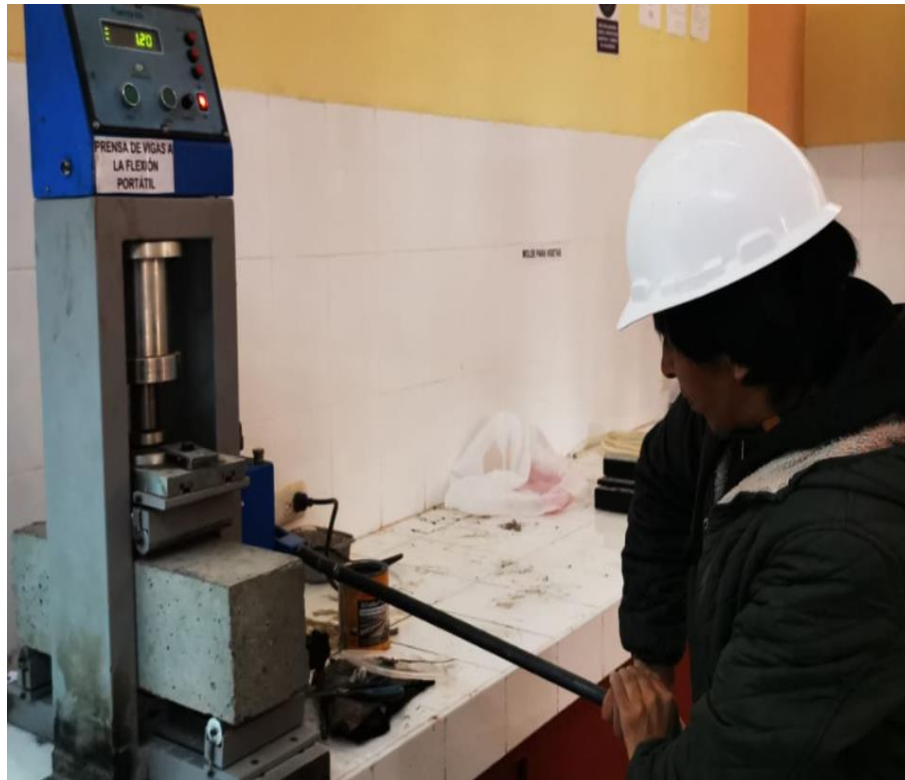
Fotografía 27. Ensayo a la flexión de las vigas de concreto
