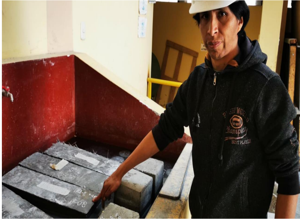
Fotografía 13. Proceso de curado de las probetas y vigas de concreto.
