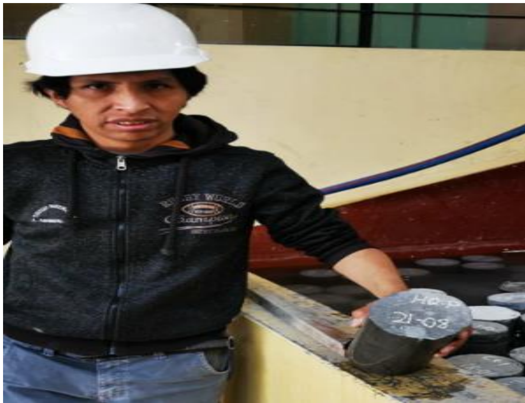
Fotografía 12. Proceso de curado de las probetas y vigas de concreto.
