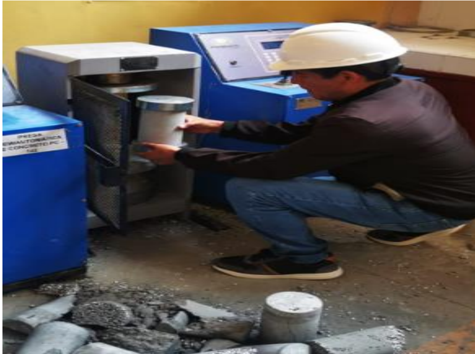
Fotografía 17. Ensayo a la compresión de las probetas de concreto
