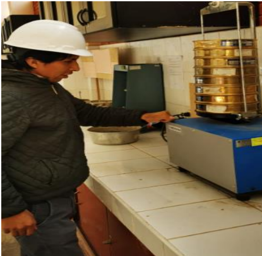
Fotografía 04. Proceso de ensayo de la granulometría de los agregados
