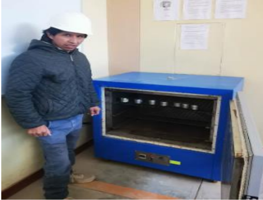
Fotografía 03. Proceso de obtención del contenido de humedad de los agregados
