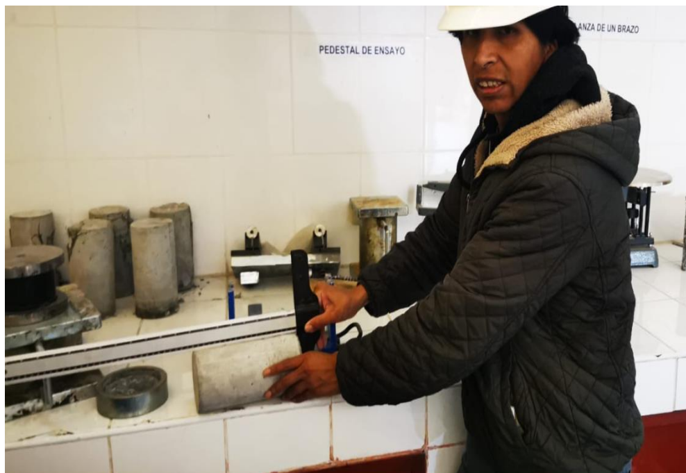
Fotografía 16. Proceso de toma de datos como medidas y peso de las probetas de concreto
