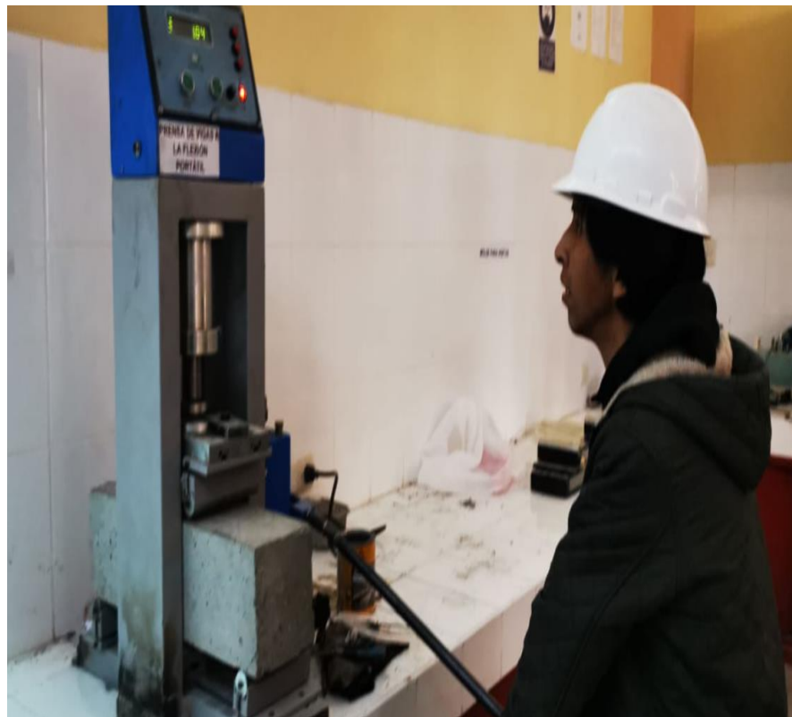
Fotografía 26. Ensayo a la flexión de las vigas de concreto
