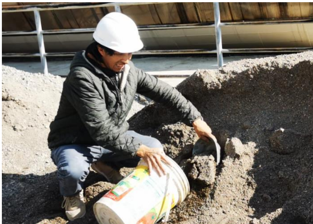
Fotografía 06. Proceso de dosificación de los agregados para el diseño de mezcla
