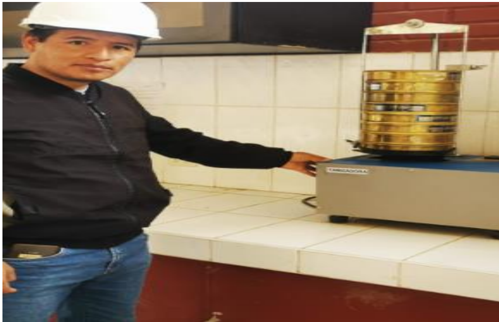
Fotografía 05. Proceso de ensayo de la granulometría de los agregados
