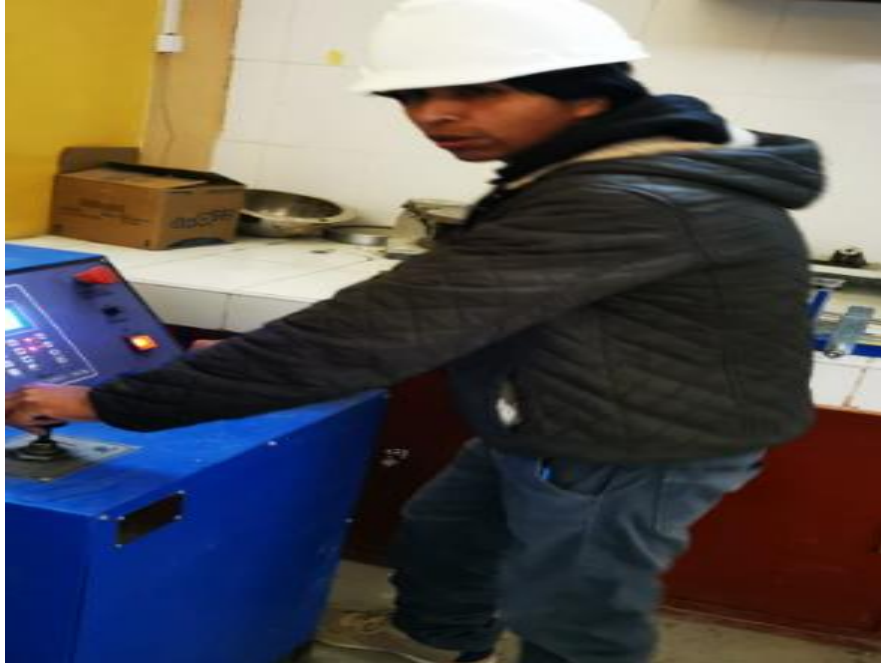
Fotografía 19. Ensayo a la compresión de las probetas de concreto
