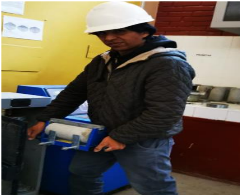
Fotografía 21. Ensayo a la tracción indirecta de las probetas de concreto
