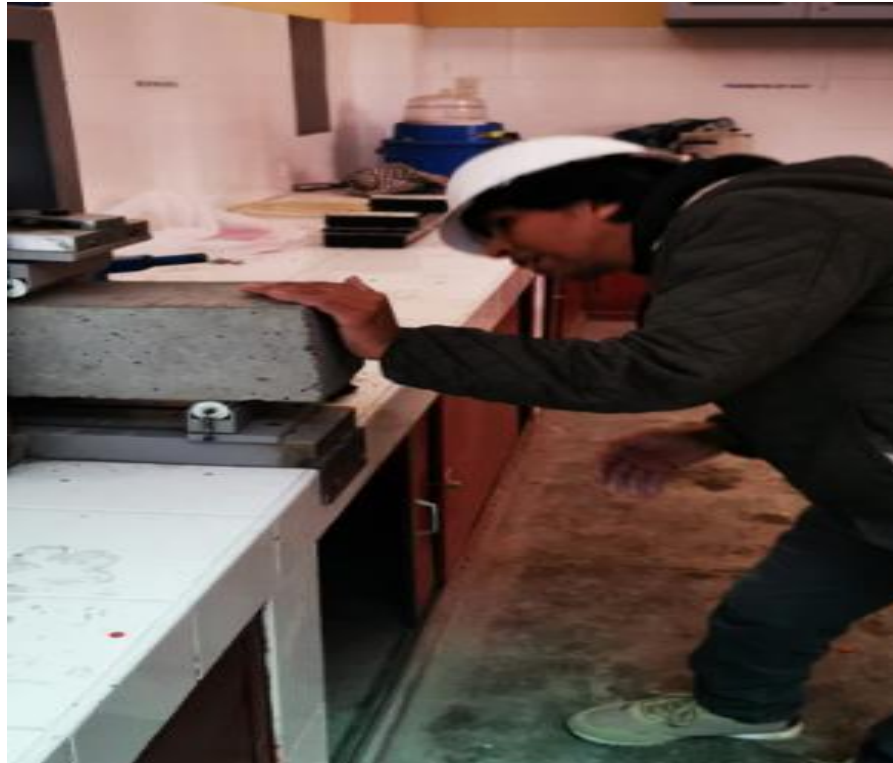
Fotografía 28. Ensayo a la flexión de las vigas de concreto
