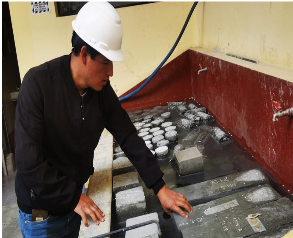
Fotografía 14. Proceso de curado de las probetas y vigas de concreto.
