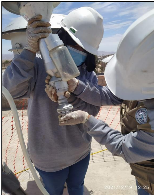
Imagen 6: Colocación de filtro para PM2.5
