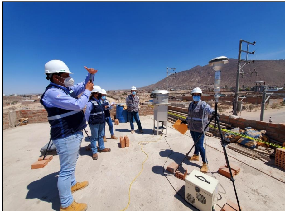
Imagen 4: Verificación de equipo de monitoreo de aire, que mide material particulado PM 2.5
