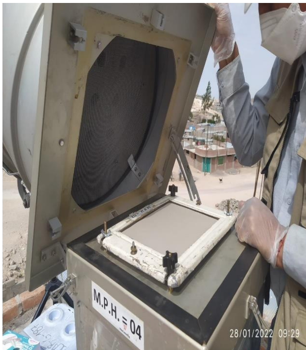
Imagen 9: Retiro del filtro de PM 10
